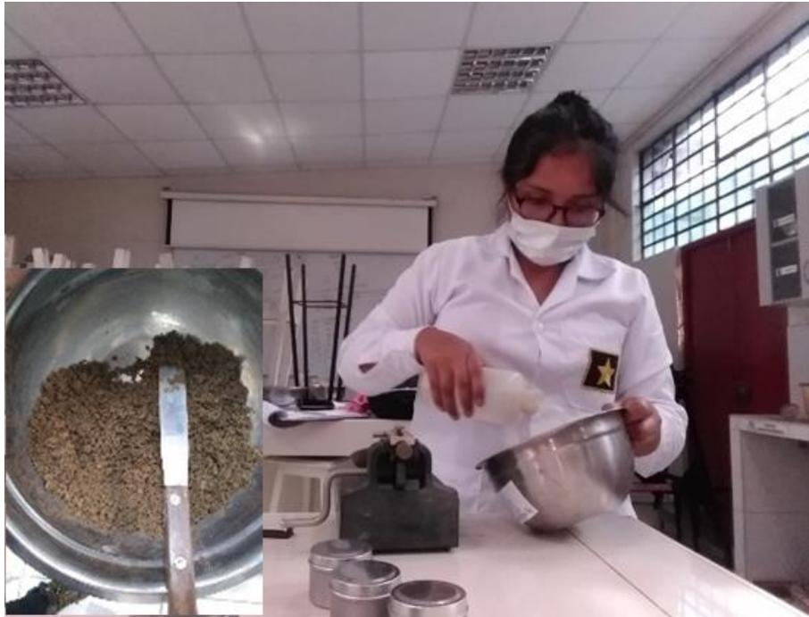
Figura 143, Se realiza el humedecimiento de la nueva muestra con agua destilada para realizar los mismos pasos del ensayo con suelo natural
