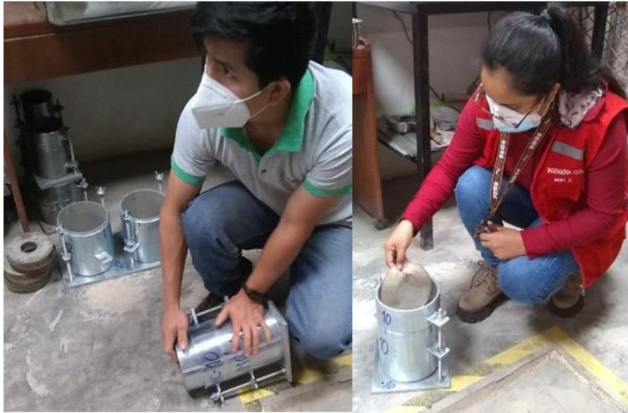
Figura 177, Se observa la colocación del disco espaciador y papel filtro en el molde CBR
