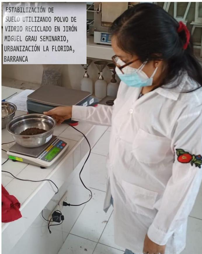
Figura 176, Se observa cuando se pesó la Porción mayor a 100 g de muestra antes de la compactación de CBR
