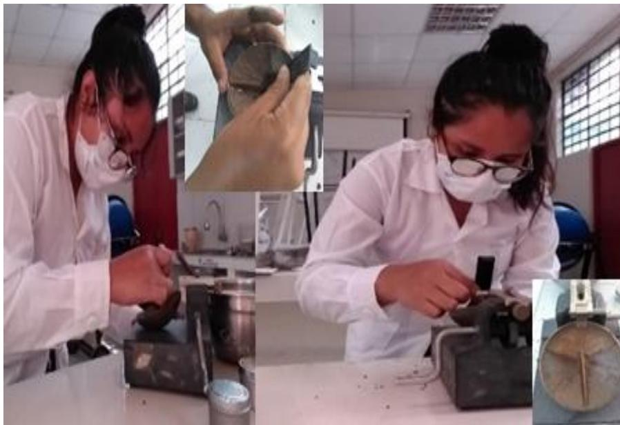
Figura 134, Se observa cuando se hizo uso del acanalador para formar la ranura
