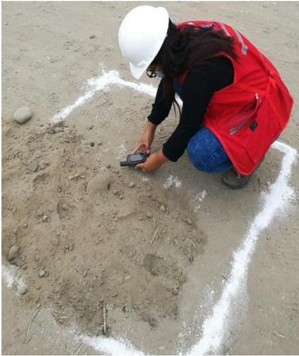
Figura 101, Se observa la posición del GPS para obtener las coordenadas UTM de la calicata C-2
