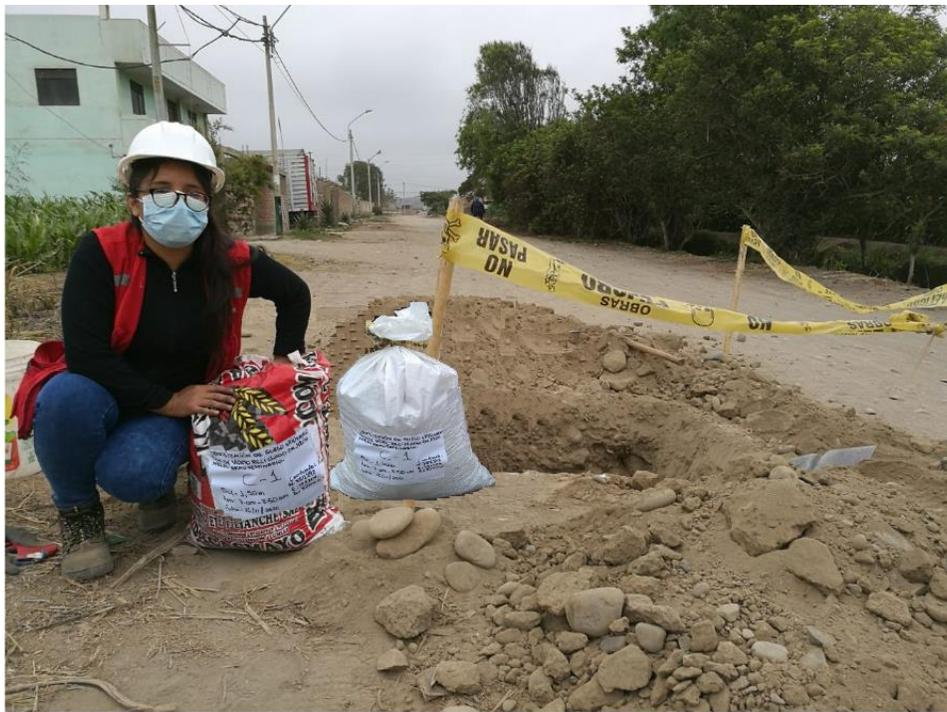
Figura 96, Se observa las muestras sacadas de la cota 0.20 m hasta 1.50 m de la calicata
