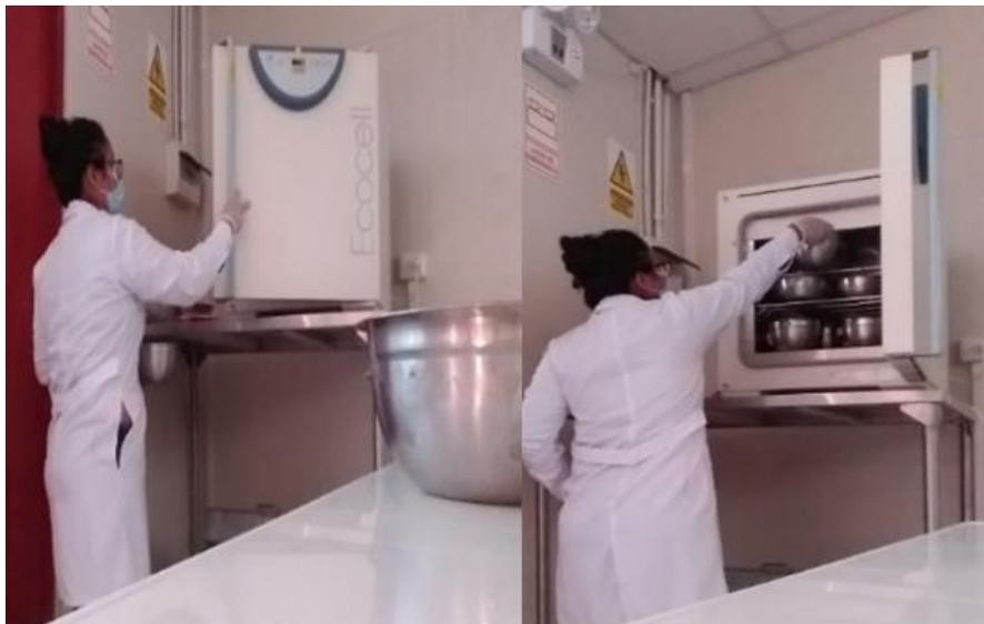
Figura 118, Se observa cuando se ingresa las muestras húmedas en el horno
