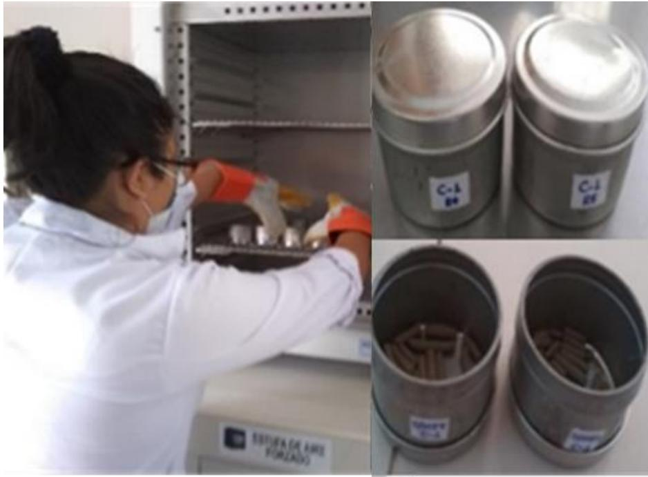
Figura 149, Se observa cuando se saca las muestras del horno del ensayo límite plástico
