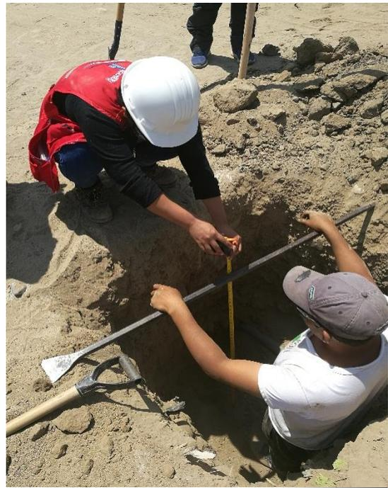
Figura 100, Se realiza la verificación de la altura de la calicata C-2
