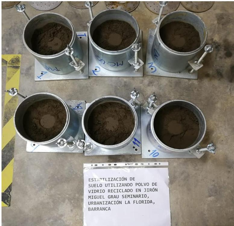
Figura 194, Se observa los moldes que hicieron el ensayo de penetración en la prensa CBR
