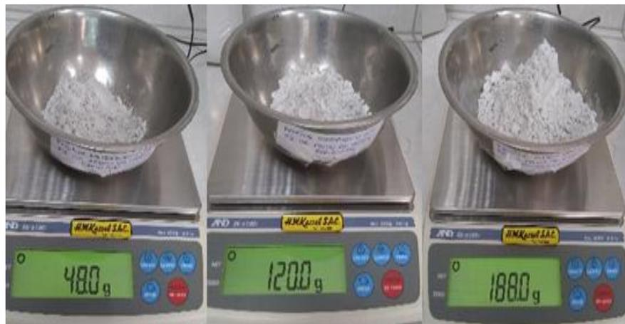
Figura 42, Aditivo estabilizador con porcentajes de 2, 5 y 8%
