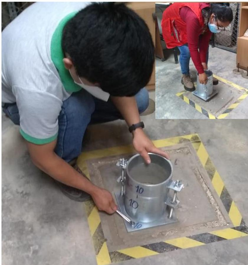
Figura 178, Se observa la colocación y empernado del molde CBR en su plataforma rígida
