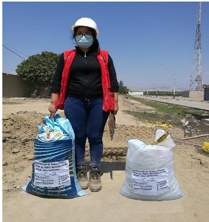
Figura 102, Se observa las muestras sacadas de la cota 0.30 m hasta 1.50 m de la calicata C-2
