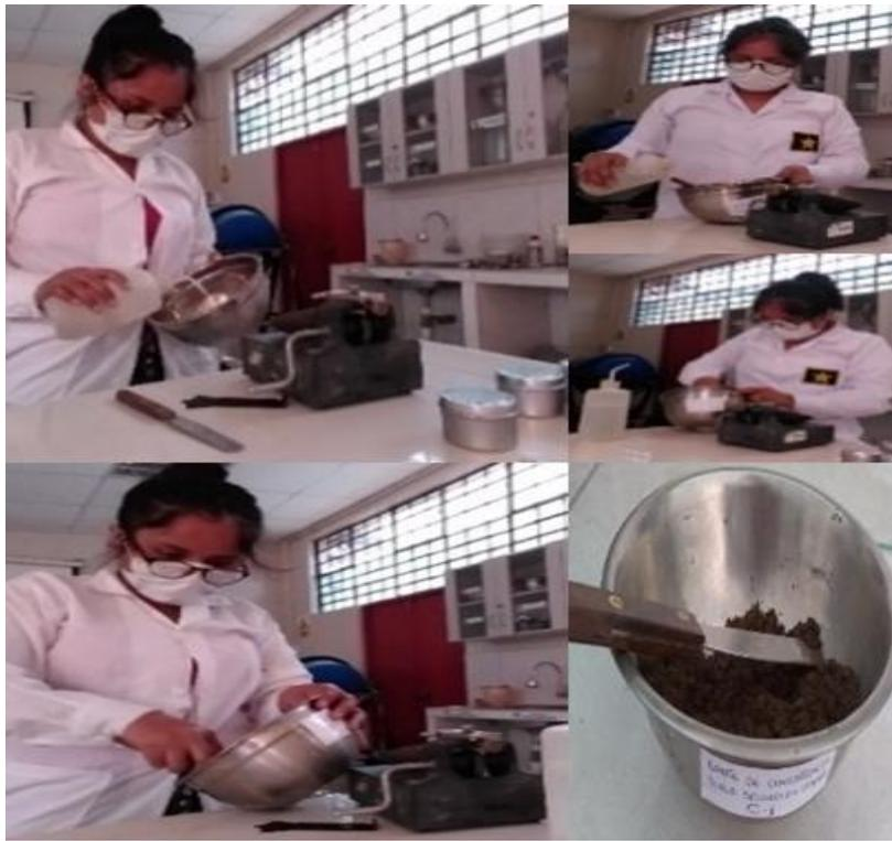
Figura 132, Se observa el momento de humedecimiento con agua destilada la muestra de suelo
