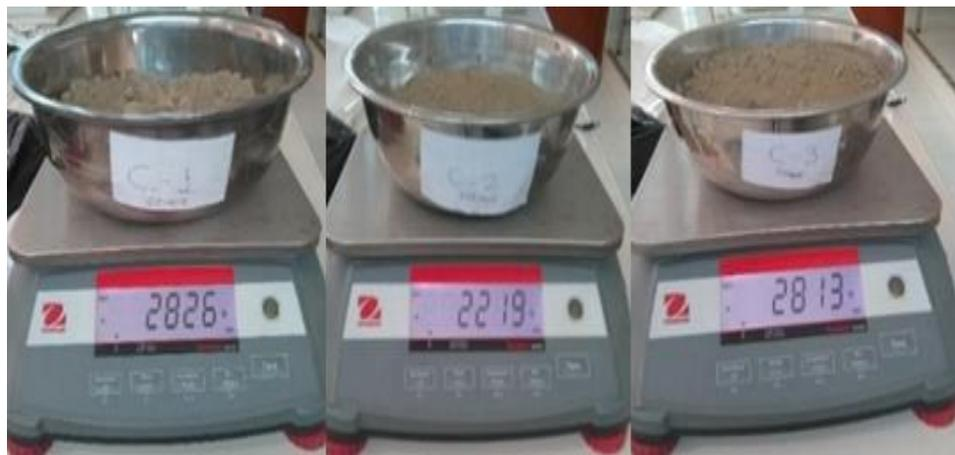
Figura 122, Se observa los pesos de las muestras secas iniciales para el análisis granulométrico
