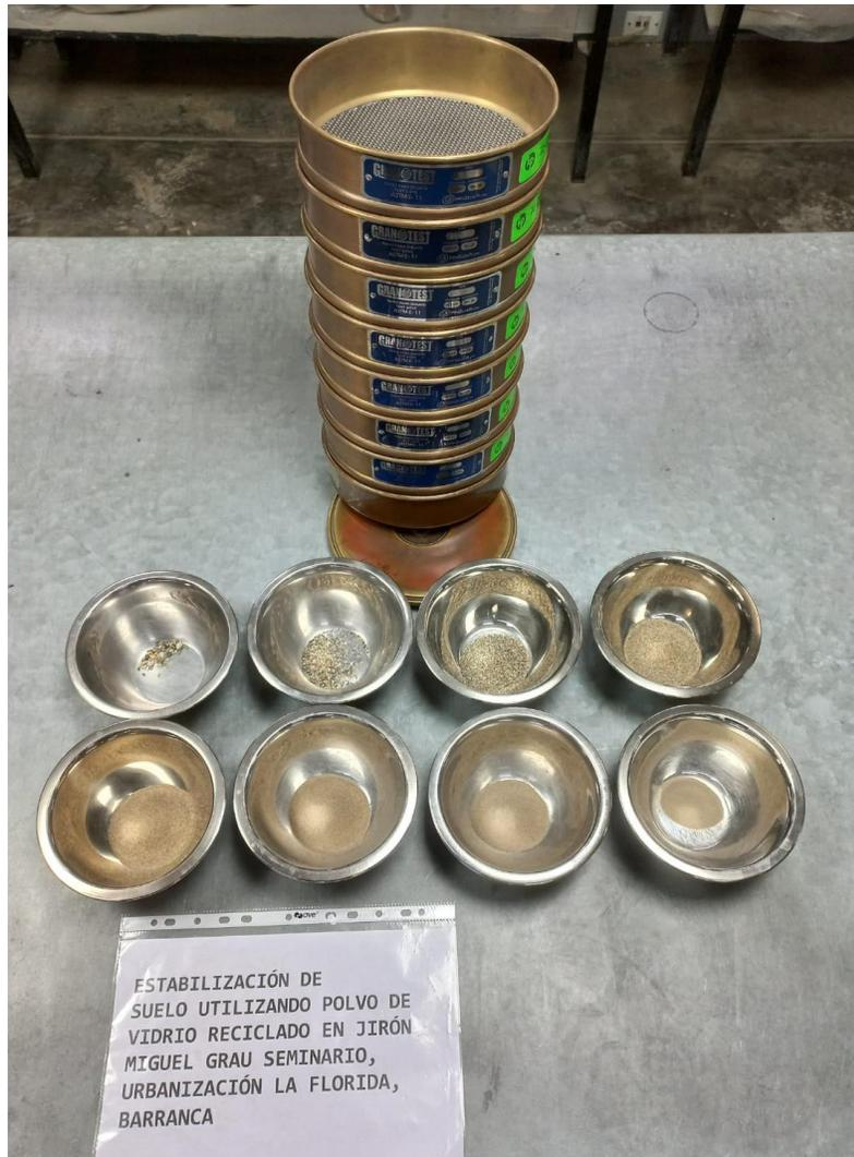
Figura 15, Equipo para el ensayo granulométrico por tamizado
