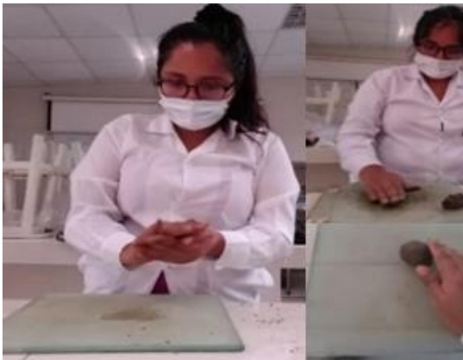
Figura 144, Se observa cuando se amasaba con las manos la muestra del límite líquido para realizar el límite plástico
