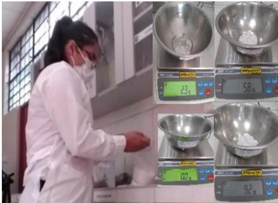
Figura 37, Peso del 2%, 5% y 8% de polvo de vidrio reciclado
