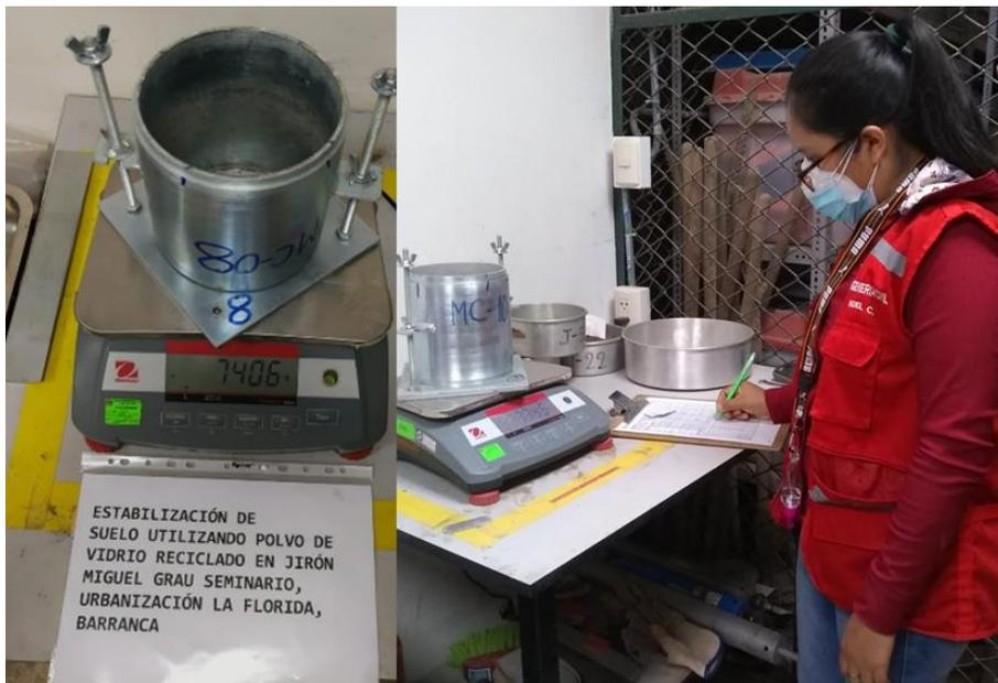
Figura 174, Se observa cuando se pesó de los tres moldes vacíos para prueba de CBR
