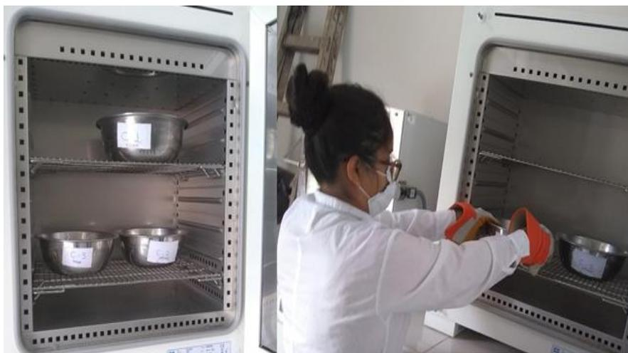
Figura 124., Se observa la colocación de las muestras lavadas y cuando se saca del horno
