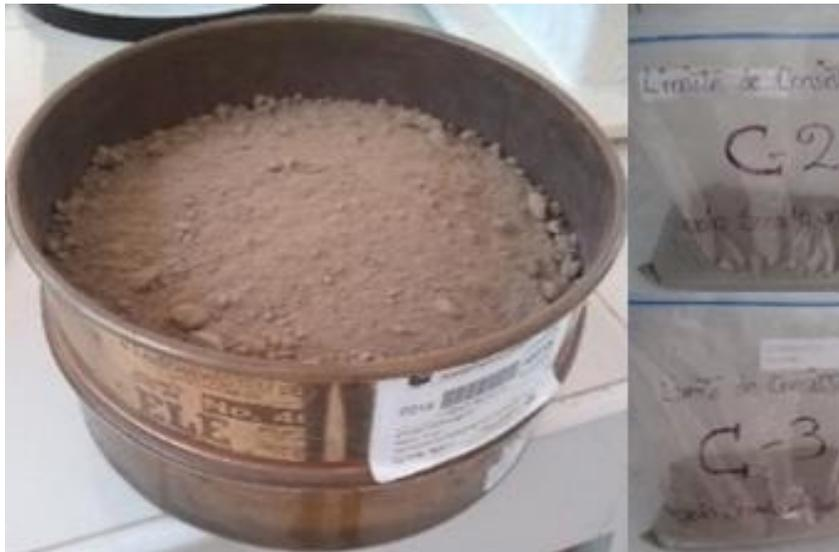
Figura 35, Tamizado de la muestra por la malla N° 40
