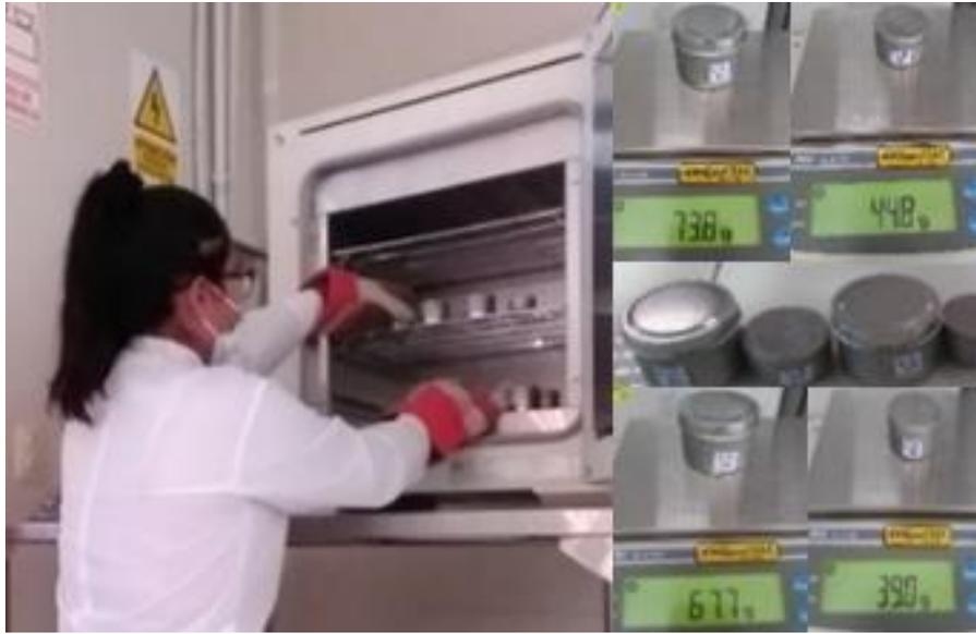
Figura 163, Se observa el peso de cada tara más el suelo compactado seco
