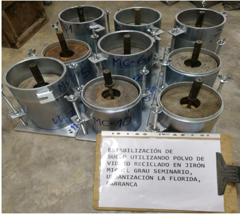
Figura 191, Se observa a los moldes CBR listos para ser llevados a la prensa de penetración
