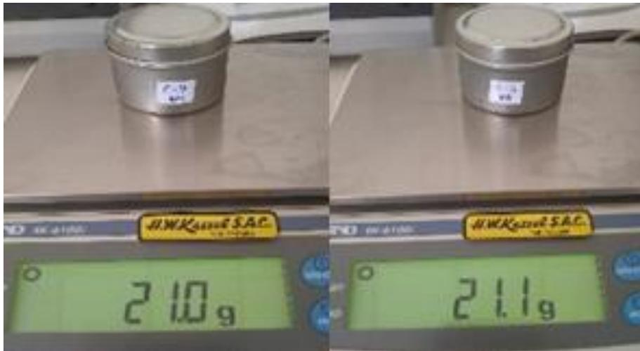
Figura 145, Se observa los pesos de los recipientes vacíos de la calicata
