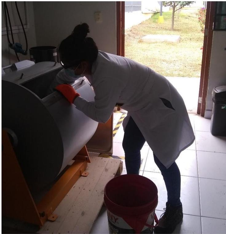
Figura 88, Se observa el momento en que se baseo el vidrio triturado a la máquina de los Ángeles
