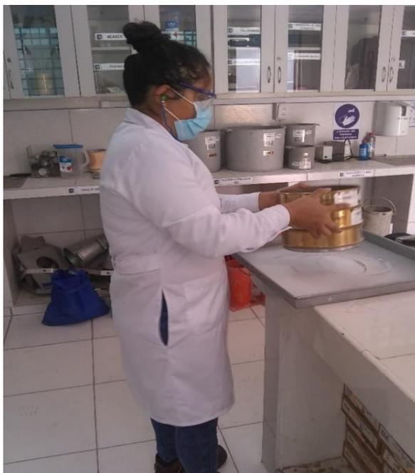
Figura 85, Se observa el tamizado de lo fino por la malla N° 200
