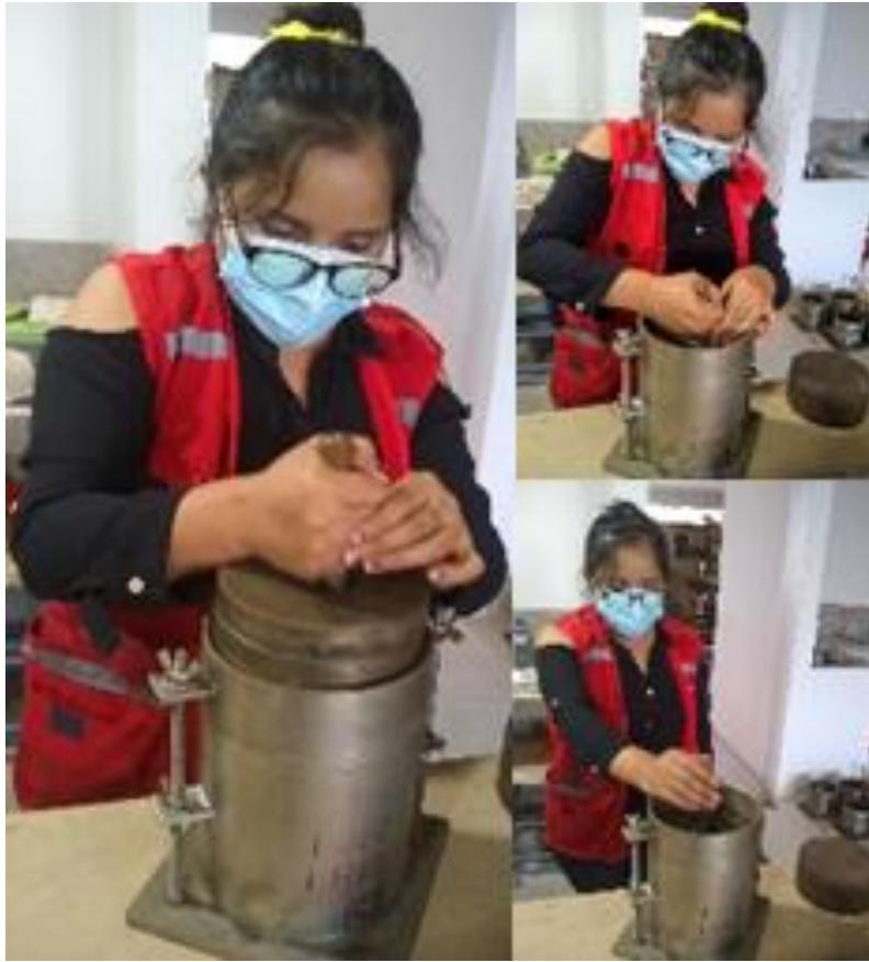
Figura 185, Se observa la colocación de las sobrecargas al molde CBR
