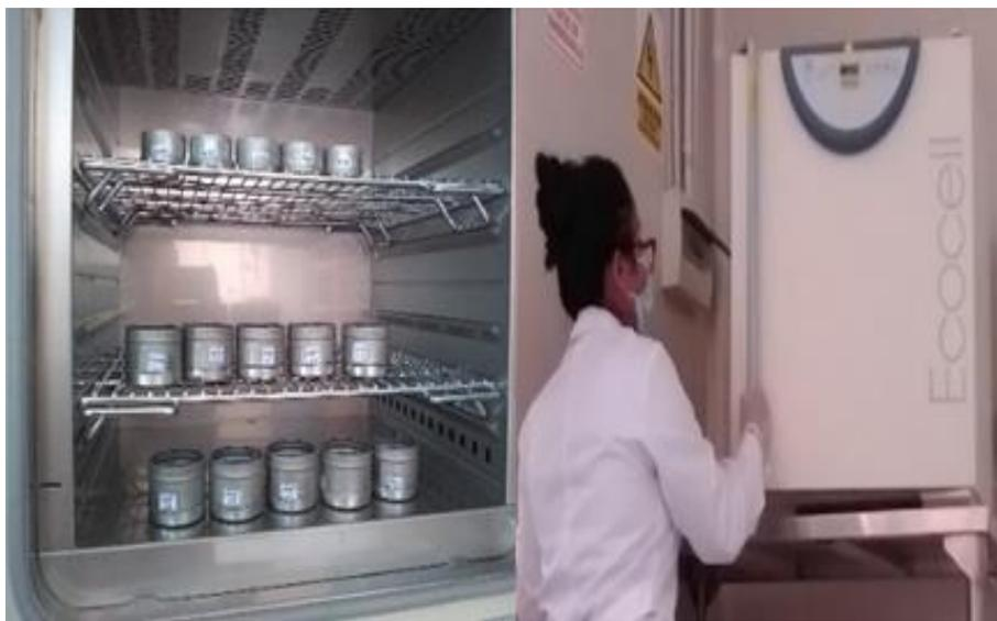
Figura 138, Se puso las muestras de los límites en el horno por 24 horas
