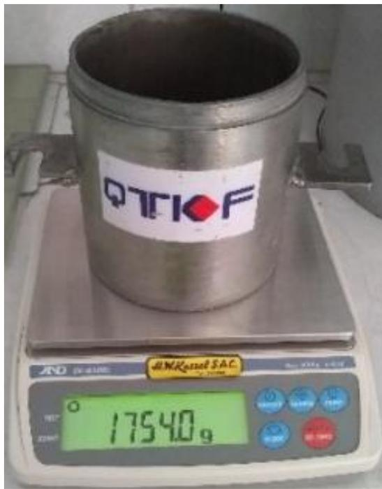
Figura 150, Se observa el peso del molde vacío de compactación
