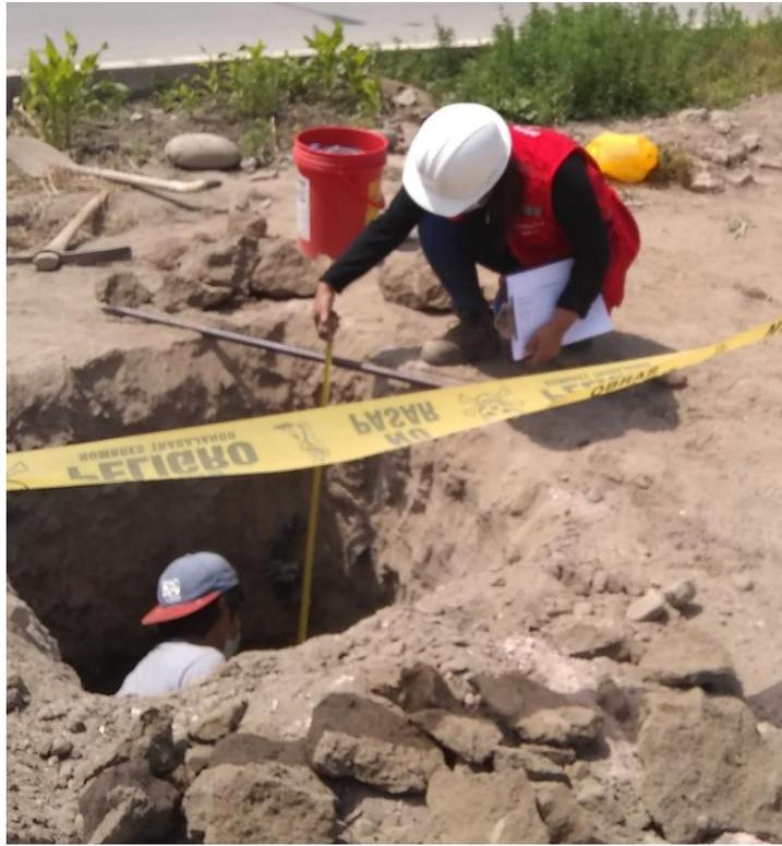
Figura 107, Se realiza la verificación de la altura de la calicata C-3
