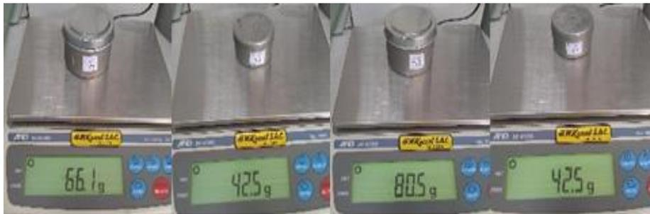
Figura 161, Se observa el peso de la tara más el suelo húmedo compactado de cada espécimen
