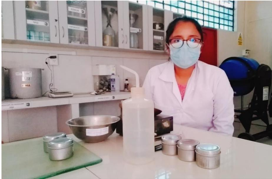
Figura 16, Equipos para el ensayo de límites líquido y plástico
