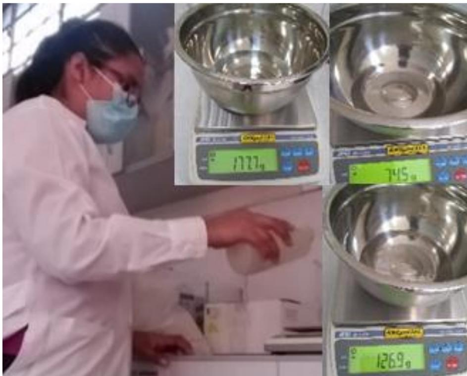
Figura 166, Se observa el peso del agua según humedades teóricas del 3%, 5%, 7%, 9% y 11% del peso seco de la nueva muestra
