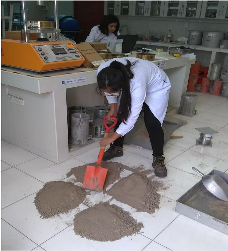
Figura 121, Se observa el cuarteo manual para el análisis granulométrico
