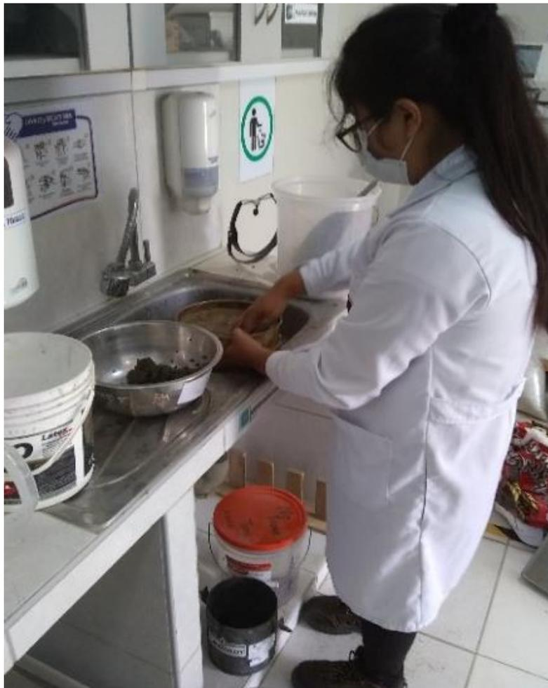
Figura 34, Lavado de las muestras para la separación de los finos
