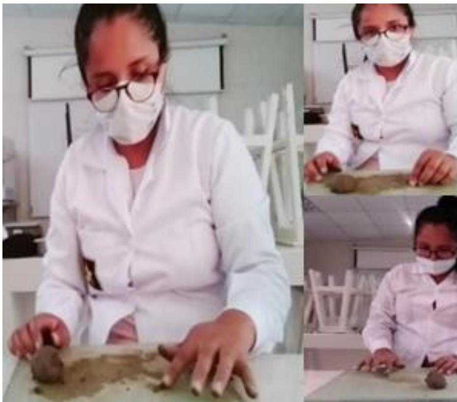
Figura 146, Se observa la muestra tomada de 1.5 g para formar cilindros de 3.2 mm
