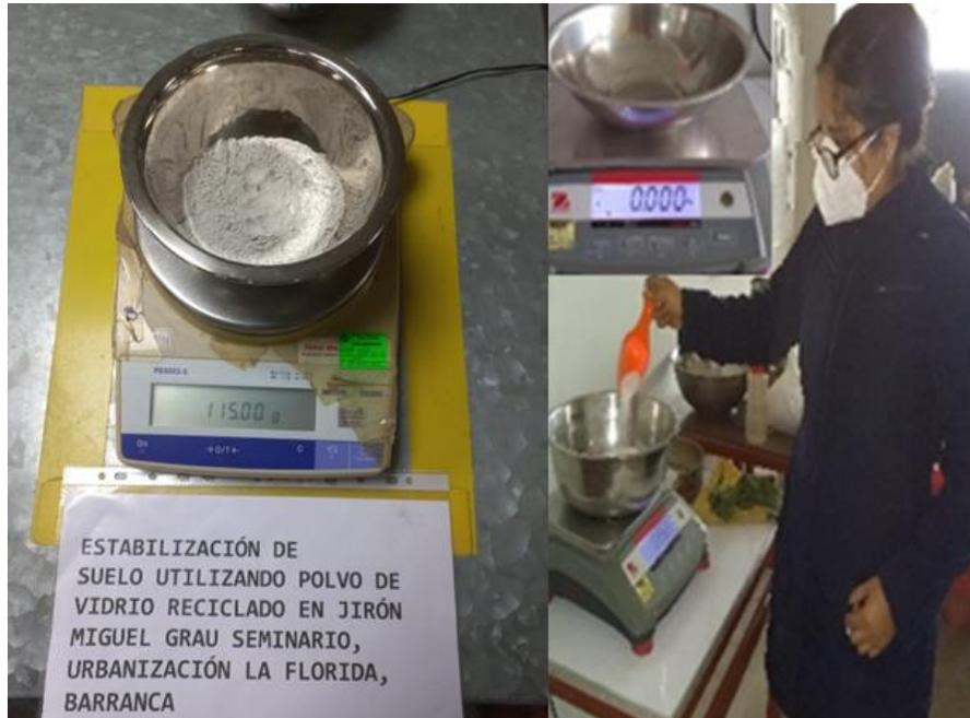
Figura 196, Se observa el peso de los porcentajes del 2%, 5% y 8% de PVR para ensayo de CBR
