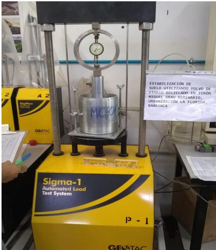
Figura 192, Se observa el asentamiento del pistón de la prensa en el molde CBR
