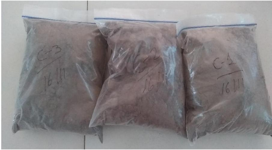
Figura 111, Muestra conservada en bolsa hermética para ensayo de humedad natural.
