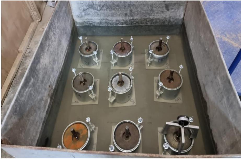
Figura 187, Se observa el proceso de Inmersión de los moldes CBR por 96 horas
