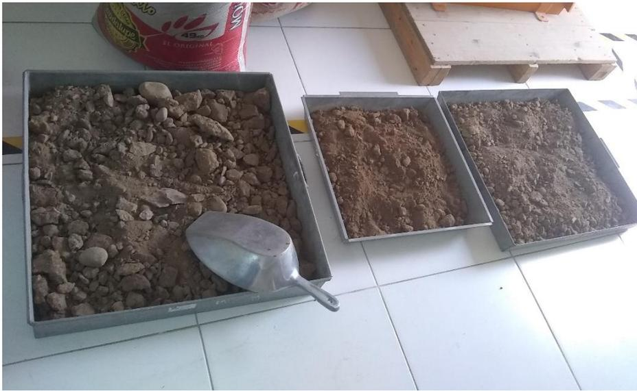
Figura 112, Se observa las muestras húmedas tendida en las bandejas para su secado total
