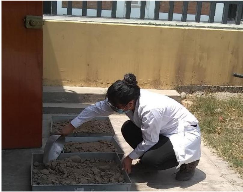
Figura 31, Muestras de suelo secado al aire libre - UNAB
