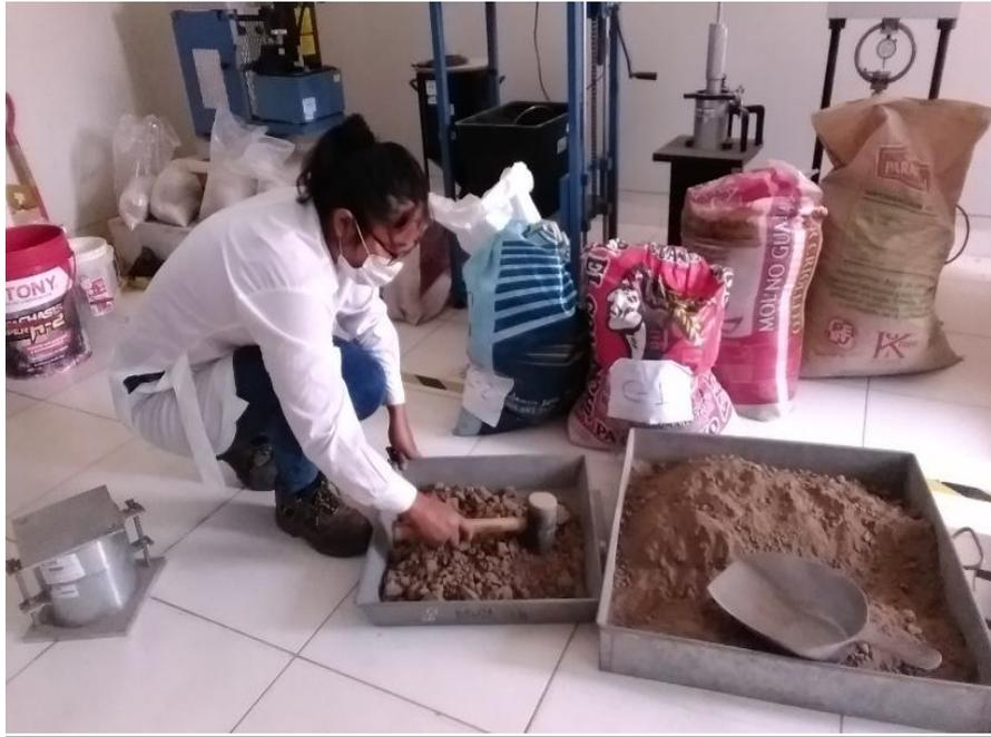
Figura 115, Se observa el momento en que se empezó a desmenuzar los terrones de las muestras secas.
