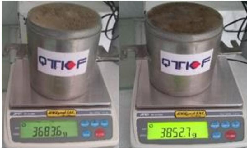
Figura 160, Se observa el peso de los moldes más el suelo compactado de las calicatas
