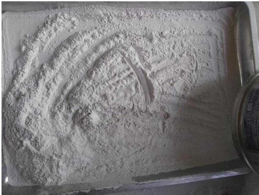
Figura 23, Resultado del tamizado - polvo de vidrio.
