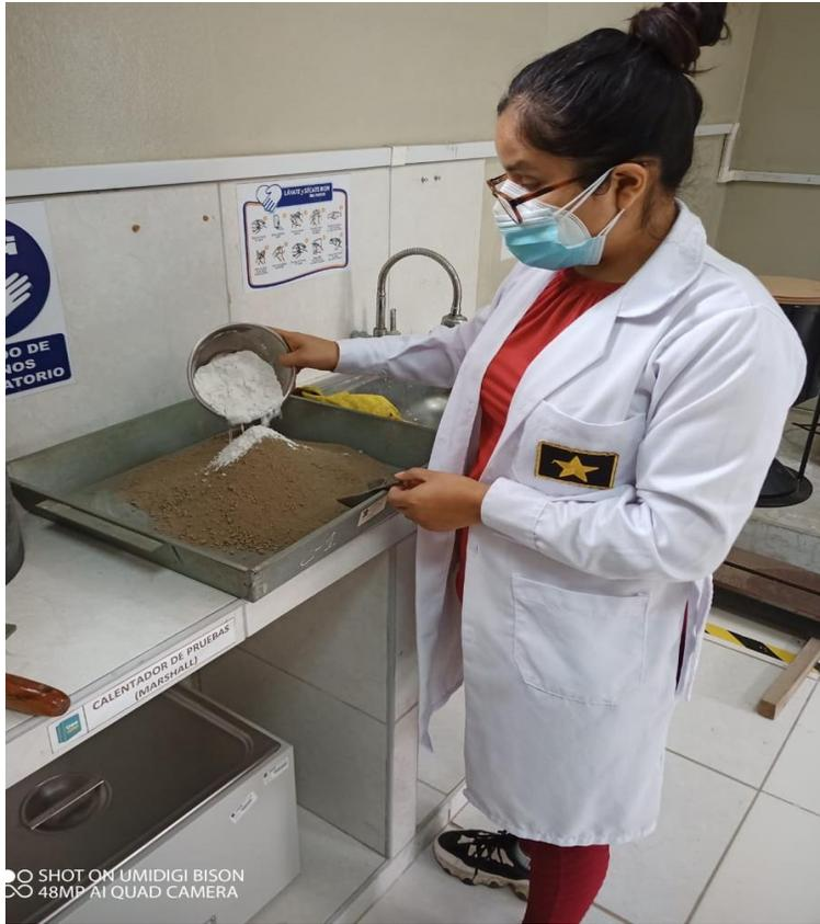
Figura 167, Se observa la muestra de suelo y el Polvo de vidrio reciclado en un recipiente
