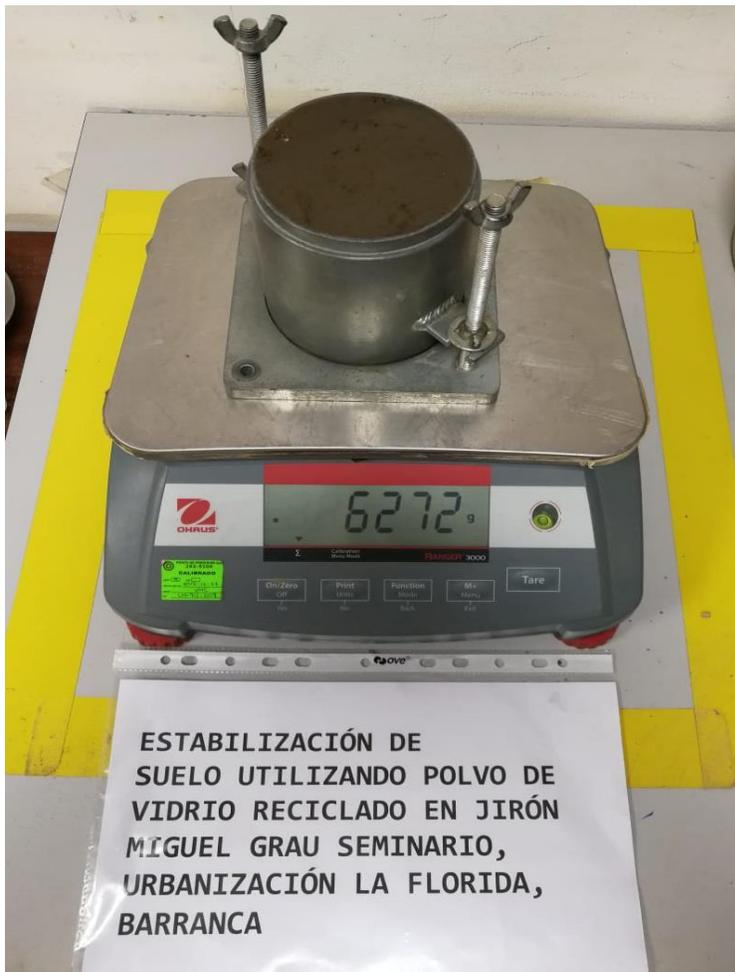
Figura 184. Se observa el peso del molde CBR mas la muestra compactada
