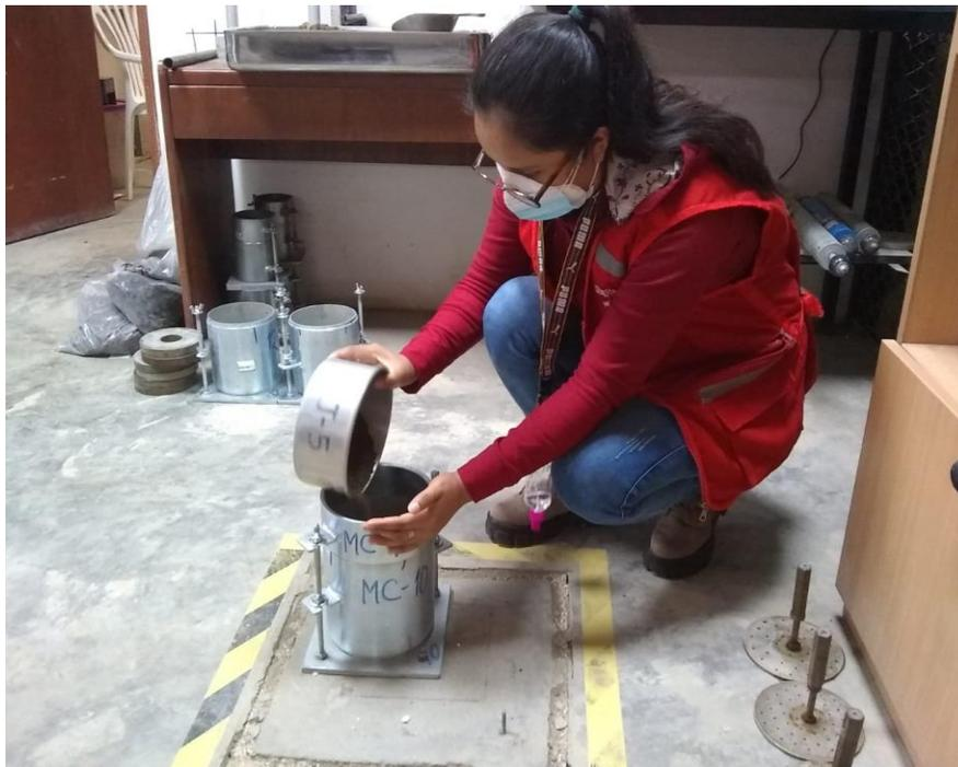
Figura 180, Se observa el vaciado de la primera capa de muestra para compactación de CBR
