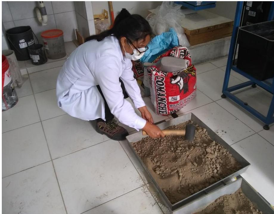
Figura 116, Se continuo hasta terminar de desmenuzar los terrones utilizando el martillo de goma
