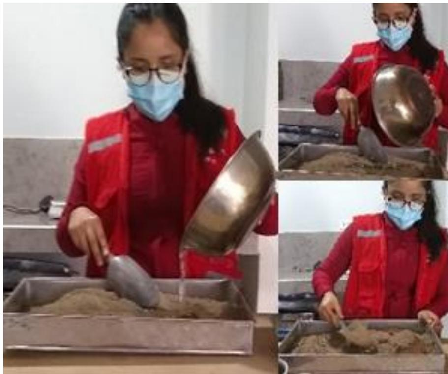
Figura 198, Se observa el humedecimiento del nuevo espécimen y realizar la compactación en los moldes de un CBR
