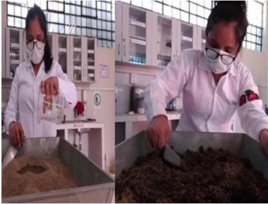
Figura 169, Se observa el momento de humedecimiento del espécimen con polvo de vidrio para realizar la compactación
