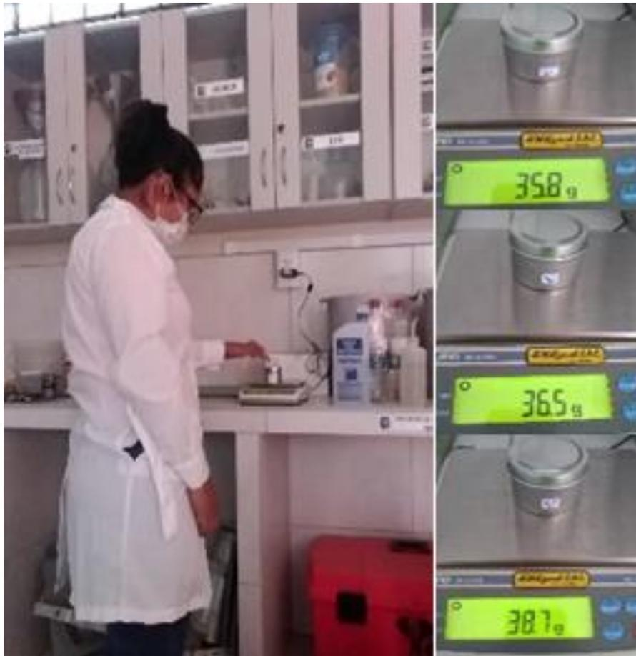
Figura 137, Se observa cuando se pesó los recipientes más la muestra húmeda
