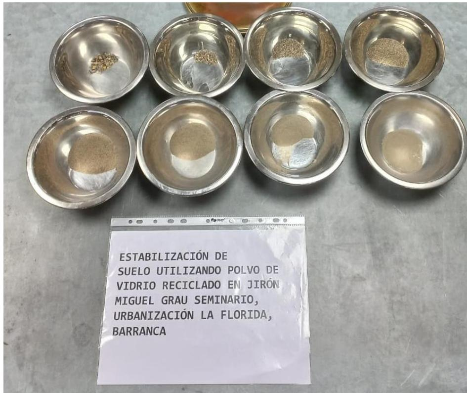
Figura 128, Se observa el tamaño de las partículas granulométricas de las muestras de suelo en el ensayo granulométrico
