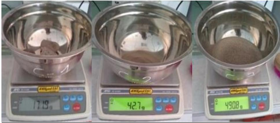
Figura 127, Se observa el peso del material retenido en cada tamiz - UNAB
