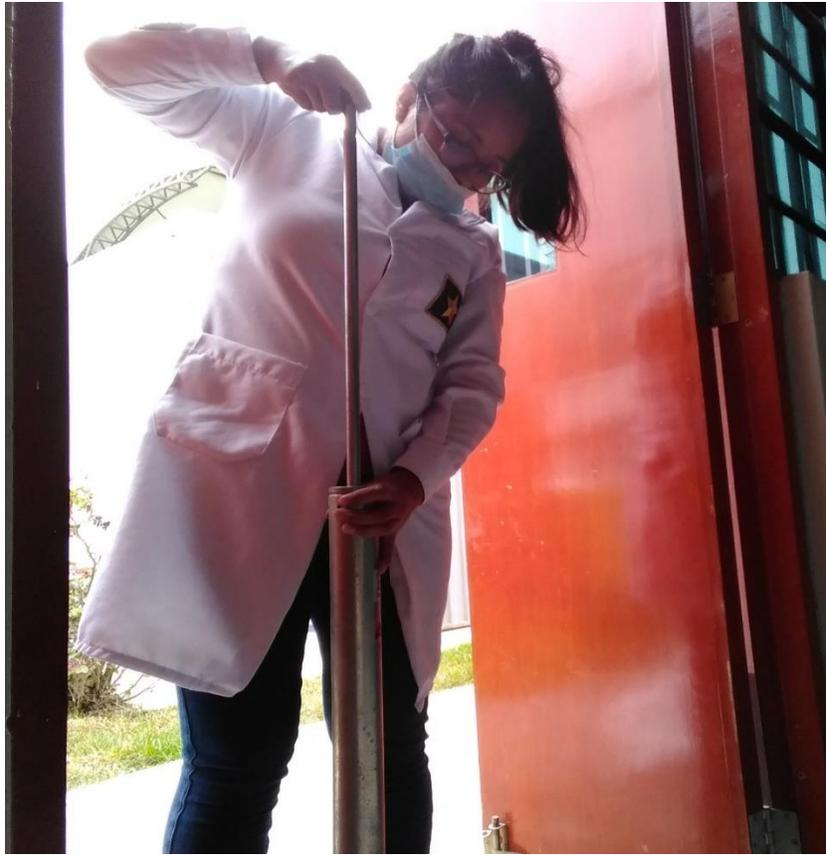
Figura 158, Se observa cuando se estaba compactando las muestras de suelo en 5 capas.
