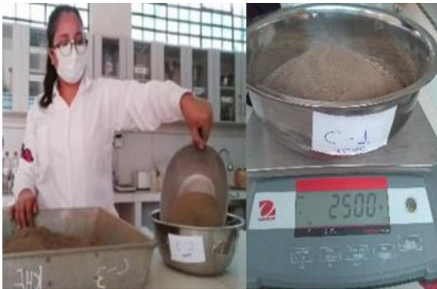
Figura 154, Se observa cuando se pesó 2500 g de muestra de suelo de las calicatas
