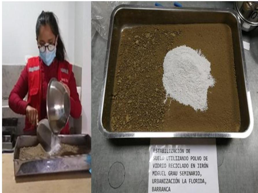
Figura 197, Se observa el mezclado homogéneo del suelo con PVR para moldes de CBR
