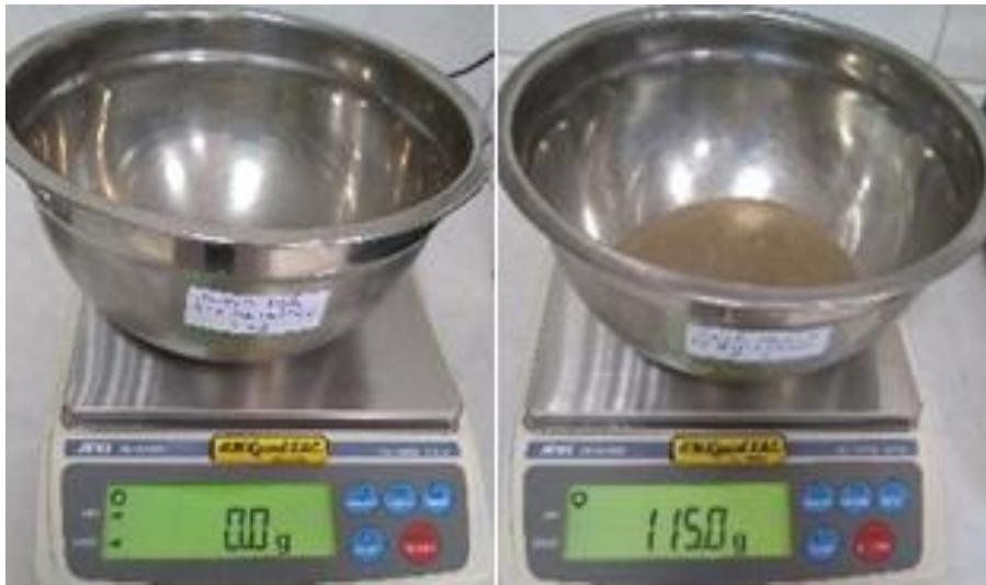
Figura 140, Se observa el peso de 115g de suelo utilizado para los porcentajes de 2%, 5% y 8% de PVR
