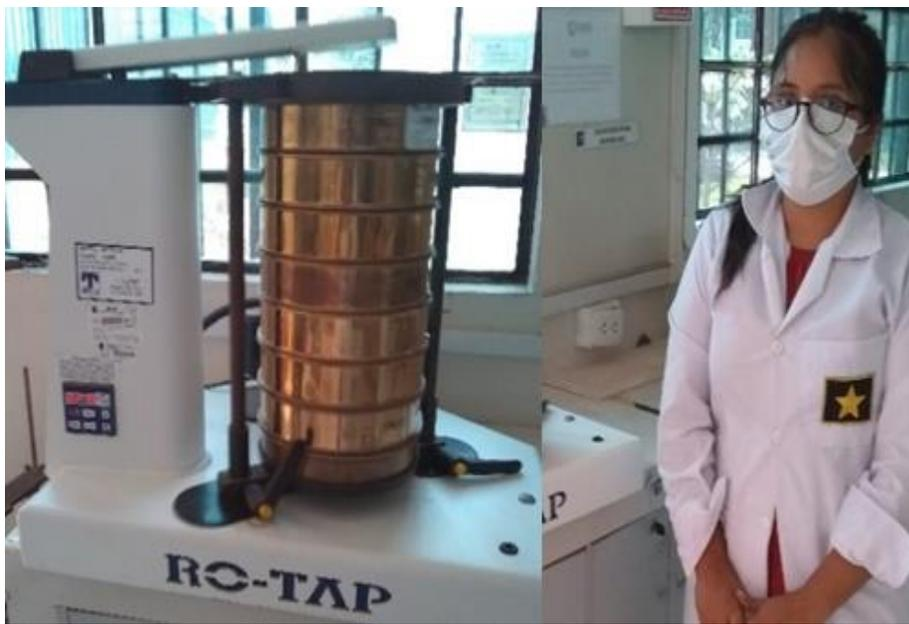
Figura 126, Se observa el tamizado mecánico de la fracción fina
