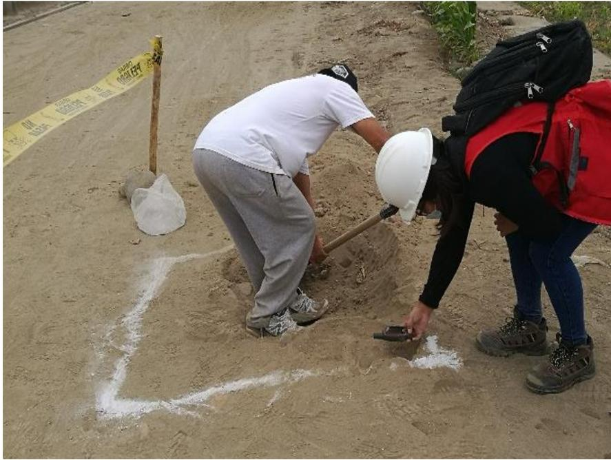
Figura 105, Se observa la posición del GPS para obtener las coordenadas UTM de la calicata C-3
