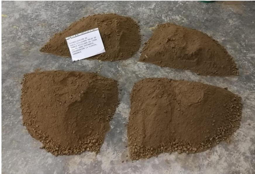
Figura 33, Cuarteo manual para el análisis granulométrico
