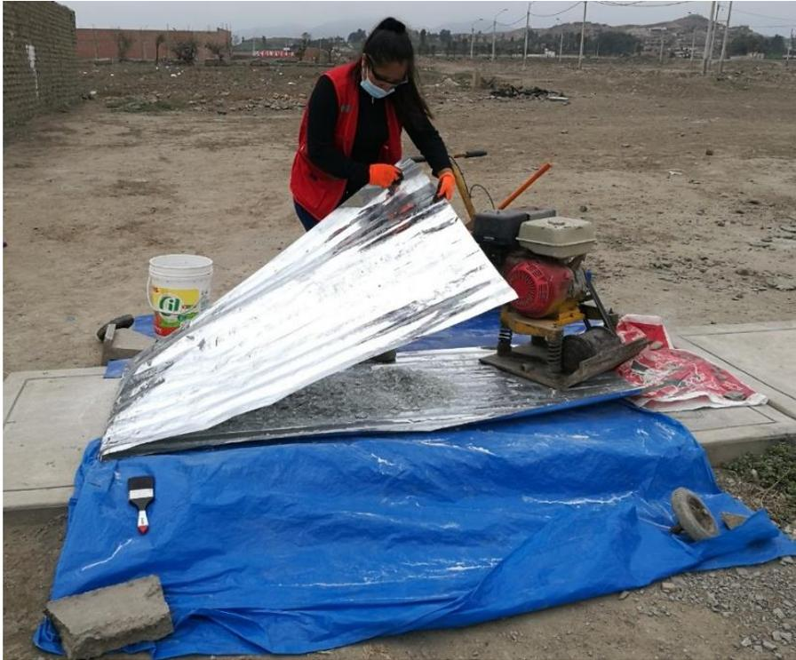
Figura 82, Se observa el momento de cuando se tapa el vidrio para otra pasada con la plancha compactado
