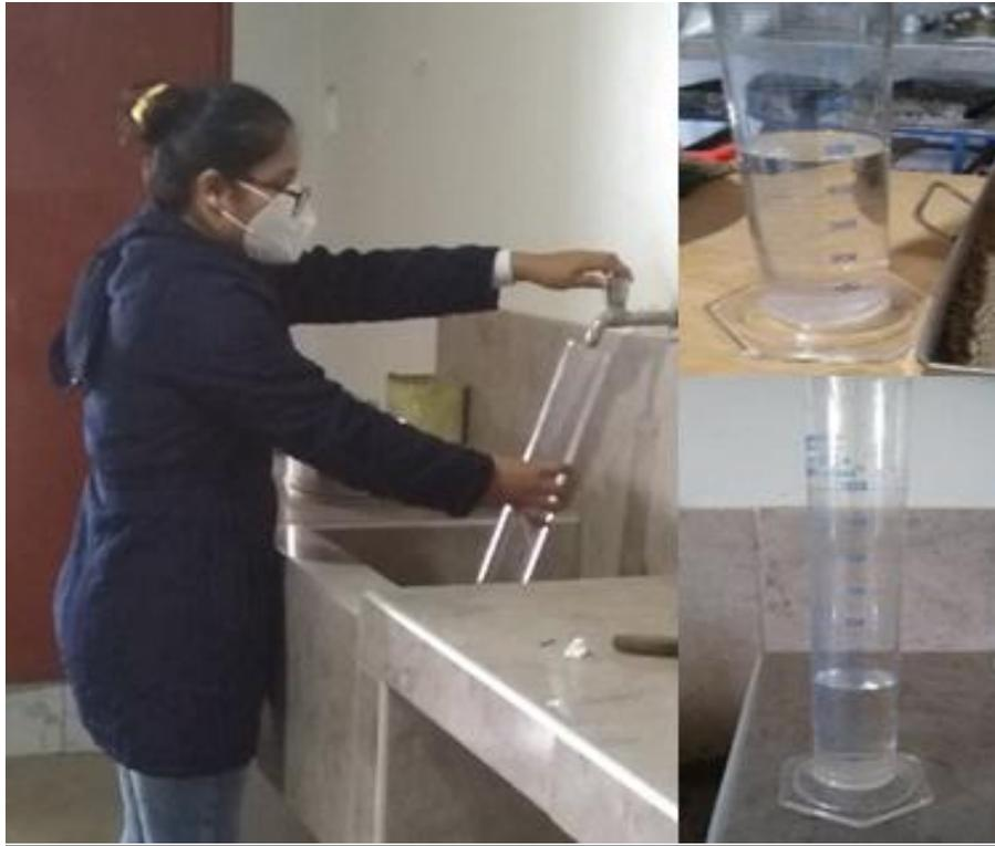
Figura 173, Se observa la cantidad de agua para la muestra de CBR
