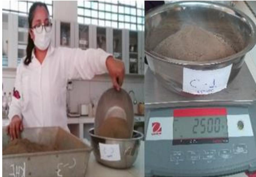
Figura 40, Peso de 2500 g de muestra de suelo de la C-1
