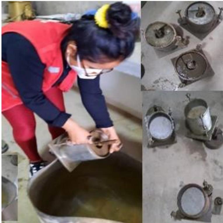
Figura 190, Se observa el escurrimiento del agua de los moldes CBR por 15 min luego de haber transcurrido las 96 horas
