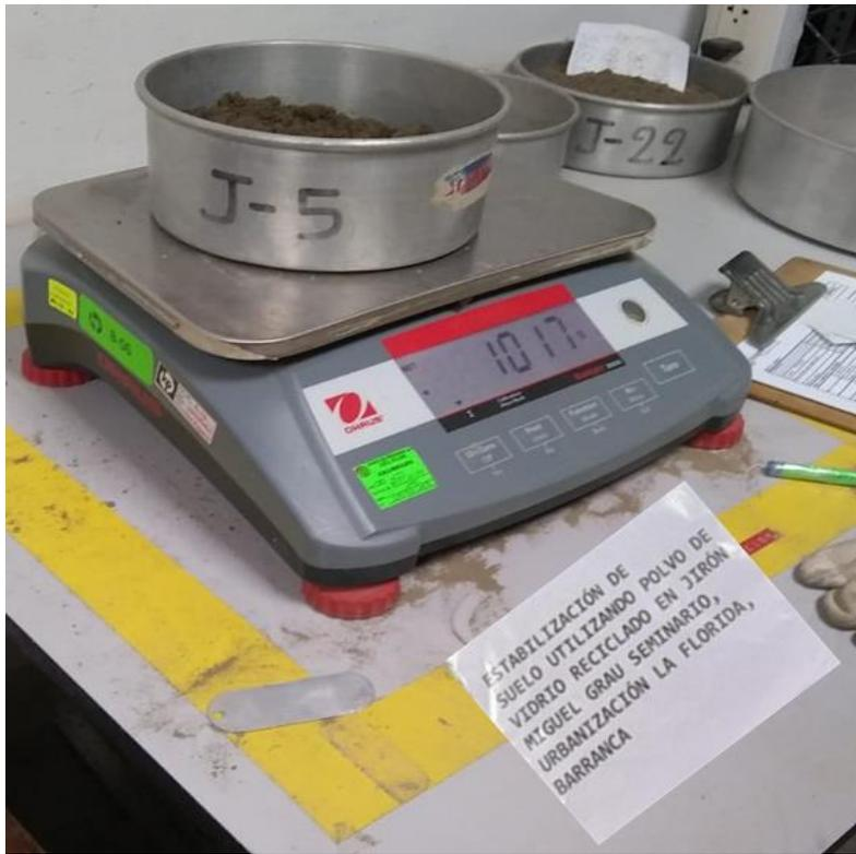
Figura 179, Se observa el peso de 1.2 kg para cada capa de compactación de CBR
