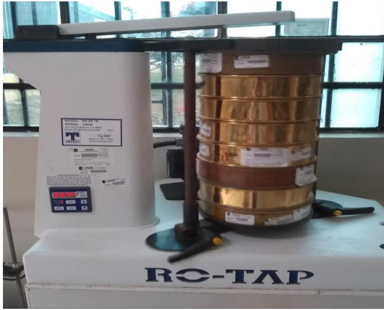
Figura 91, Se observa el tamizado del vidrio molido en la tamizadora mecánica
