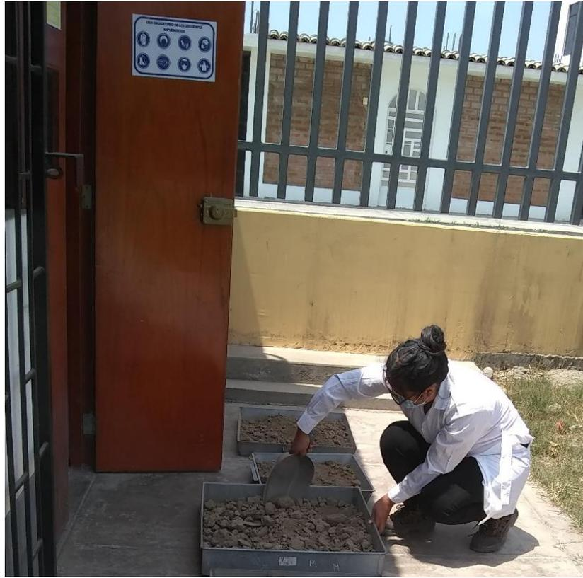
Figura 113, Se observa las muestras expuestas al aire libre para su secado total como lo indica la MTC E-105
