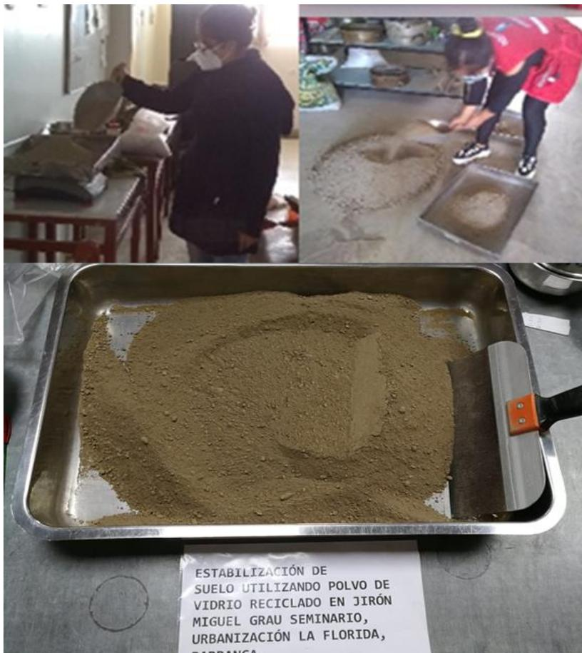
Figura 172, Se observa cuando se pesó la muestra de suelo para prueba de CBR
