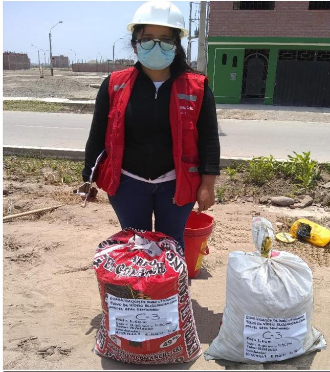
Figura 109, Se observa las muestras sacadas de la cota 0.20 m hasta 1.60 m de la calicata C-3
