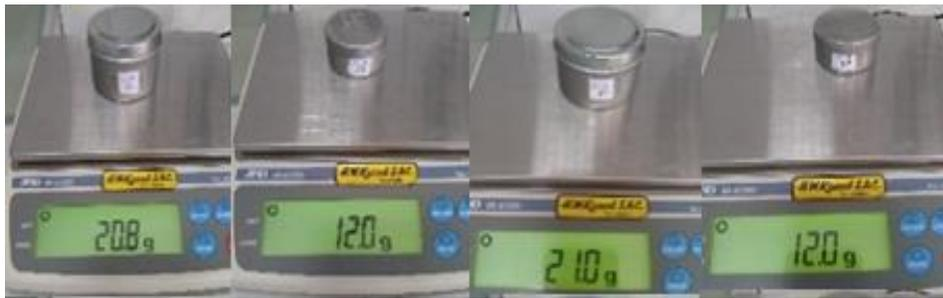
Figura 156, Se observa los pesos de los recipientes vacíos para la muestra húmeda compactada
