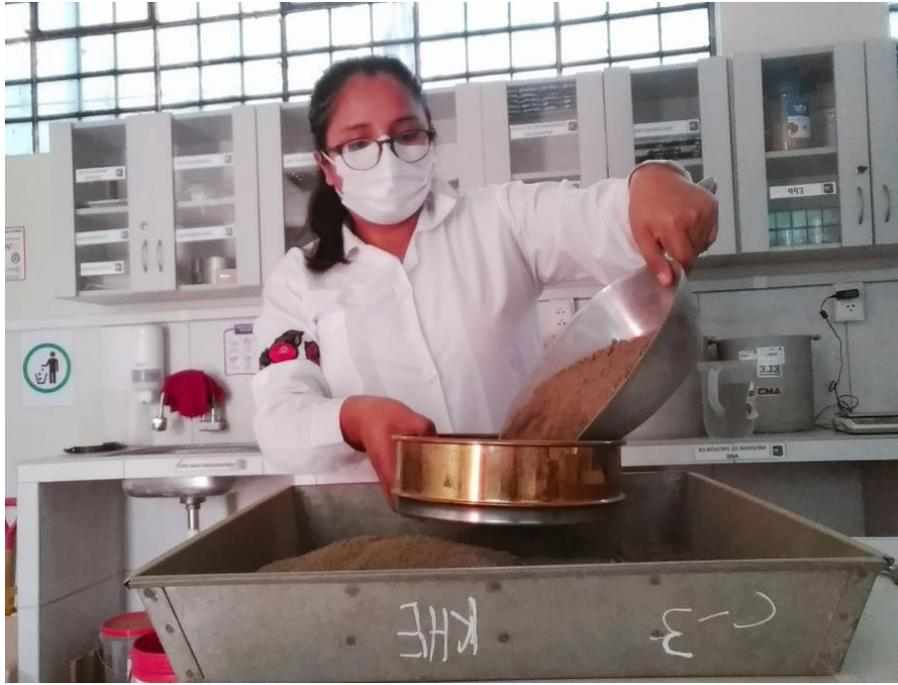
Figura 153, Se observa el tamizado de la muestra por la malla N° 4 para el ensayo proctor modificado
