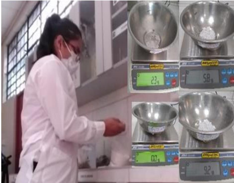
Figura 141, Se observa cuando se pesa el 2%, 5% y 8% de polvo de vidrio reciclado para el ensayo de los límites líquido y plástico
