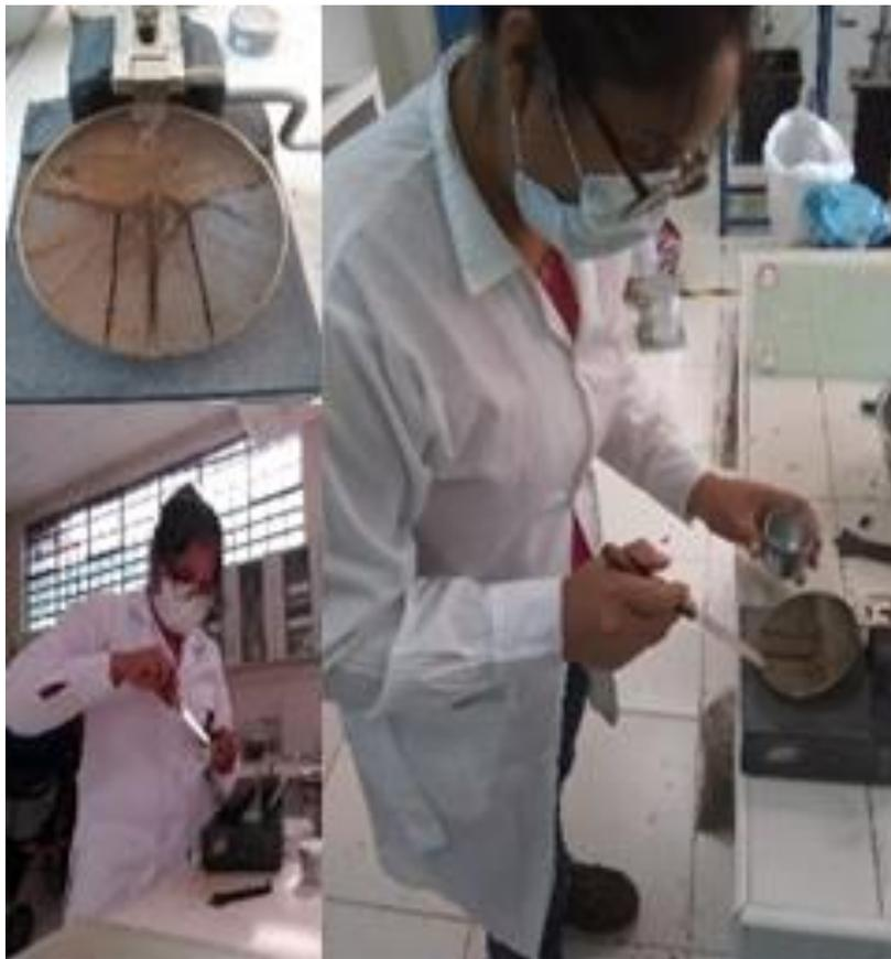
Figura 136, Se saca una tajada de suelo tomada perpendicularmente a la ranura
