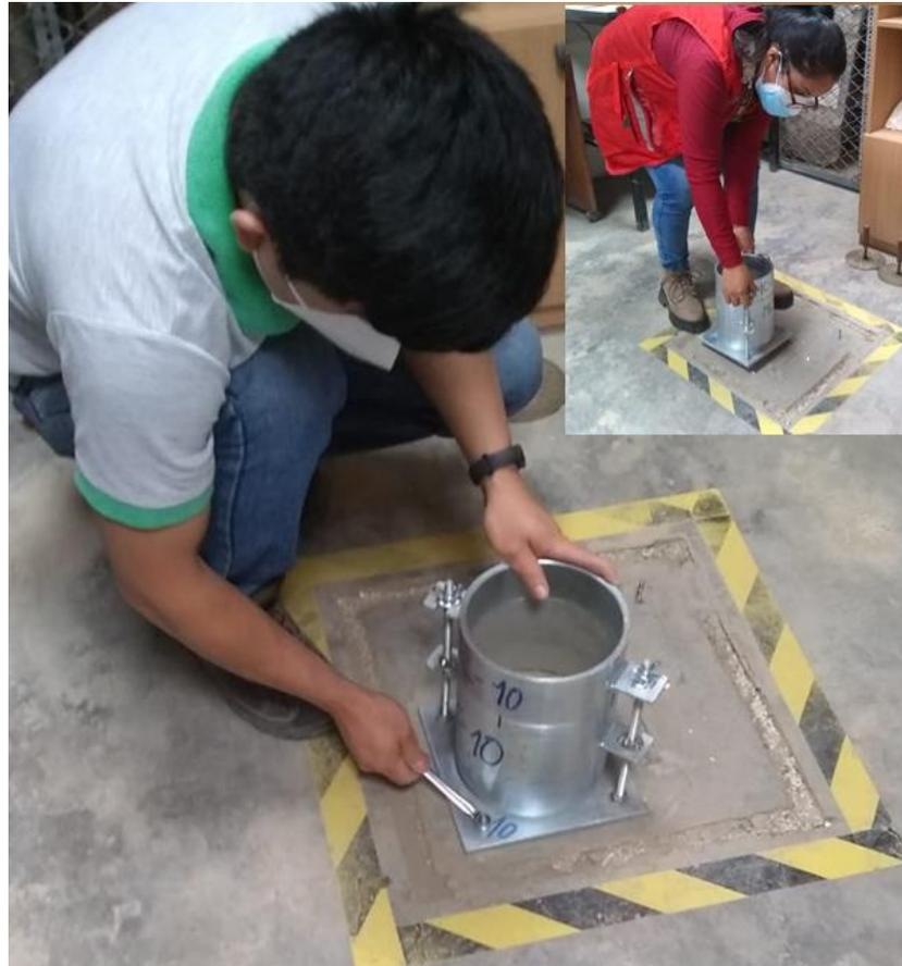
Figura 45, Colocación y empernado del molde CBR en su plataforma rígida
