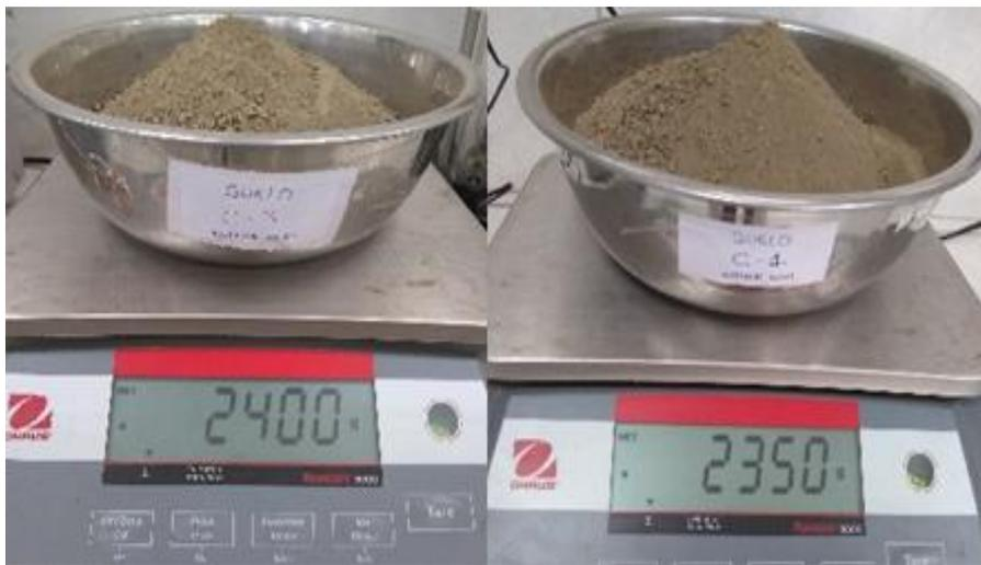
Figura 164, Se observa el peso de las muestras usadas para el 2%, 5% y 8% de Polvo de vidrio reciclado
