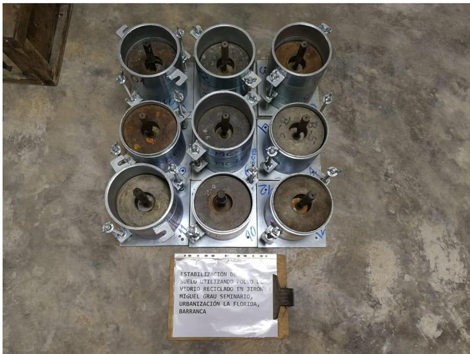
Figura 19, Moldes metálicos cilíndricos para estudio de CBR
