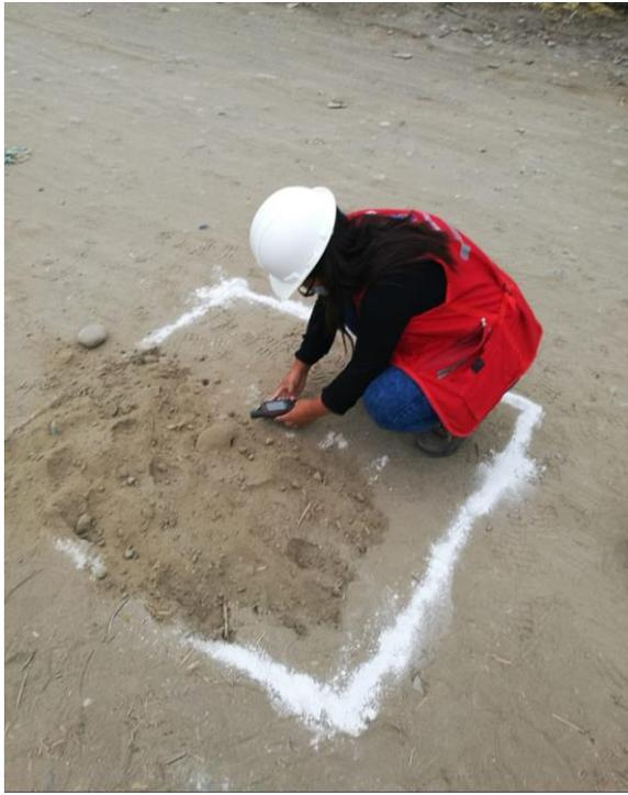
Figura 95, Se observa la posición del GPS para obtener las coordenadas UTM de la calicata C-1
