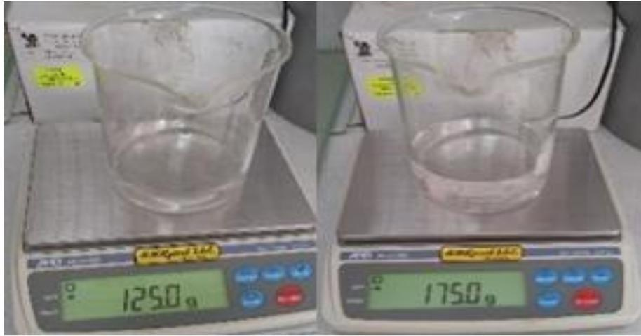
Figura 155, Se observa el peso del agua en base a las humedades teóricas del 5% al 11% del peso seco de las calicatas
