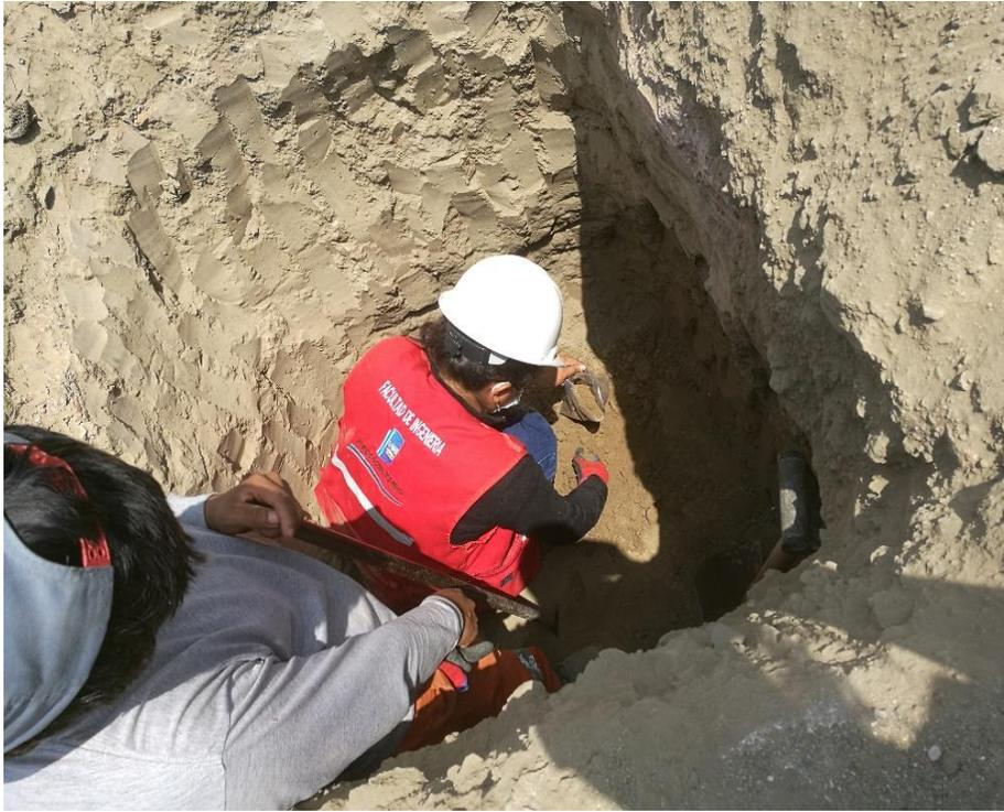
Figura 106, Se observa el momento en que saca una muestra para contenido de humedad natural de la calicata C-3
