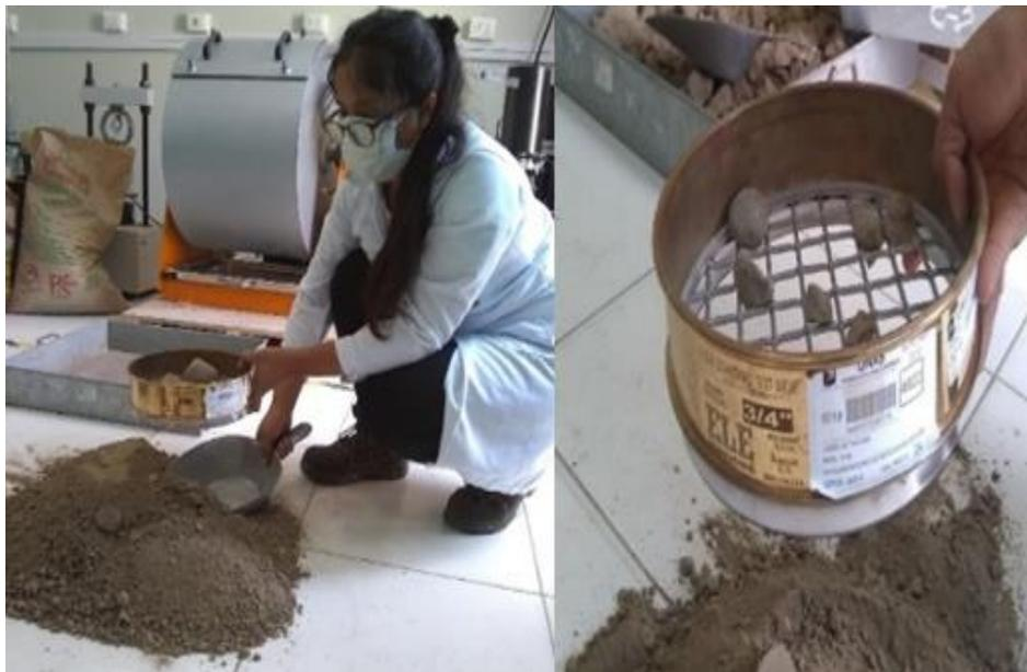
Figura 120, Se observa el tamizado para obtención de las partículas de tamaño máximo de 1 1/2" y 3/4"
