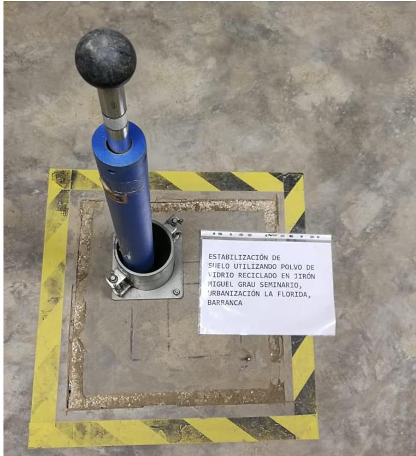
Figura 17, Equipo para el ensayo de proctor modificado
