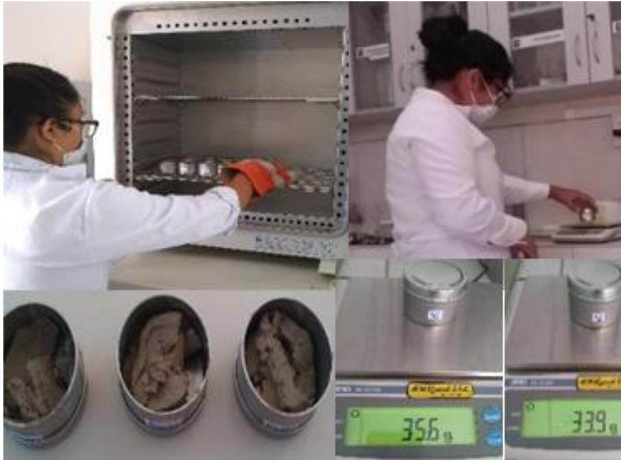
Figura 139, Se observa cuando se pesa los recipientes de los limites sacadas del horno
