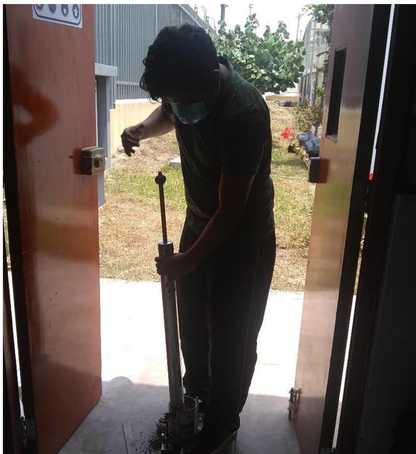
Figura 41, Compactación de las muestras de suelo en 5 capas.
