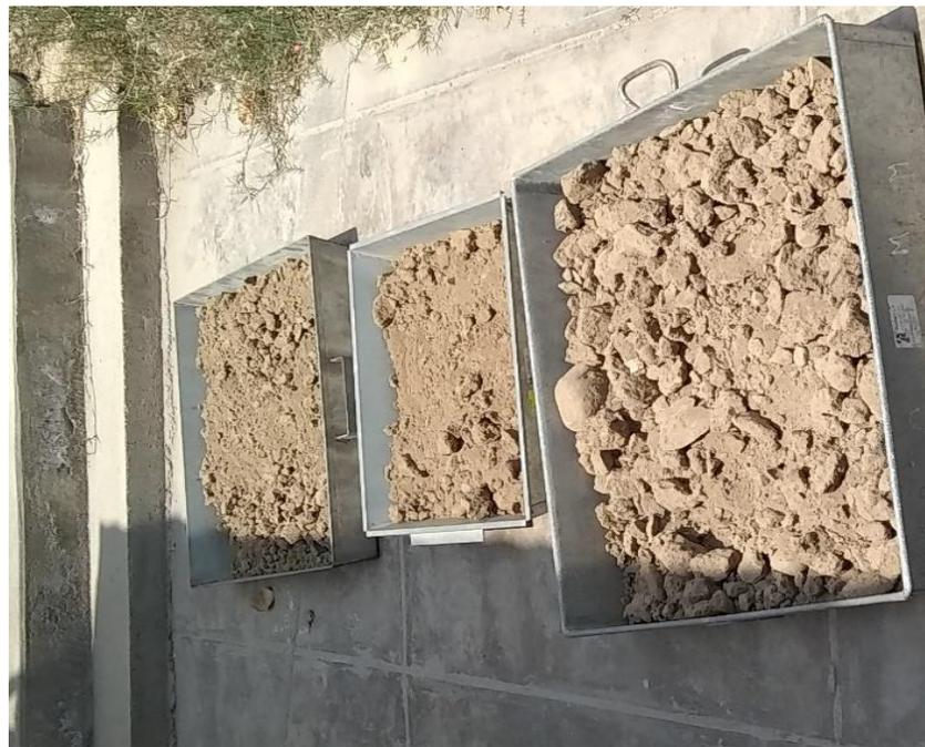
Figura 114, Se observa las muestras secas para iniciar los ensayos
