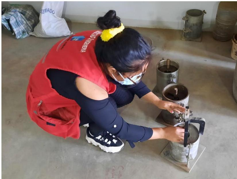
Figura 186, Se observa la posición del trípode sobre los moldes CBR para la inmersión
