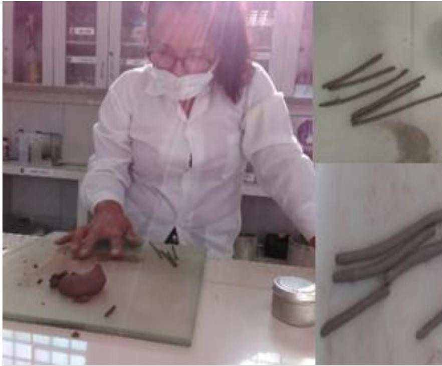
Figura 147, Se observa en el momento en que se formaban los cilindros de suelo de diámetro de 3.2 mm
