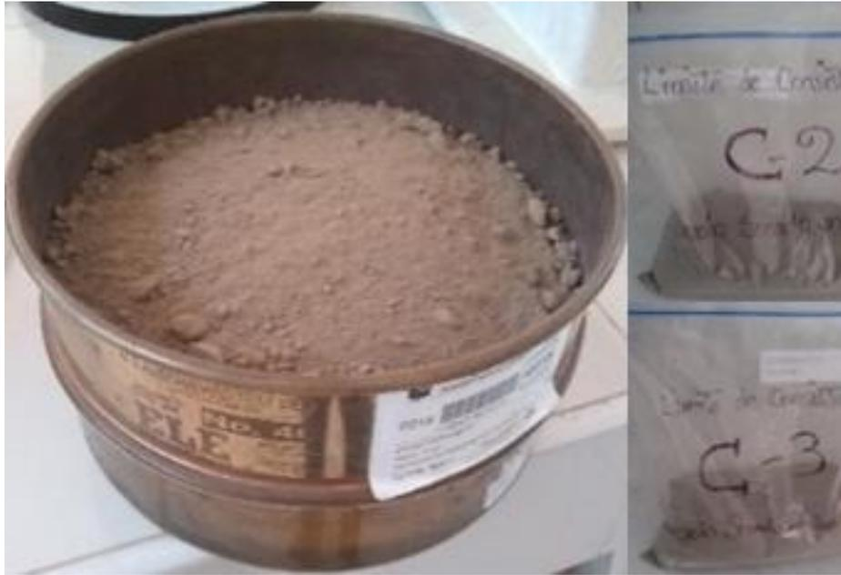
Figura 129, Se observa el tamizado de la muestra por la malla N° 40
