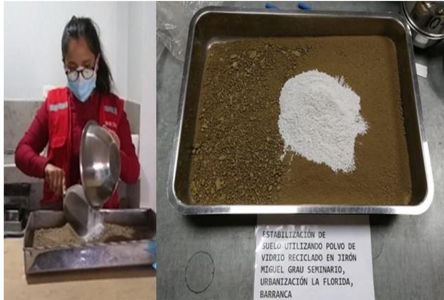
Figura 50, Mezclado homogéneo del suelo con PVR para moldes de CBR
