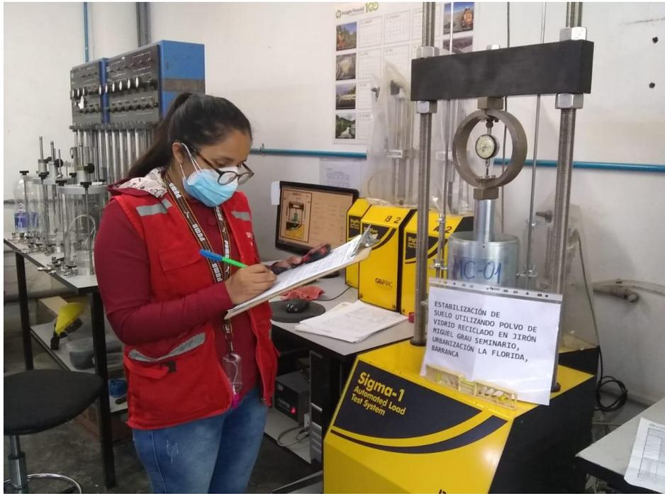
Figura 193, Se observa cuando se está leyendo las lecturas del ensayo de Penetración a las muestras de suelo
