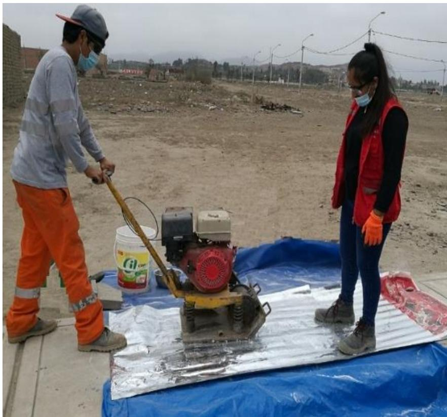
Figura 22, Trituración del vidrio con la plancha compactadora
