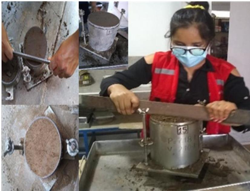
Figura 159, Se observa cuando se estuvo enrasado y rellenando los hoyos con el espécimen compactado
