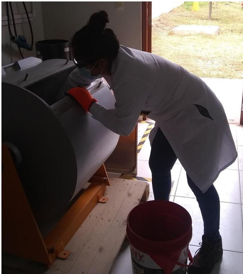
Figura 24, Molienda del vidrio triturado en la máquina de los ángeles
