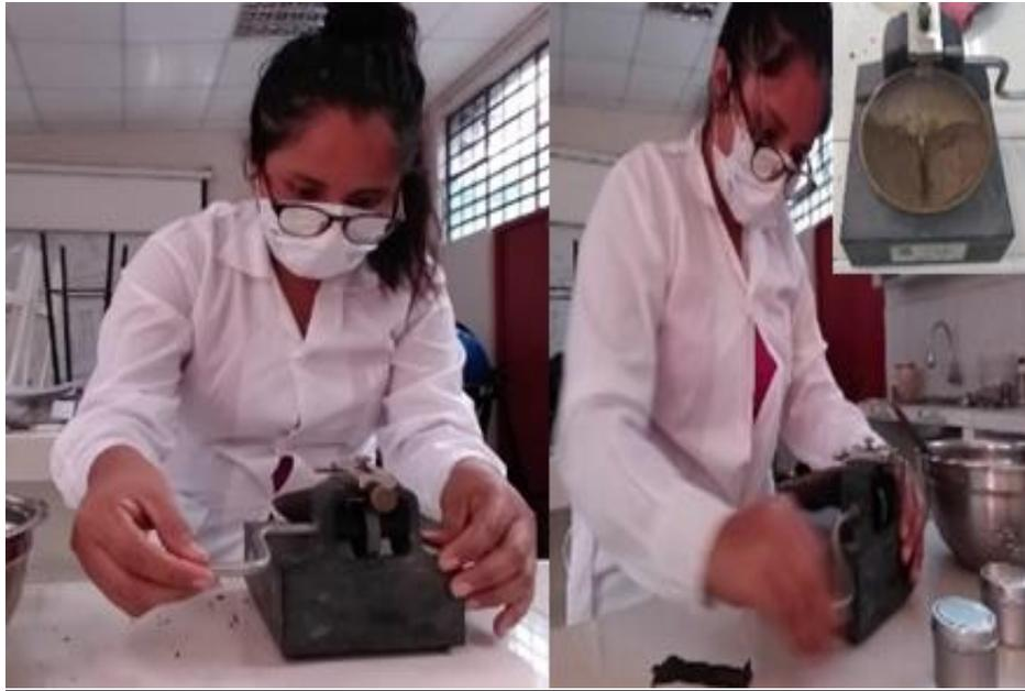
Figura 135, Se realizó el conteo del número de golpes hasta el cierre de la ranura
