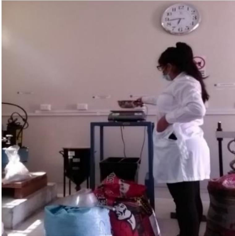
Figura 117, Se observa cuando se pesó los contenedores vacíos para especímenes de las calicatas
