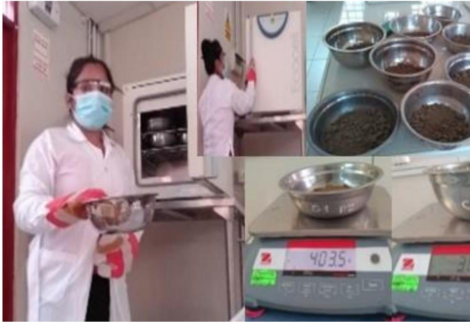
Figura 119, Se observa cuando se saca las muestras del horno para pesarlo en la balanza
