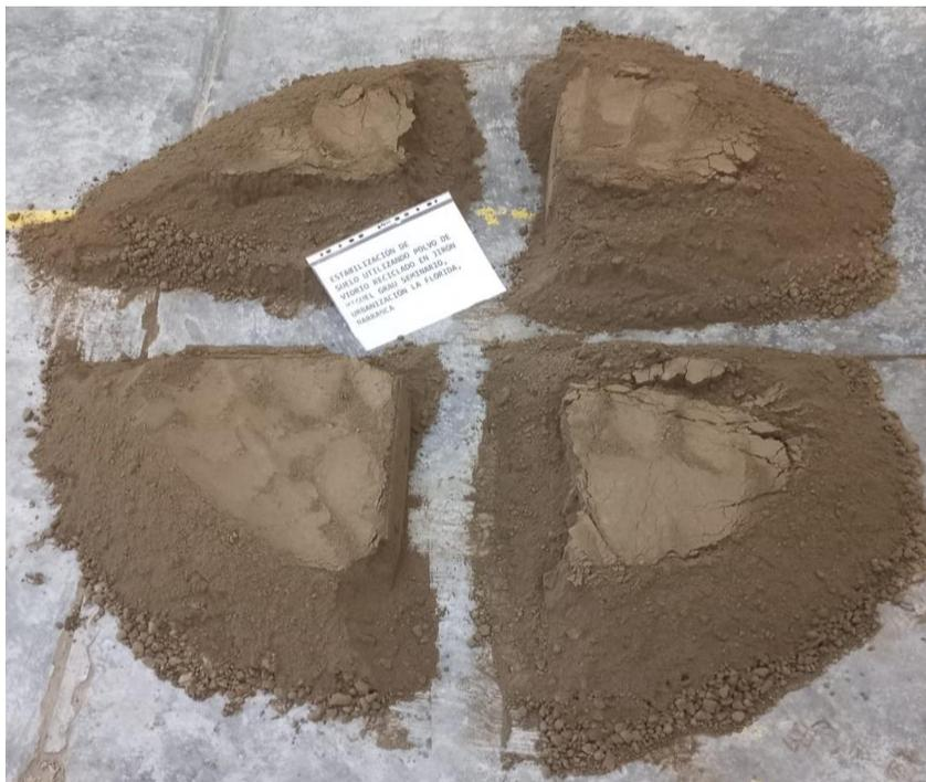
Figura 170, Se observa Cuarteo manual de la muestra de suelo para prueba de CBR
