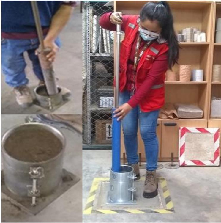
Figura 181, Se observa la compactación de las cinco capas para prueba CBR
