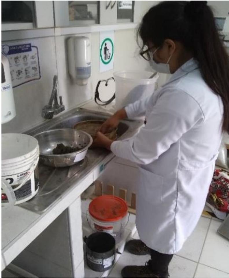
Figura 123., Se observa el lavado de las muestras para la separación de los finos
