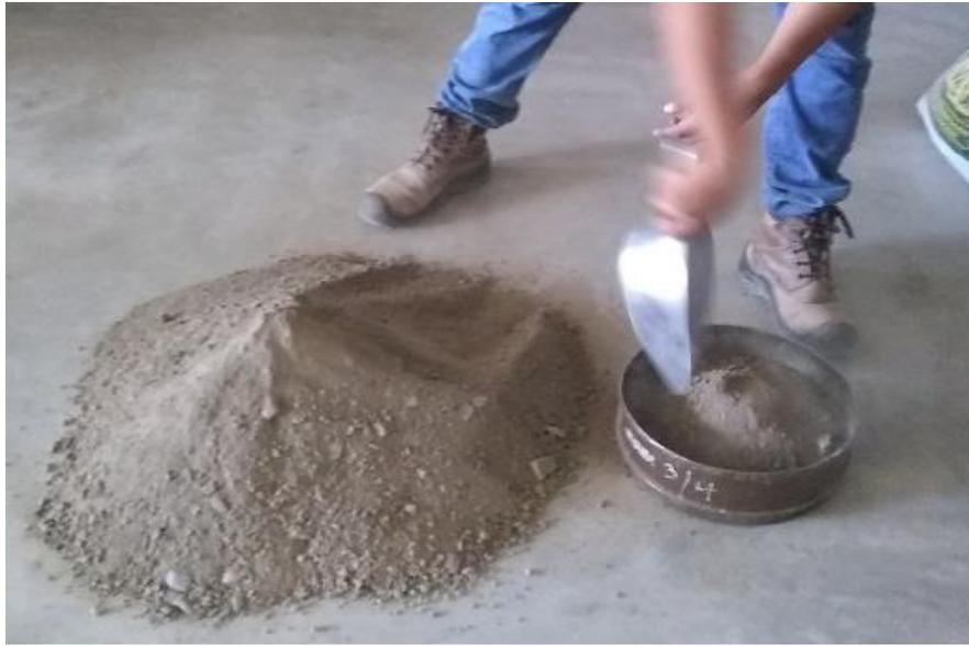
Figura 171, Se observa el tamizado de la muestra de suelo por la malla 3/4"
