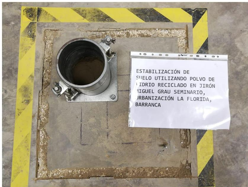
Figura 39, Plataforma rígida para el ensayo de compactación
