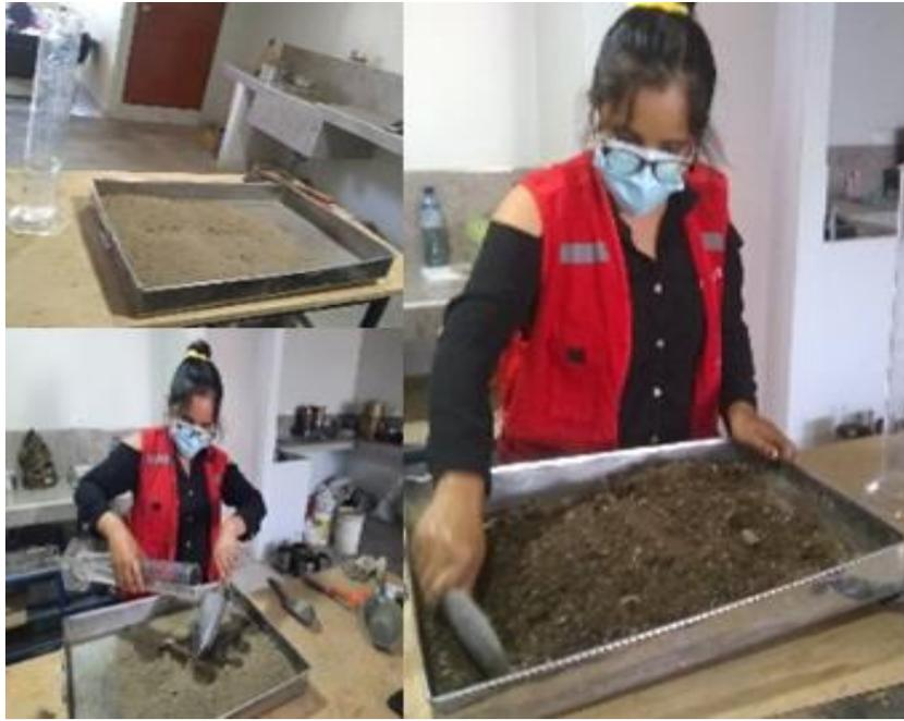
Figura 175, Se observa el humedecimiento de la muestra de CBR
