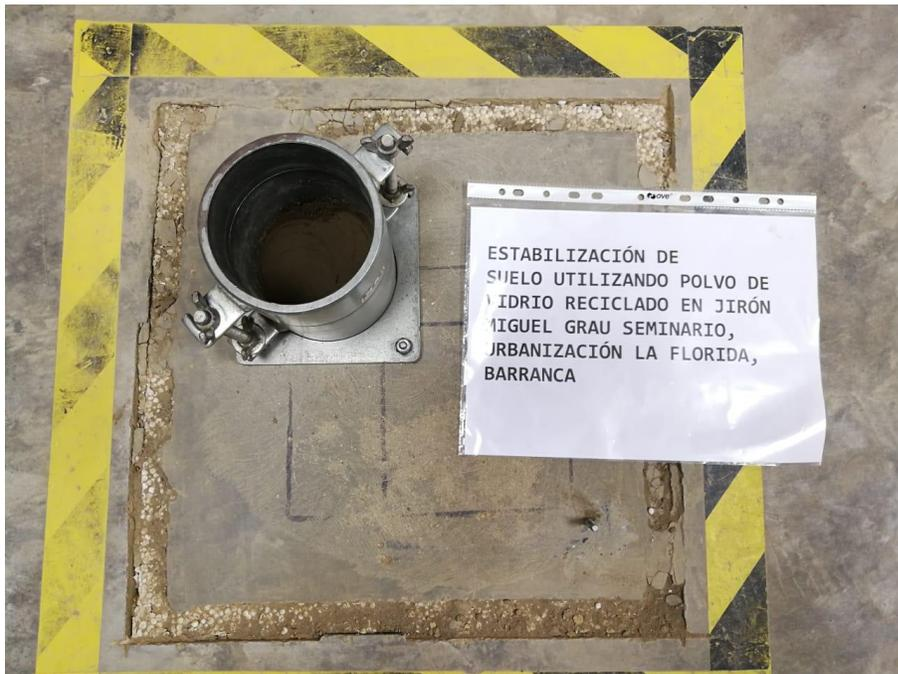
Figura 152, Se observa cuando se colocó a su plataforma rígida para iniciar la compactación
