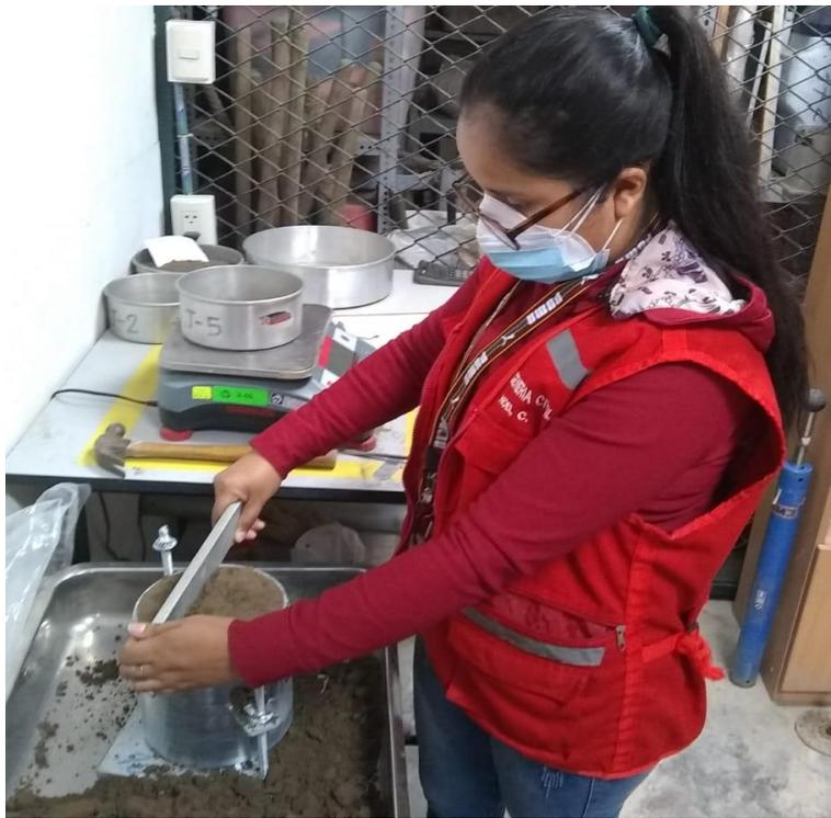
Figura 182, Se observa el enrasamiento y llenado de material en los huecos del molde CBR
