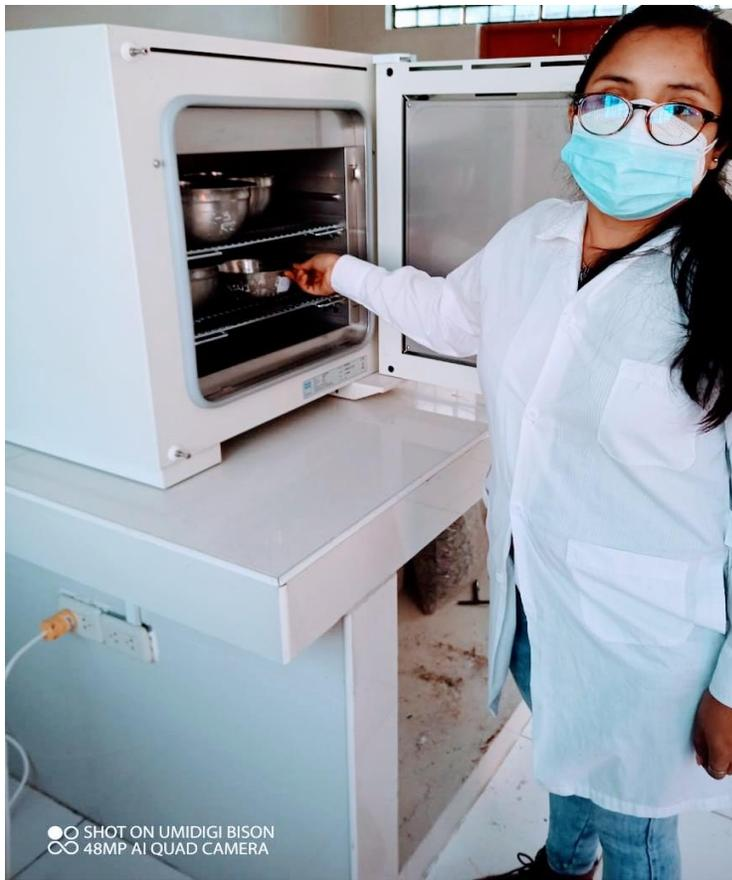
Figura 188, Se observa la colocación de las porciones mayores a 100g en el horno por 24 horas
