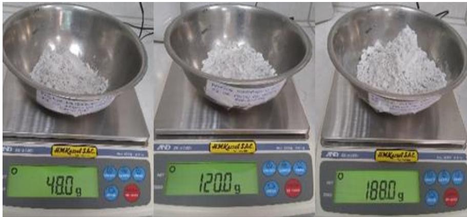
Figura 165, Se observa el peso del aditivo estabilizador con porcentajes de 2, 5 y 8% respecto al peso seco de la muestra
