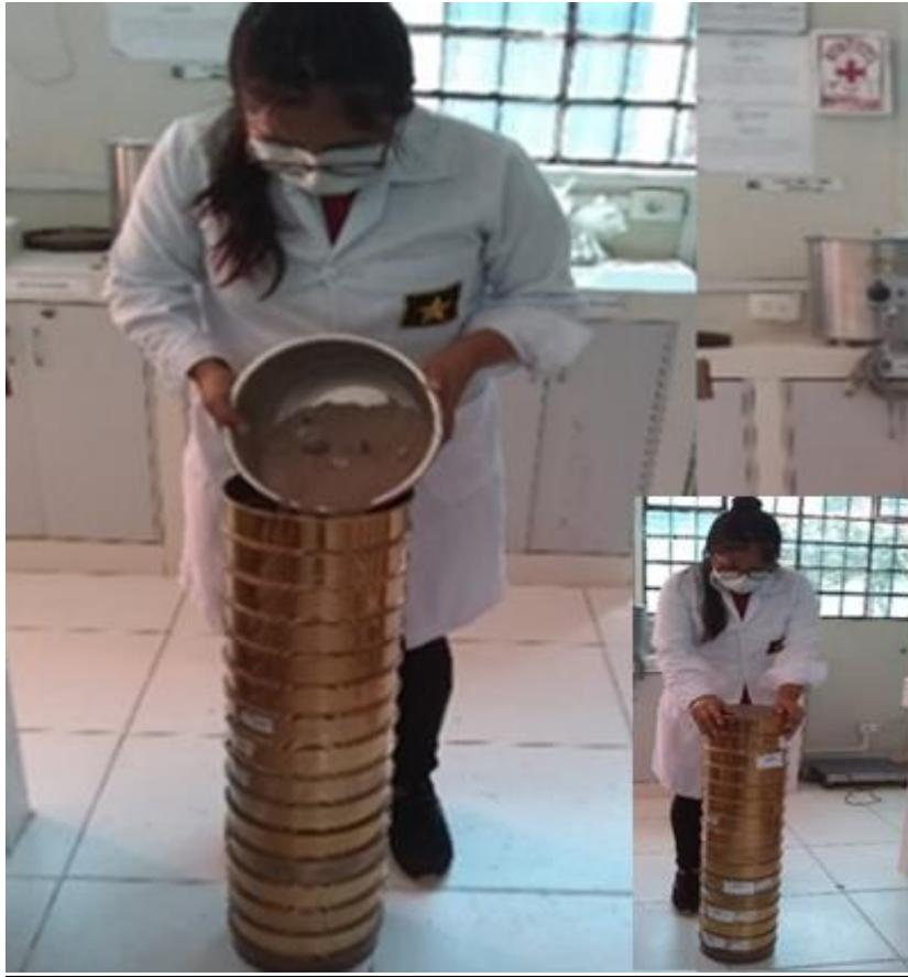
Figura 125, Se observa el tamizado manual de la fracción gruesa
