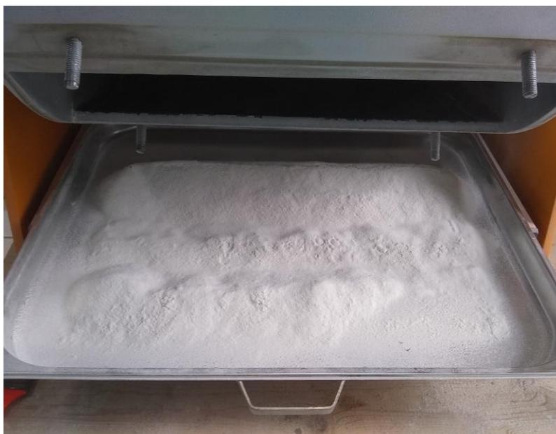
Figura 90, Se observa el vidrio molido después de ciertas revoluciones en la máquina de los Ángeles
