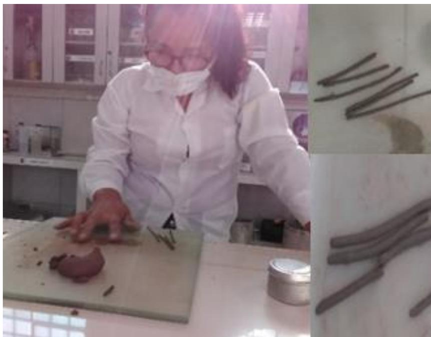
Figura 38, Formación de cilindros de suelo de diámetro de 3.2 mm
