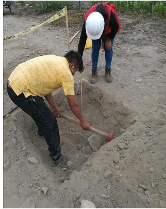
Figura 94, Se observa los 0.20 m de suelo orgánico con mezcla de plástico entre otros materiales
