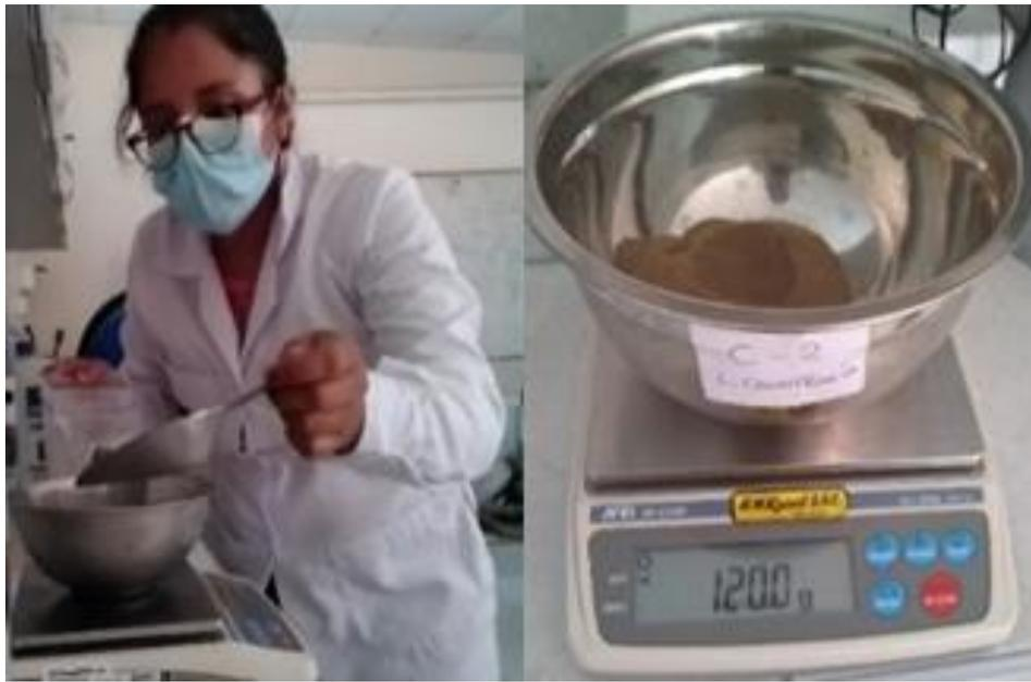
Figura 130, Se observa el material de 120 gramos para limite liquido
