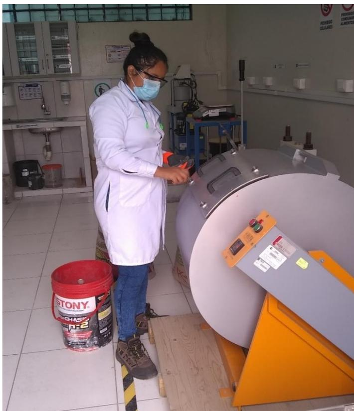
Figura 89, Se observa el cierre de la máquina de los Ángeles para iniciar el molido del vidrio
