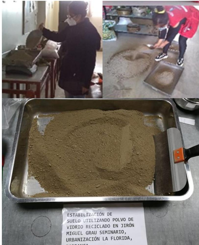
Figura 44, Peso de la muestra de suelo para prueba de CBR
