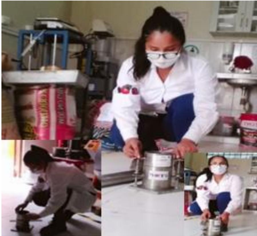
Figura 151, Se observa cuando se hizo el ensamblaje del molde a su plato base y collarin
