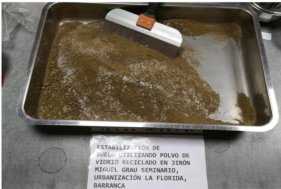
Figura 168, Se observa la mezcla de ambos materiales en el recipiente – proctor modificado
