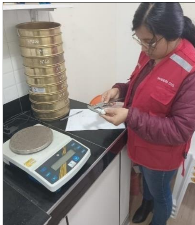
Figura 3 Medición de la canica para el ensayo de viscosidad.
