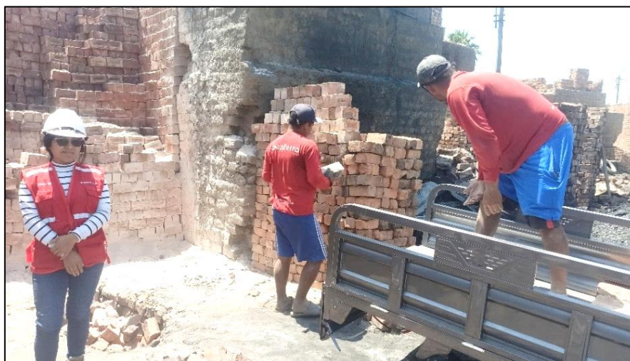
Enumeración, cocción y retiro de los ladrillos del horno.
