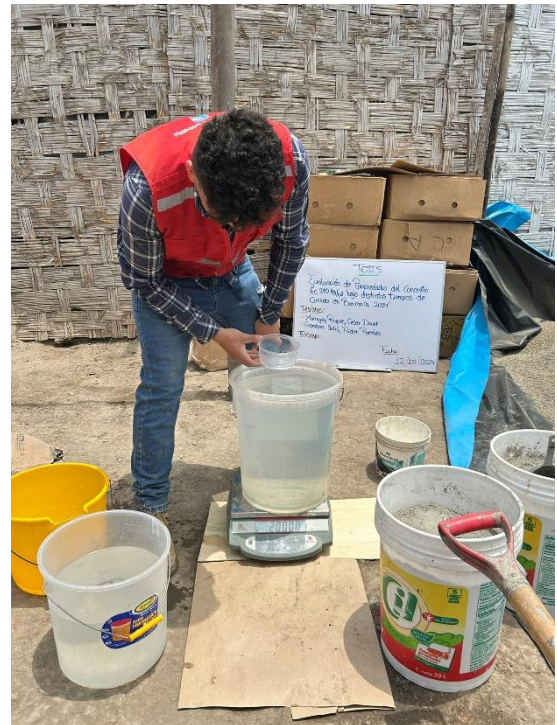
Peso del agua según diseño de mezcla
