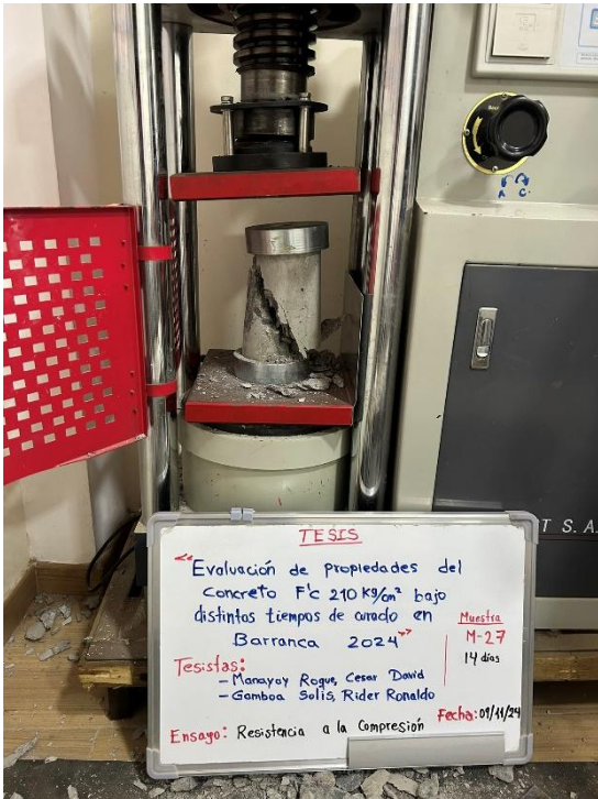
Verificación del tipo de falla del espécimen del concreto cilíndrico.
