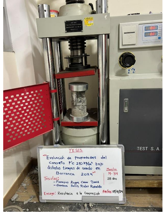
Verificación del tipo de falla del espécimen del concreto cilíndrico.
