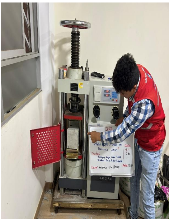
Ensayo a flexión del concreto.
