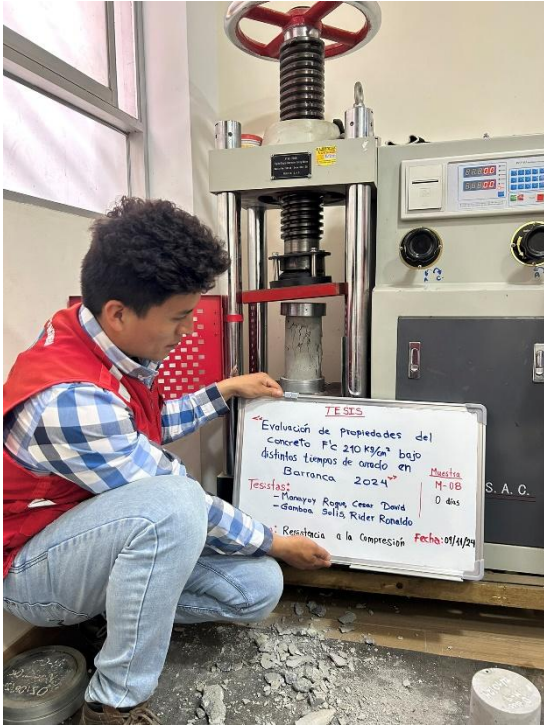
Ensayo a la compresión del concreto.
