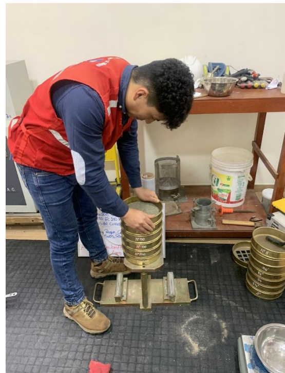
Tamizado del agregado fino para el Análisis Granulométrico.
