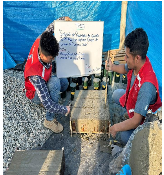
Colocado del concreto en los moldes prismáticos.
