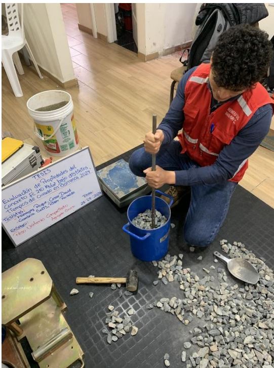
Ensayo de peso unitario compactado del agregado grueso.
