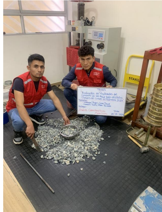
Ensayo de Análisis granulométrico del agregado grueso.
