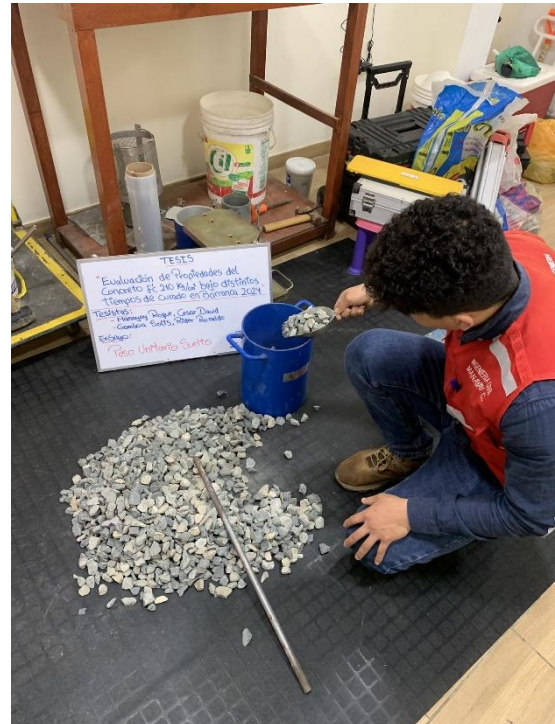
Ensayo de peso unitario suelto del agregado grueso.
