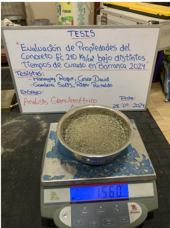
Ensayo de Análisis granulométrico del agregado Fino.
