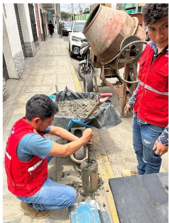
Ensayo del peso unitario del concreto.
