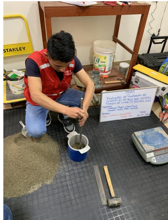
Ensayo de peso unitario compactado del agregado fino.
