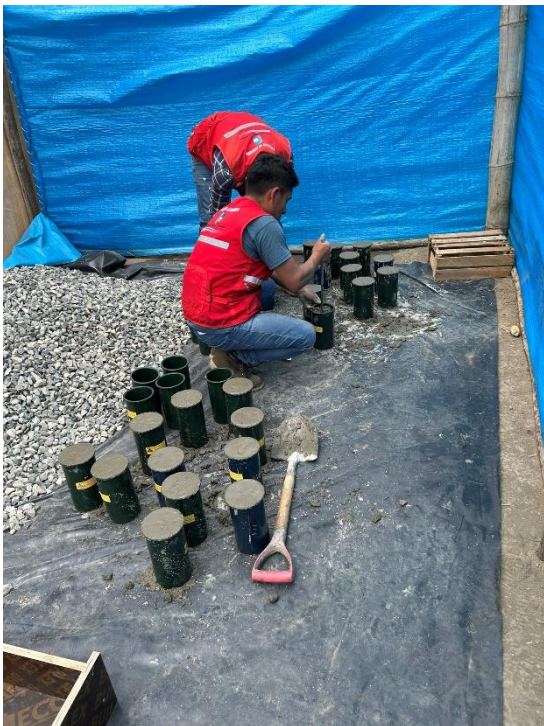
Colocado del concreto en los moldes cilíndricos.
