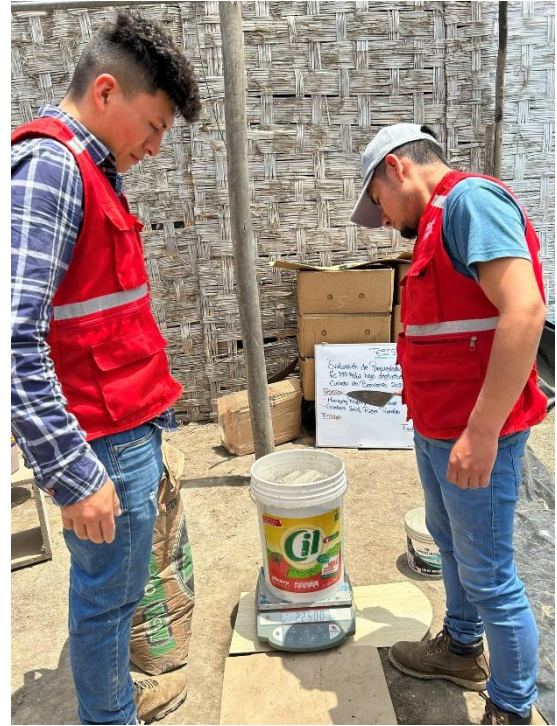
Peso del cemento según diseño de mezcla
