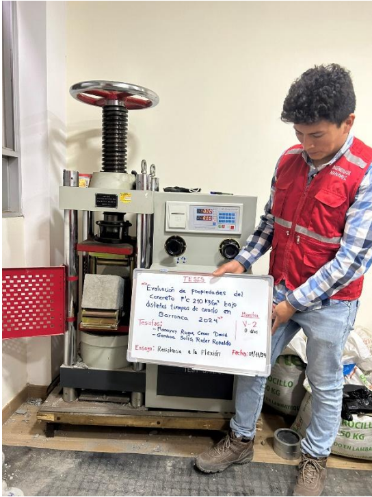
Ensayo a flexión del concreto.
