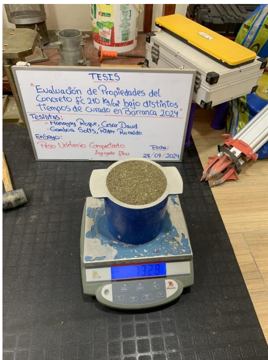
Ensayo de peso unitario compactado del agregado fino.
