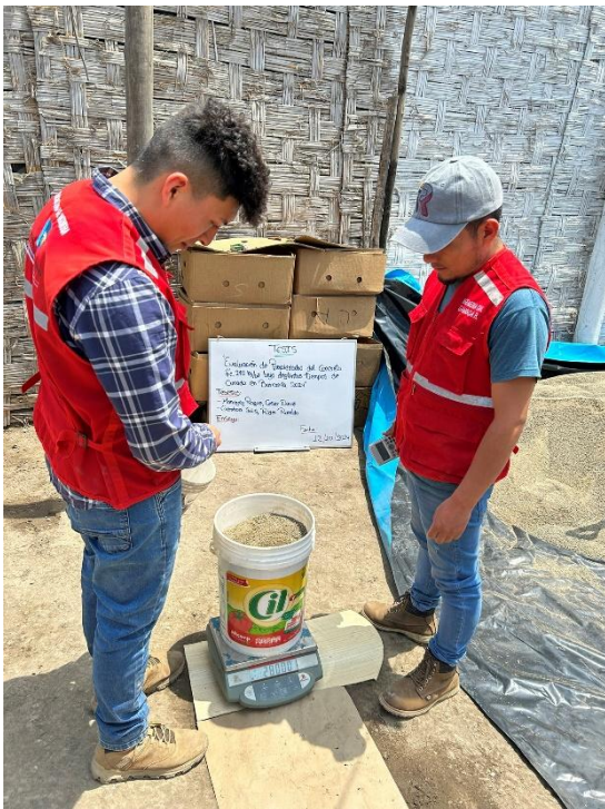
Peso del agregado fino según diseño de mezcla
