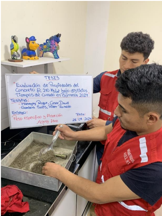
Ensayo de Peso Específico y Absorción del agregado fino.
