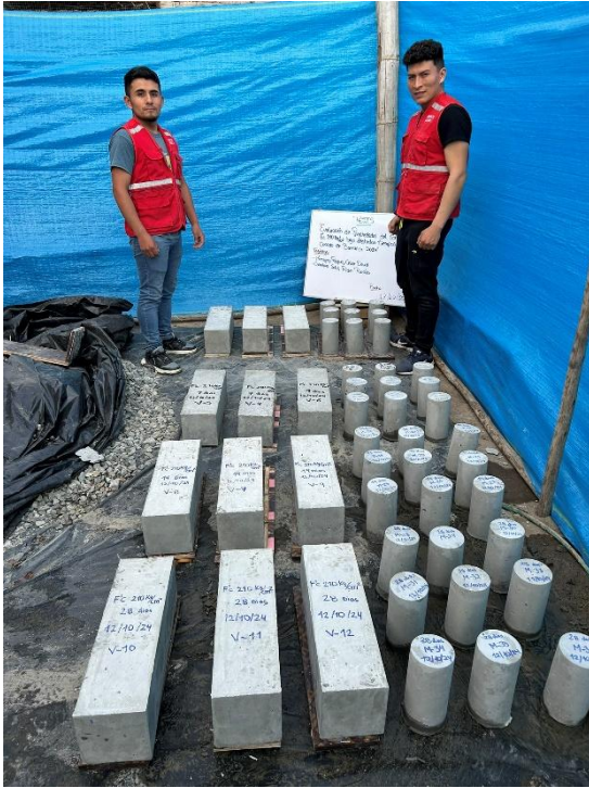
Desenfrado de los especímenes del concreto cilíndricas y prismáticas
