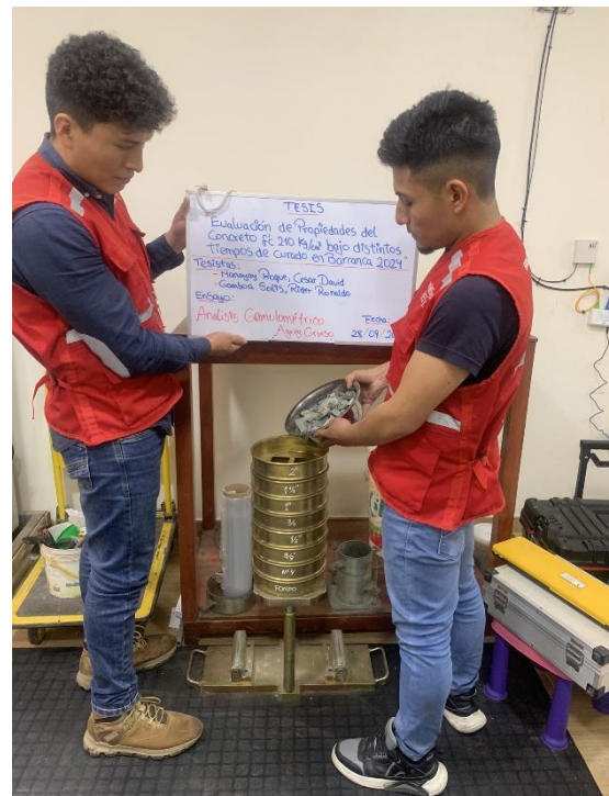
Ensayo de Análisis granulométrico del agregado grueso.
