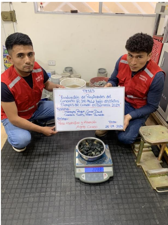
Ensayo de Peso Específico y Absorción del agregado grueso.
