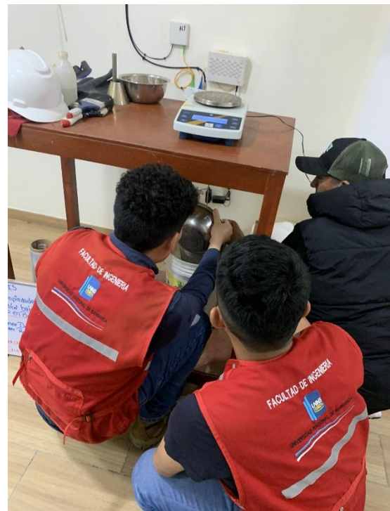
Ensayo de Peso Específico y Absorción del agregado grueso.
