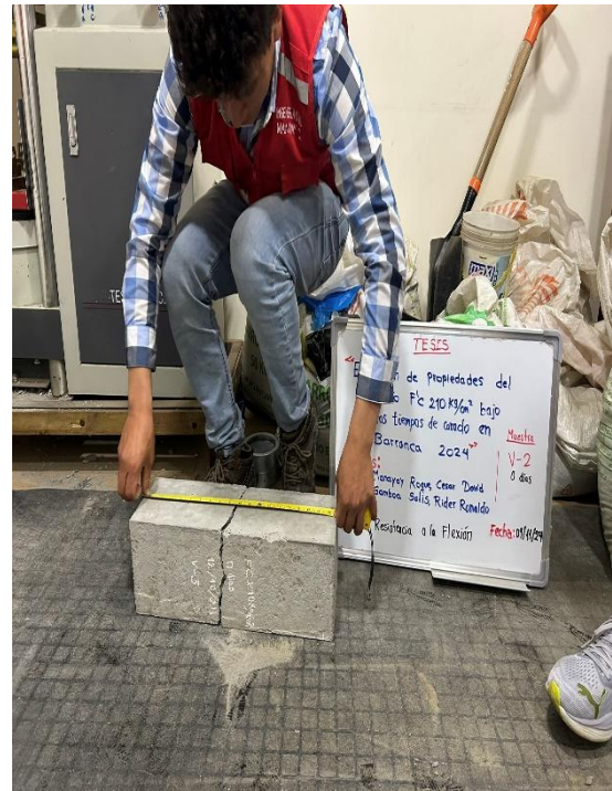
Medición de la longitud de falla de la viga.
