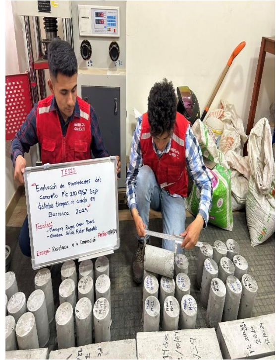
Medición de la altura de las probetas
