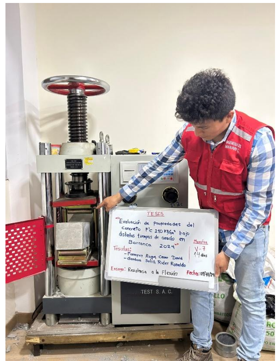
Ensayo a flexión del concreto.
