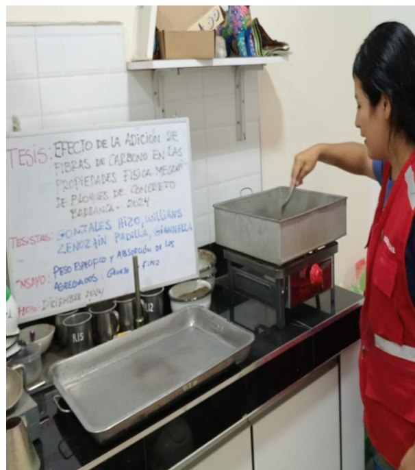
Foto 08: Secado del agregado fino para el ensayo de peso específico y absorción.
