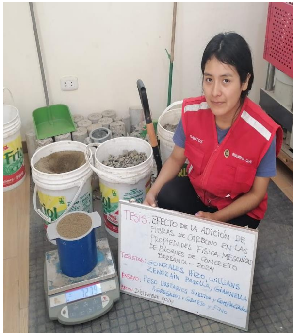
Foto 02: Ensayo de peso unitario compactado en agregado fino.
