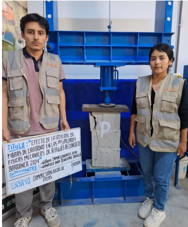
Foto 35: Ensayo a compresión axial en pilas con 0.0 % de FDC.
