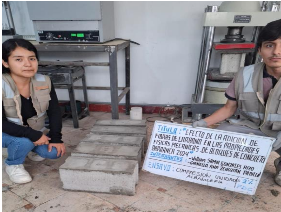
Foto 30: Unidades de bloques de concreto con morteros en los extremos para recibir carga uniforme.
