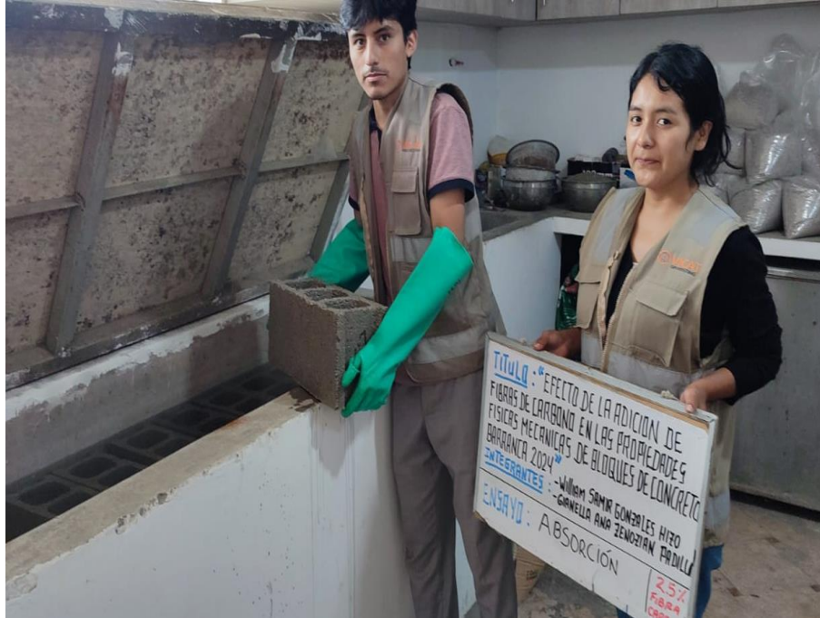
Foto 27: Ensayo de absorción en bloque de concreto con adición de 2.5% de FDC.
