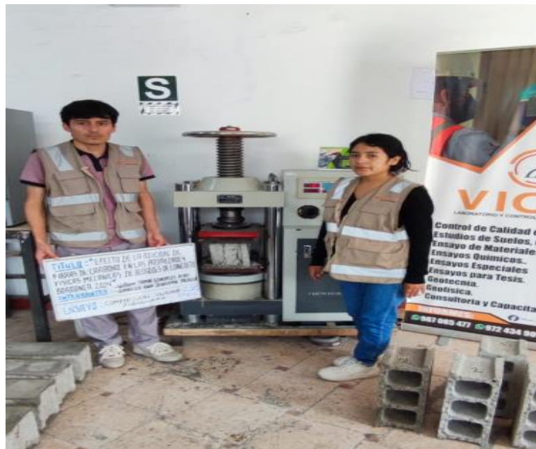
Foto 31: Ensayo a compresión en unidades de albañilería con 2.50% de FDC.
