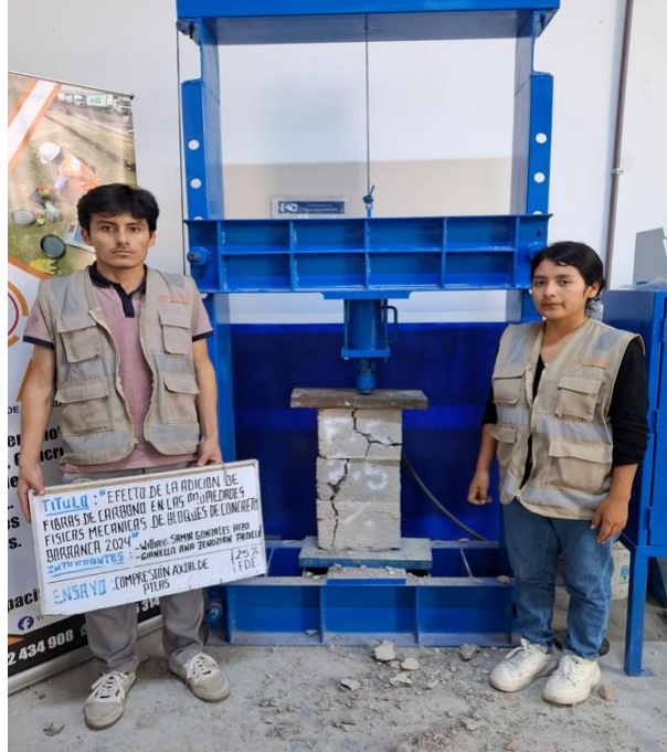
Foto 37: Ensayo a compresión axial en pilas con 1.5 % de FDC.
