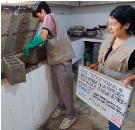
Colocación de bloques al agua por 24 horas.
