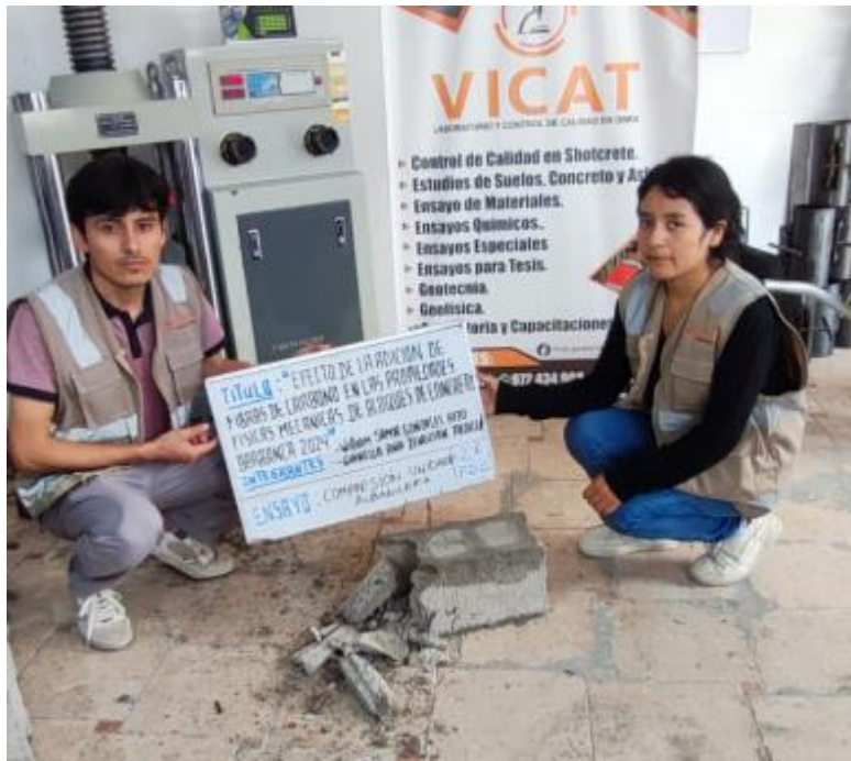
Foto 33: Ensayo a compresión en unidades de albañilería con 2.0% de FDC.
