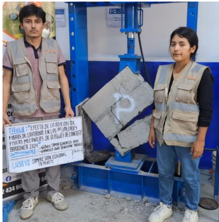
Foto 38: Ensayo a compresión diagonal de murete con 0 % de FDC.
