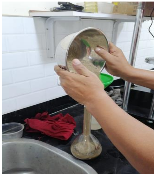
Foto 10: Colocación del agregado fino en el picnómetro para el ensayo de peso específico y absorción.
