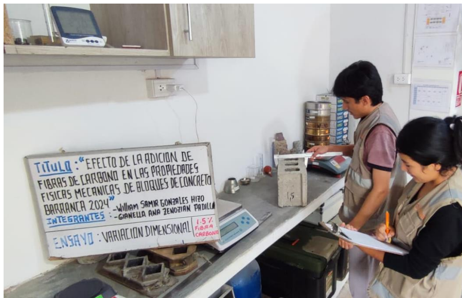
Foto 26: Ensayo de Variación dimensional de bloque de concreto con adición de 1.5% de FDC.
