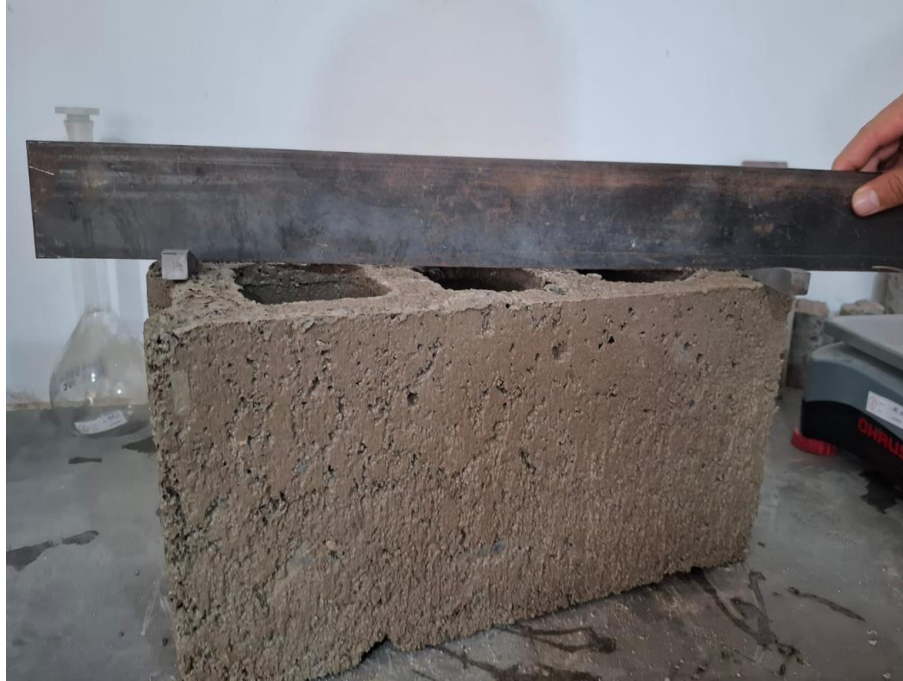
Foto 29: Medición de alabeo con la ayuda de una regla y cuña.
