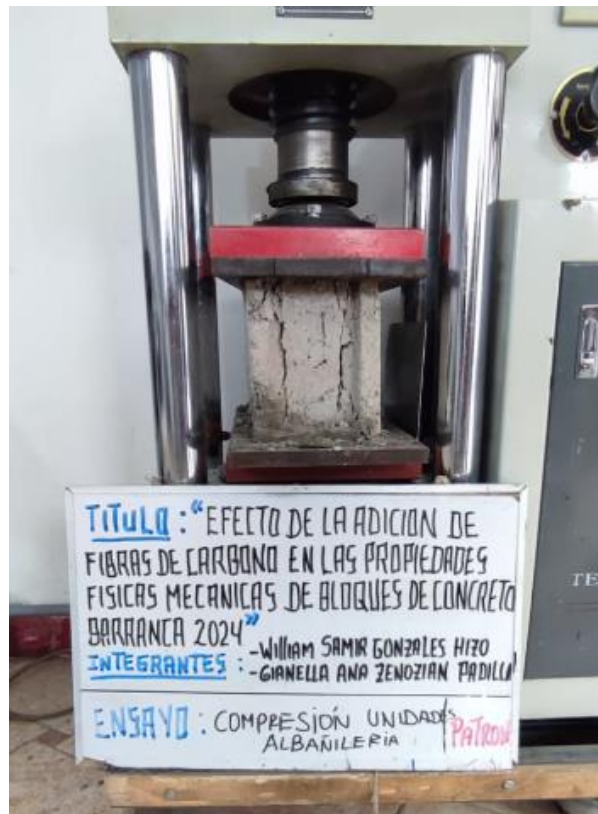
Foto 34: Ensayo a compresión en unidades de albañilería con 0% de FDC.
