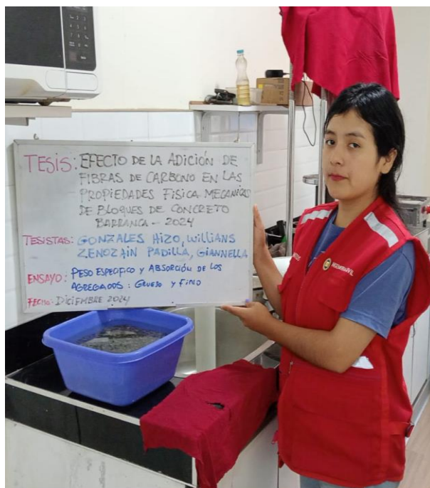
Foto 05: Agregado grueso sumergido por 24 horas para el ensayo de peso específico y absorción.
