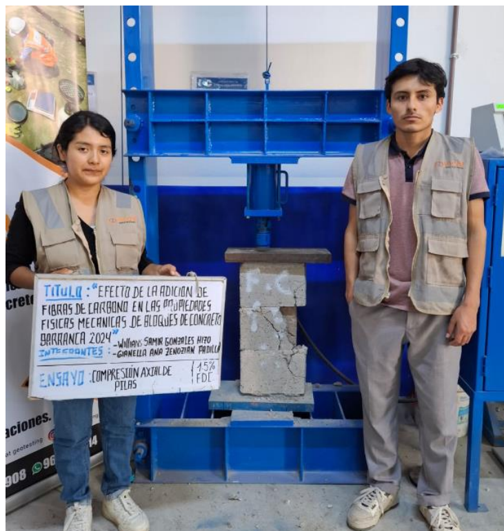
Foto 36: Ensayo a compresión axial en pilas con 1.5 % de FDC.
