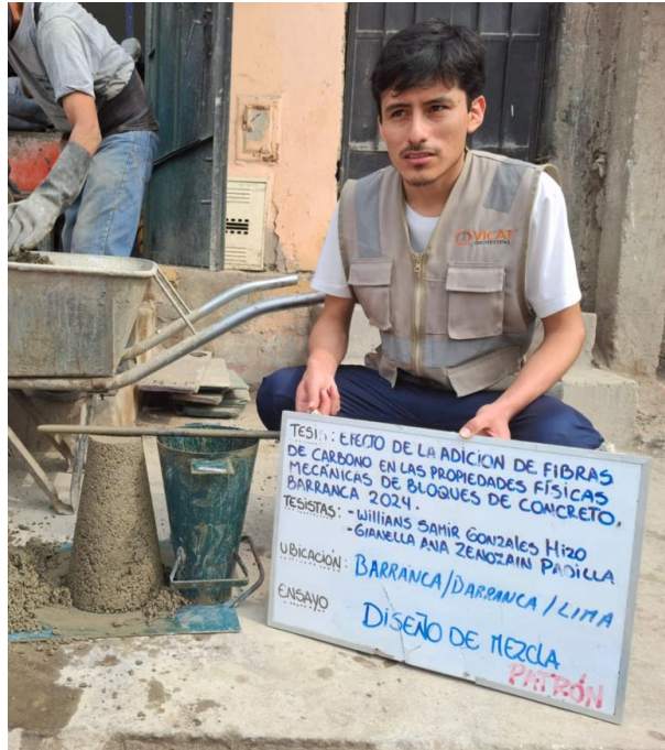
Foto 19: Ensayo de asentamiento del diseño de mezcla patrón.
