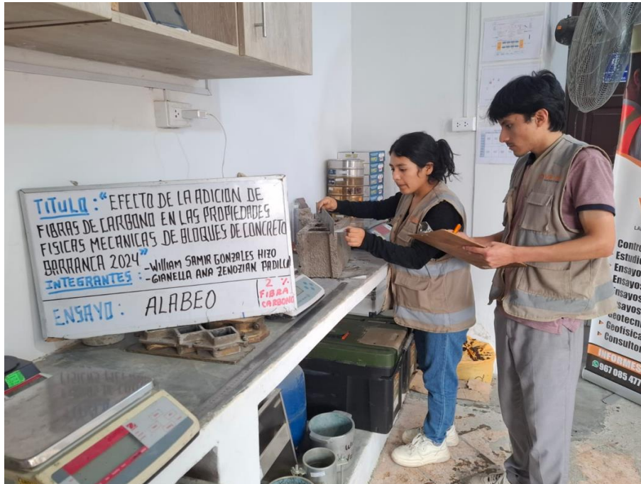
Foto 28: Ensayo de alabeo en bloques de concreto con adición de 2% de FDC.
