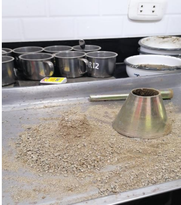
Foto 09: Determinación del estado superficialmente seco del agregado fino para el ensayo de peso específico y absorción.
