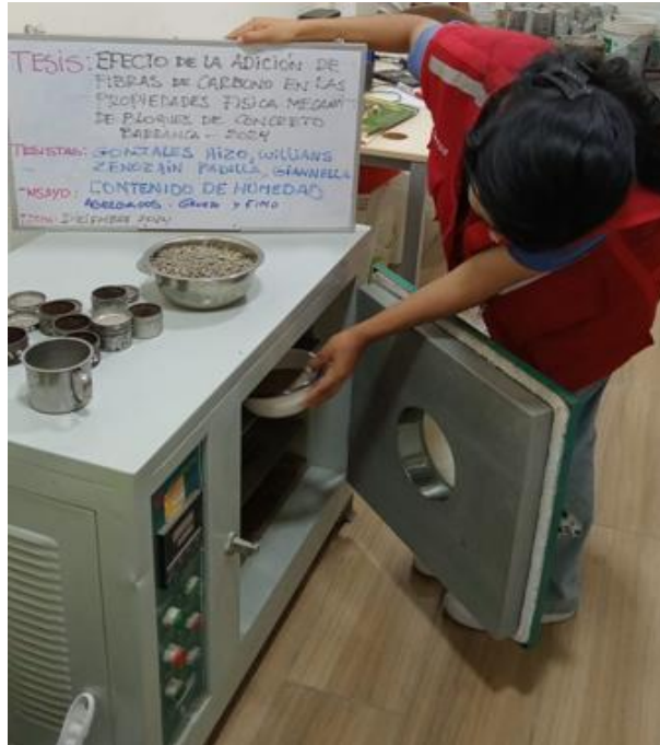
Foto 11: Secado del agregado fino y grueso para el ensayo de contenido de humedad.
