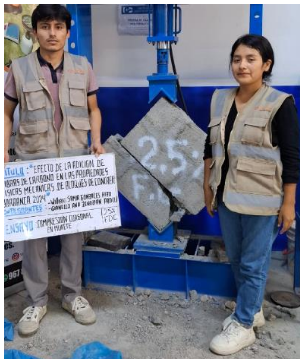
Foto 40: Ensayo a compresión diagonal en muretes con 1.5% de FDC.
