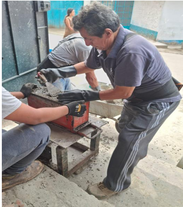
Foto 17: Vibrado de la mezcla de concreto.
