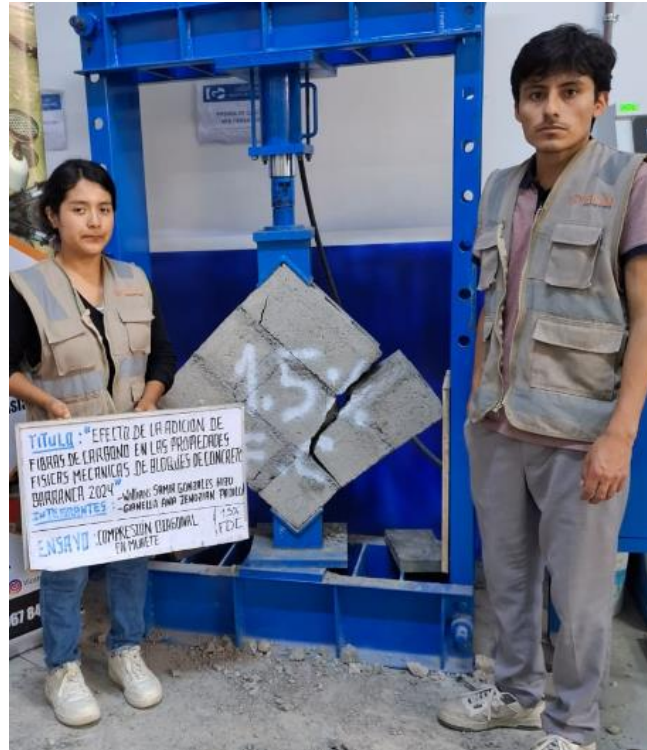
Foto 39: Ensayo a compresión diagonal de murete con 1.5 % de FDC.
