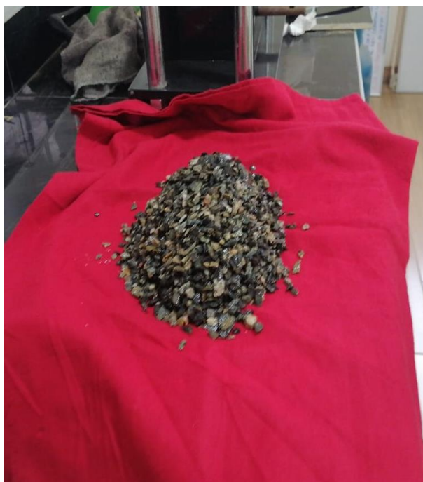
Foto 06: Secado superficialmente en aire de agregado grueso.
