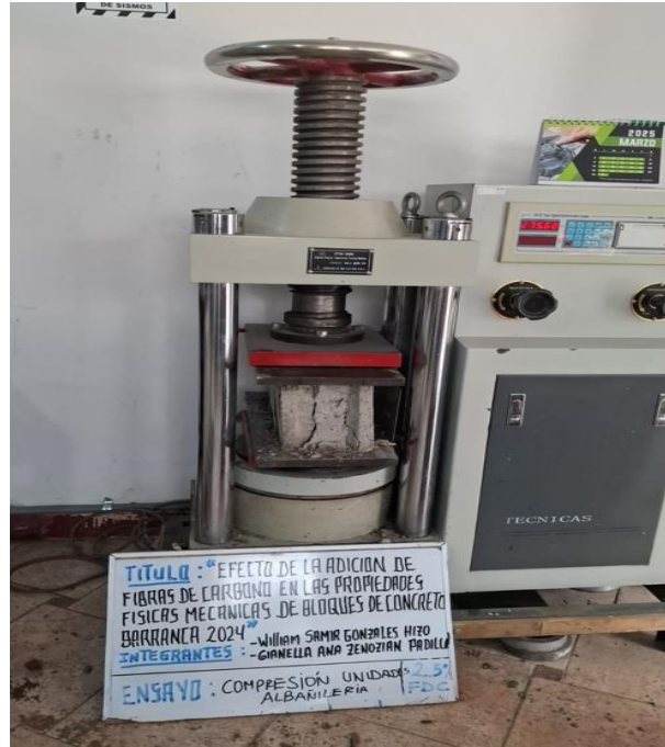
Foto 31: Ensayo a compresión en unidades de albañilería con 2.50% de FDC.
