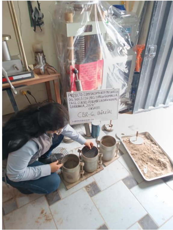
Foto 15: Colocación de geomalla biaxial para ensayo CBR.
