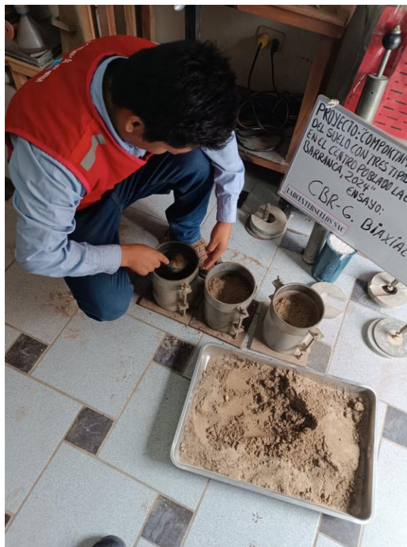
Foto 16: Colocación de capas para ensayo CBR con geomalla biaxial.
