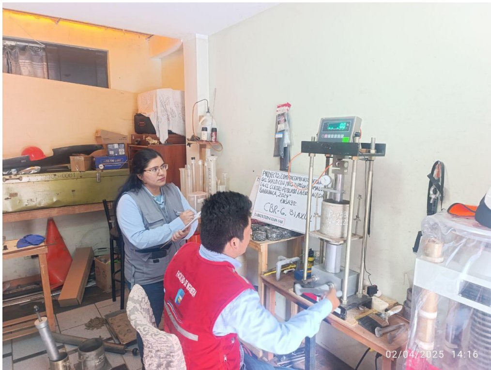
Foto 20: Determinación de penetración en CBR.
