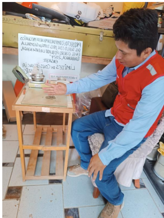
Foto 12: Ensayo de límites de consistencia (Límite plástico).
