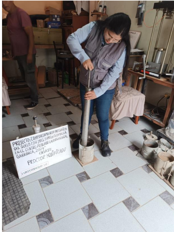
Foto 13: Ensayo de proctor modificado.
