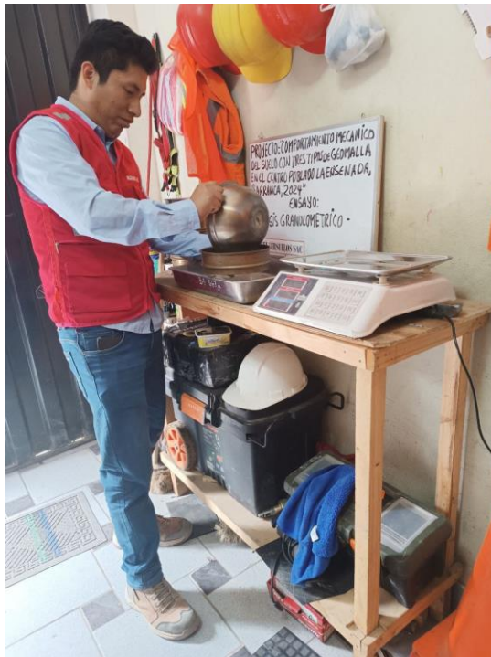
Foto 10: Peso de material de suelo tamizado.
