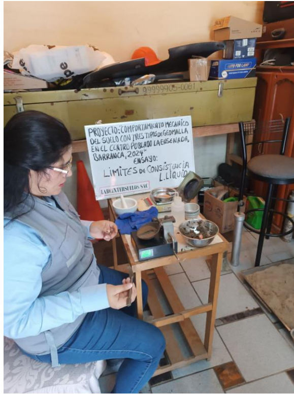
Foto 11: Ensayo de límites de consistencia (Límite líquido).
