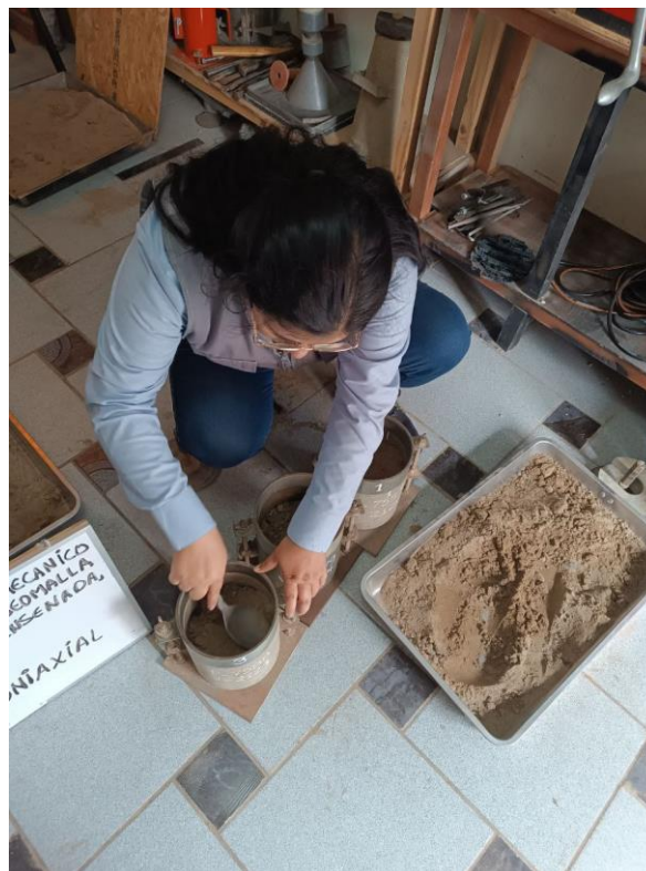
Foto 14: Colocación de capas para ensayo CBR con geomalla uniaxial.
