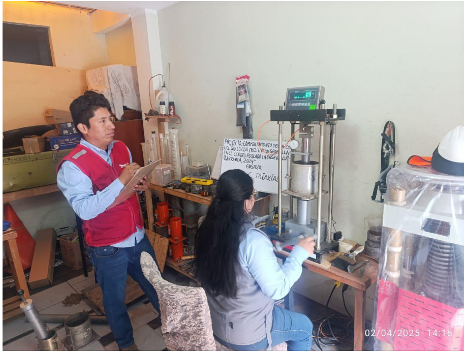
Foto 19: Ensayo CBR realizado por investigadores.
