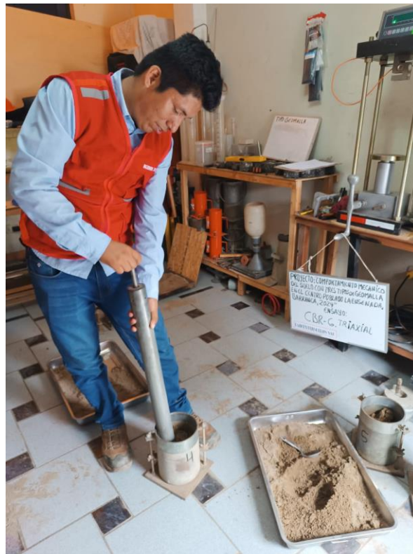
Foto 18: Colocación de capas para ensayo CBR con geomalla triaxial.
