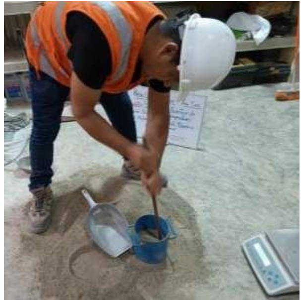
Foto 14: Determinación del peso unitario.
