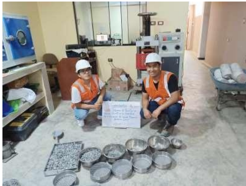
Foto 6: Pesos retenidos del agregado grueso para cada número de tamiz.
