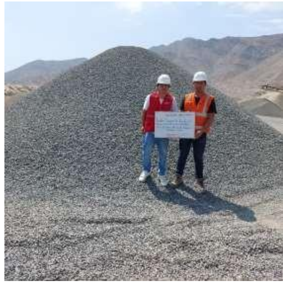
Foto 2: Agregado grueso empleado para el proyecto de investigación
