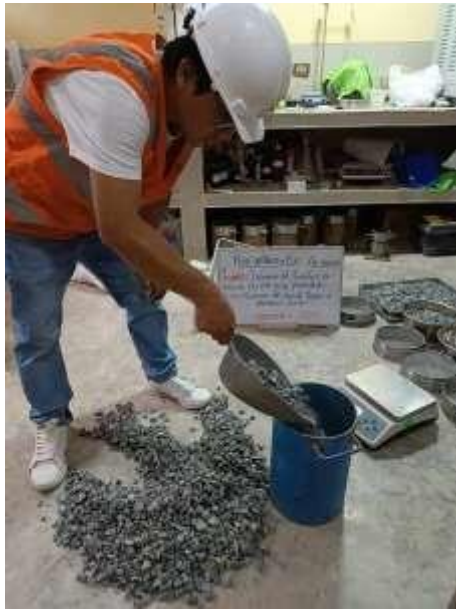
Foto 10: Determinación del peso unitario suelto del agregado grueso.
