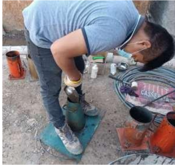
Foto 30: Se realizó el ensayo de asentamiento.
