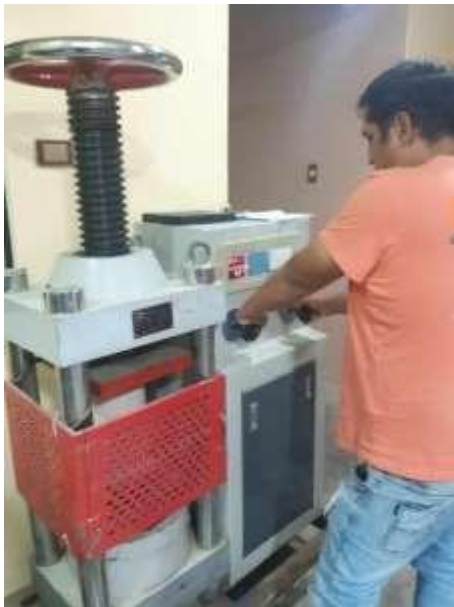
Foto 39: Ensayo de compresión de concreto patrón.
