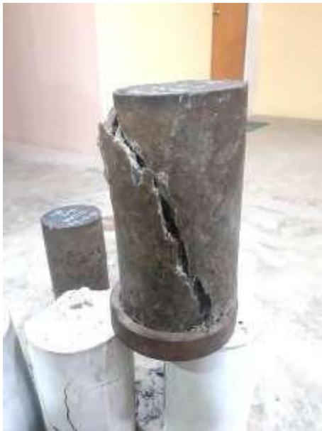
Foto 43: Tipo de falla del concreto polimérico.
