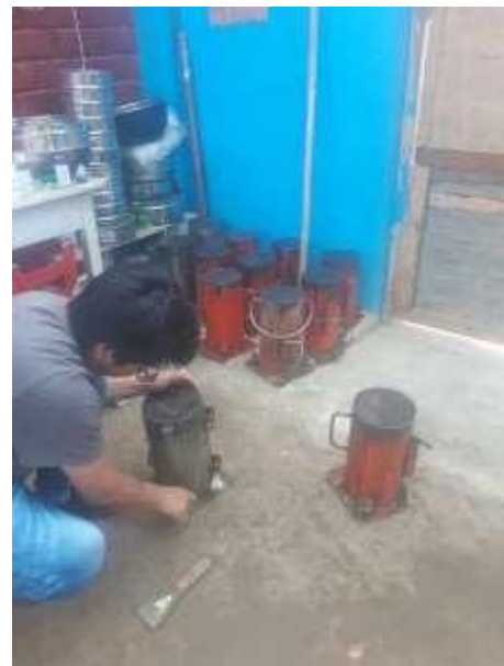
Foto 36: Desencofrado de probetas de concreto polimérico.
