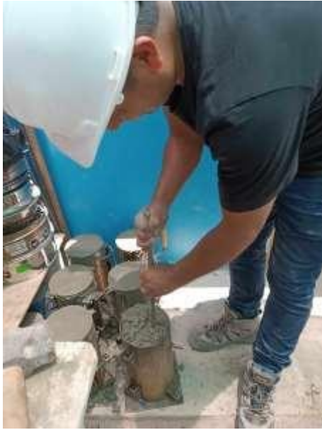
Foto 25: Se realizó el varillado 25 veces y se golpeó con comba para eliminar el aire atrapado.
