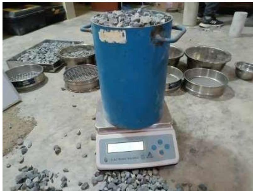
Foto 12: Peso unitario compactado del agregado grueso.
