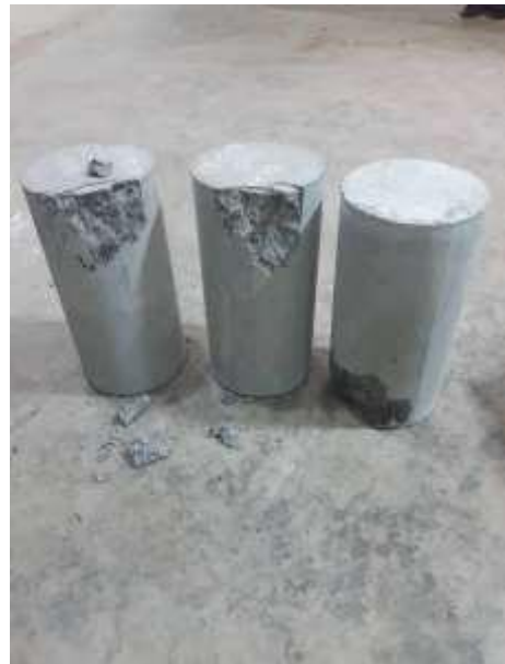
Foto 40: Se aprecia los distintos tipos de falla.
