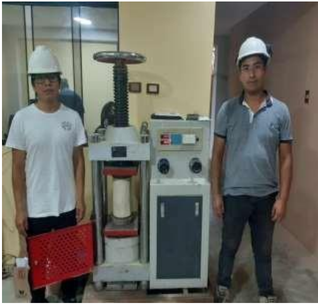
Foto 37: Prensa utilizada para los ensayos de compresión.
