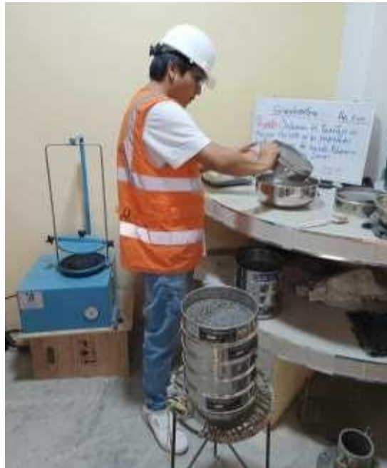
Foto 9: Pesos retenidos del agregado fino para cada número de tamiz.
