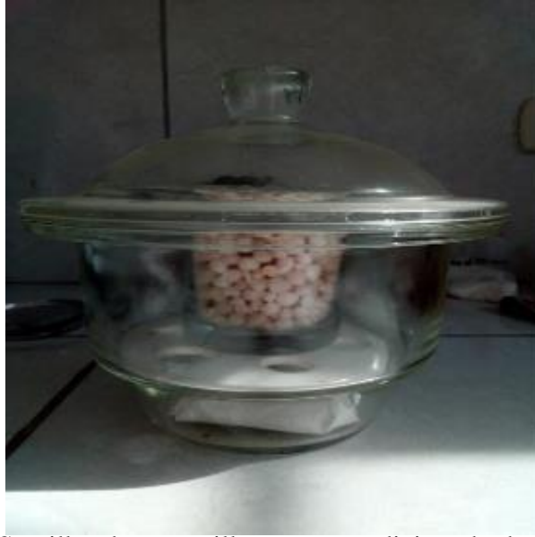
Figura 11 Semillas descascarillas para acondicionado de la humedad.
