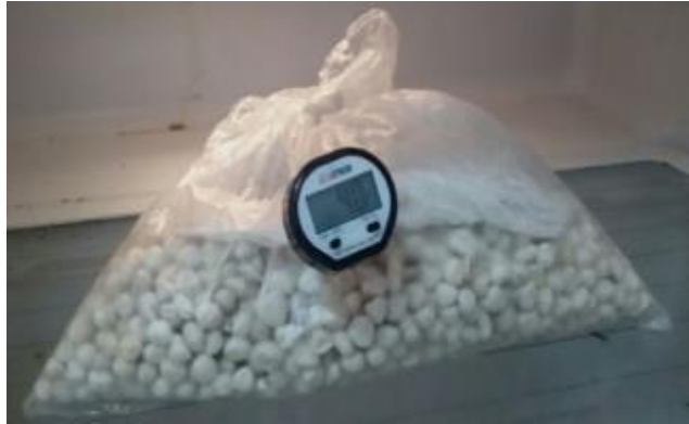
Figura 12 Acondicionamiento de humedad de las semillas de Moringa.
