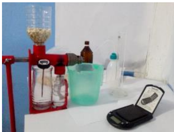
Figura 13 Prensado de las semillas de Moringa.
