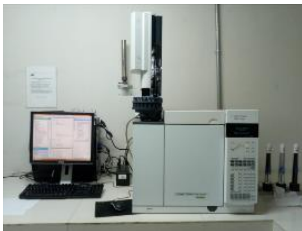
Figura 21 Cromatógrafo de gases para la determinación de ácidos grasos.
