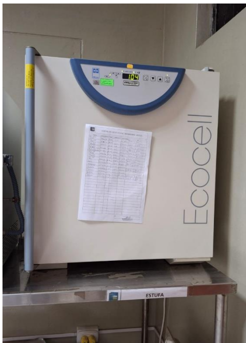
Foto 10: Ensayo para determinar el contenido de humedad de los agregados.
