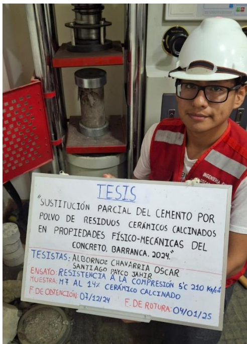
Foto 81: Ensayo de resistencia a la compresión a 28 días en la probeta M-7 de concreto con 14% de RCC.
