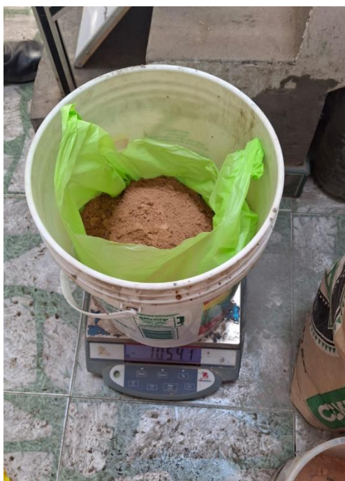
Foto 70: Pesaje de cemento y polvo de residuos cerámicos calcinados para la elaboración del concreto 16% RCC.
