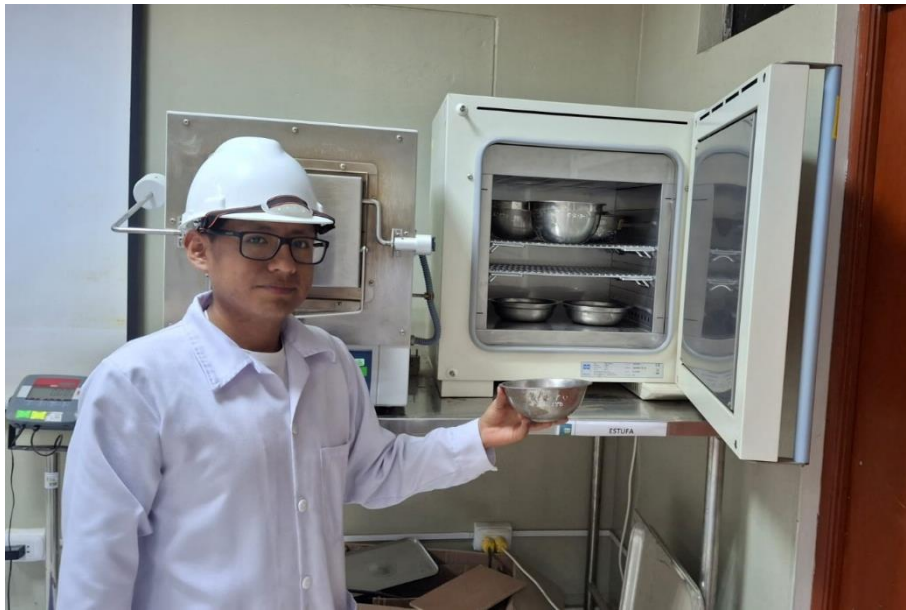
Foto 09: Ensayo para determinar el contenido de humedad de los agregados.
