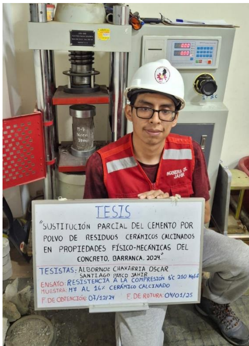
Foto 85: Ensayo de resistencia a la compresión a 28 días en la probeta M-7 de concreto con 16% de RCC.
