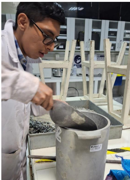
Foto 14: Ensayo para determinar el peso unitario suelto del agregado grueso.
