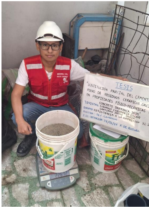
Foto 68: Pesaje del agregado fino para la elaboración del concreto 16% RCC.
