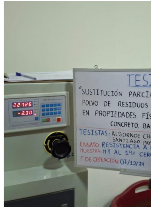
Foto 82: Resultado de la resistencia a la compresión de la probeta M-7 de concreto con 14% de RCC.
