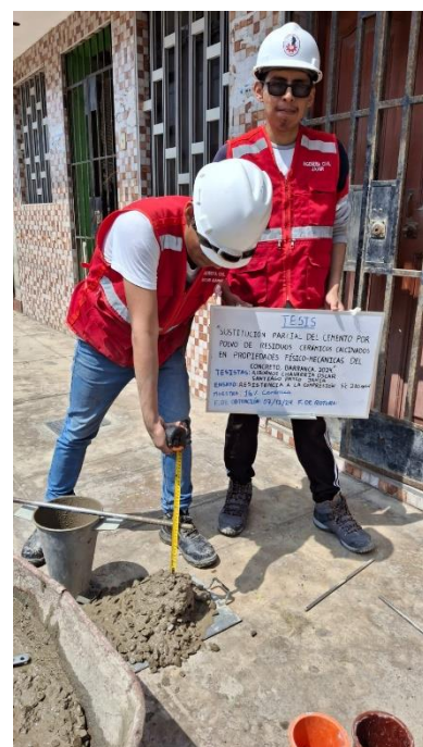
Foto 71: Medición del asentamiento del concreto con el cono de Abrams del concreto 16% RCC.
