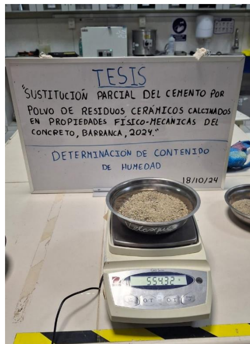
Foto 11: Ensayo para determinar el contenido de humedad de los agregados.
