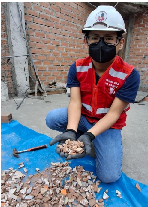
Foto 49: Resultado final de trituración de los residuos cerámicos.
