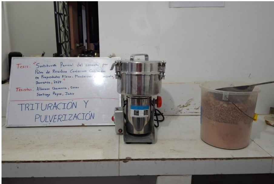
Foto 54: Trituración y pulverización de los residuos cerámicos.
