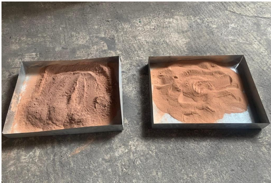
Foto 59: Comparativa del polvo de residuos cerámicos, antes y después de ser sometido a los equipos de trituración y calcinación.
