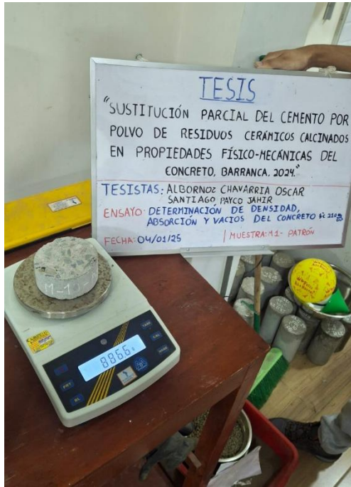
Foto 90: Ensayo para determinar la densidad del concreto endurecido.
