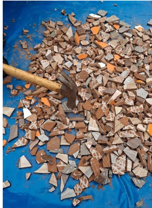
Foto 48: Proceso de trituración de los residuos cerámicos.
