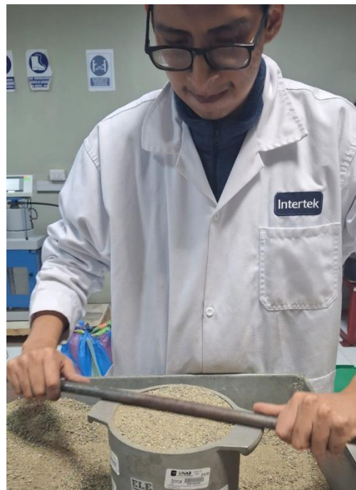
Foto 17: Ensayo para determinar el peso unitario compactado del agregado fino.
