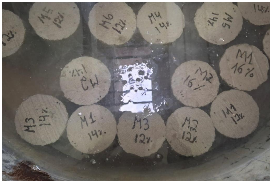
Foto 74: Proceso de curado de probetas de concreto elaboradas con sustitución parcial del cemento por polvo de residuo cerámico en proporciones del 12%, 14% y 16%
