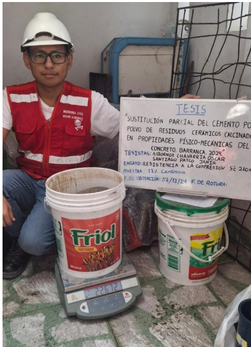
Foto 60: Pesaje del agregado fino para la elaboración del concreto 12% RCC.
