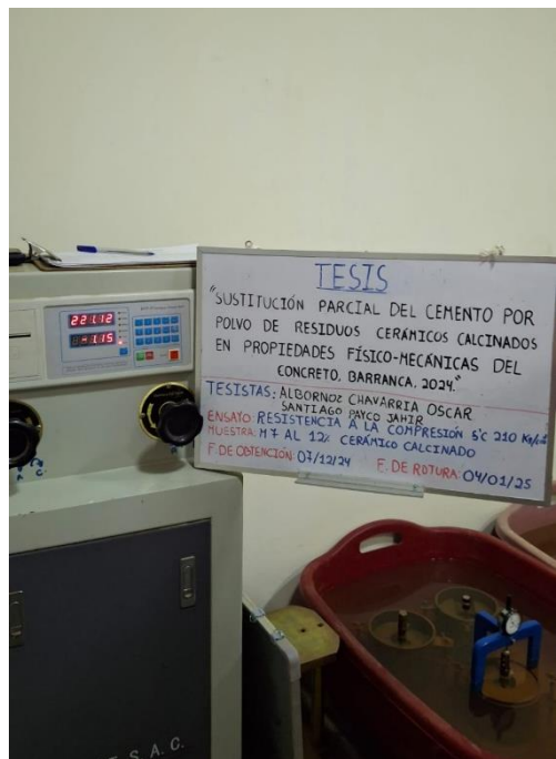
Foto 78: Resultado de compresión a 28 días en probeta M-7 de concreto con 12% de RCC.
