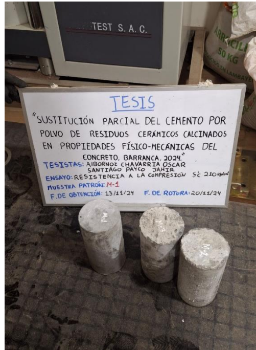
Foto 44: Ensayo de resistencia a la compresión del concreto patrón.
