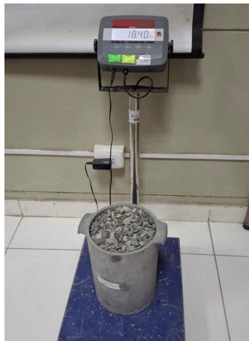
Foto 15: Ensayo para determinar el peso unitario suelto del agregado grueso.
