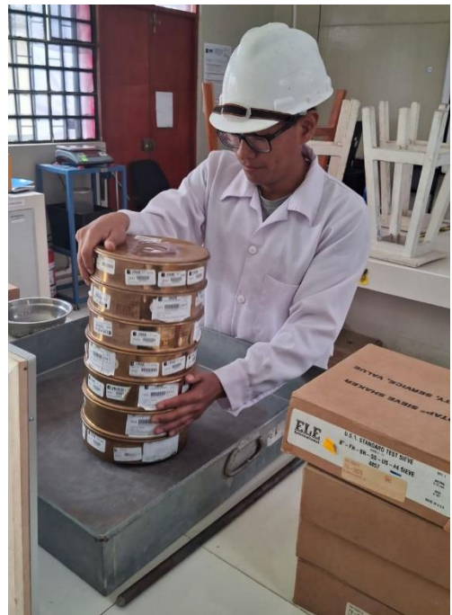
Foto 23: Ensayo para determinar el análisis granulométrico del agregado fino.
