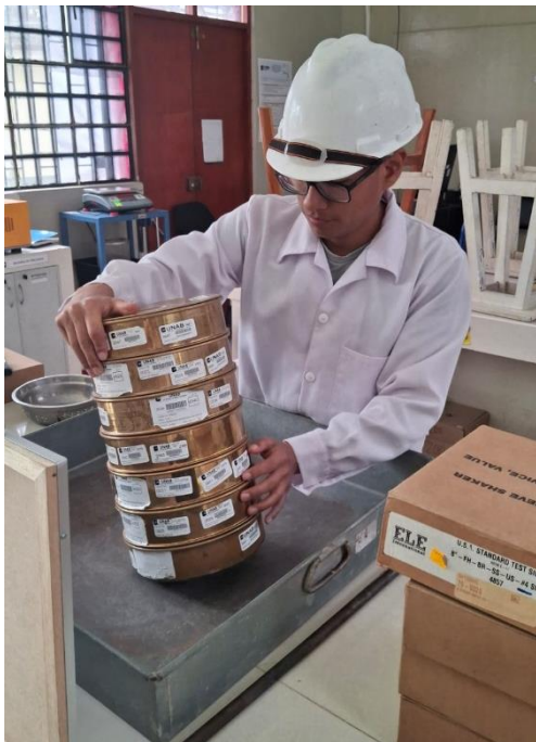
Foto 22: Ensayo para determinar el análisis granulométrico del agregado fino.
