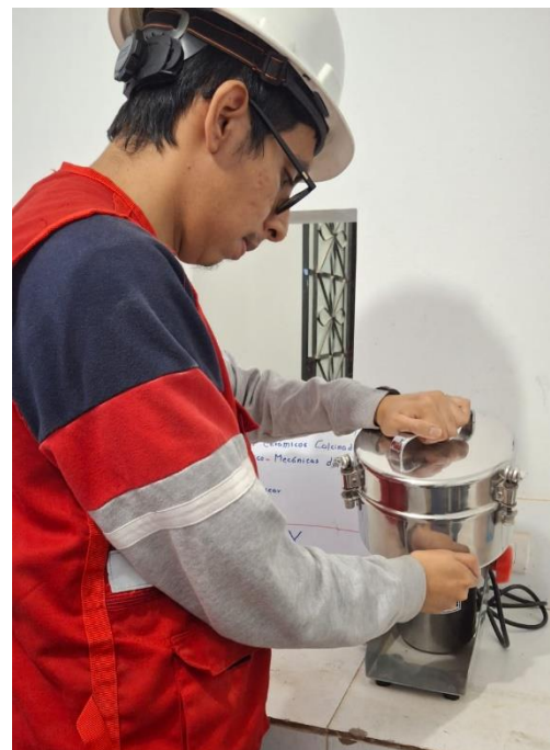
Foto 56: Trituración y pulverización de los trozos de residuos cerámicos pasantes la malla N°200.
