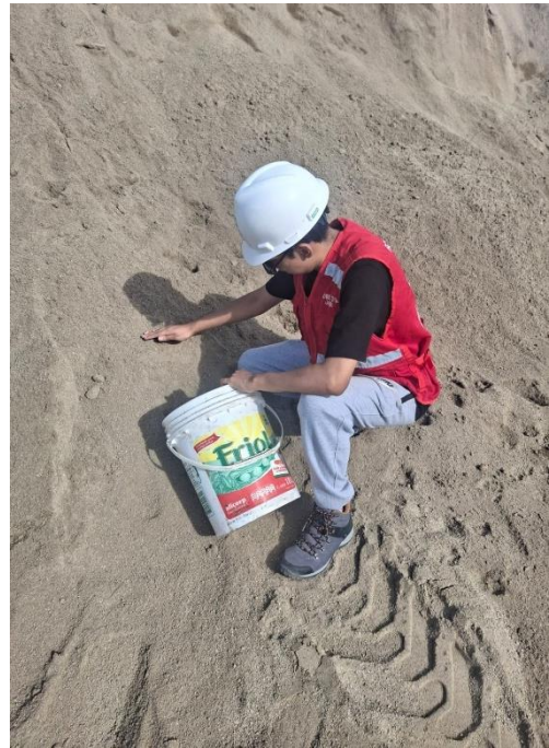
Foto 06: Extracción del agregado fino de la cantera “Rio Seco”.
