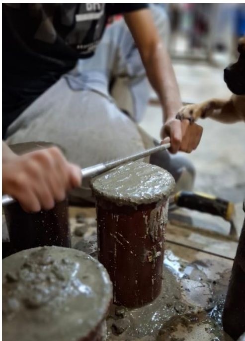
Foto 41: Vaciado y varillado del concreto patrón.
