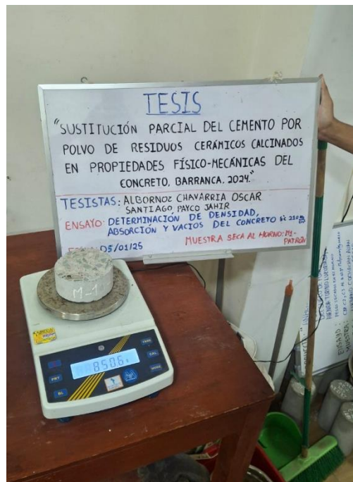
Foto 93: Muestra seca al horno.
