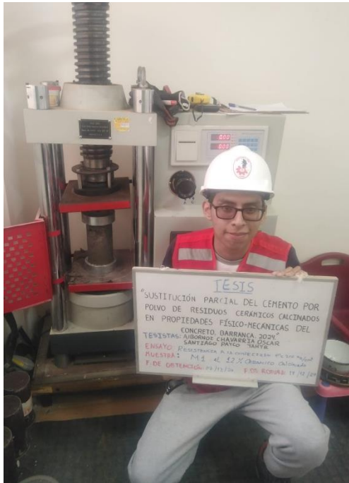
Foto 75: Ensayo de resistencia a la compresión a 7 días en la probeta M-1 de concreto con 12% de RCC.
