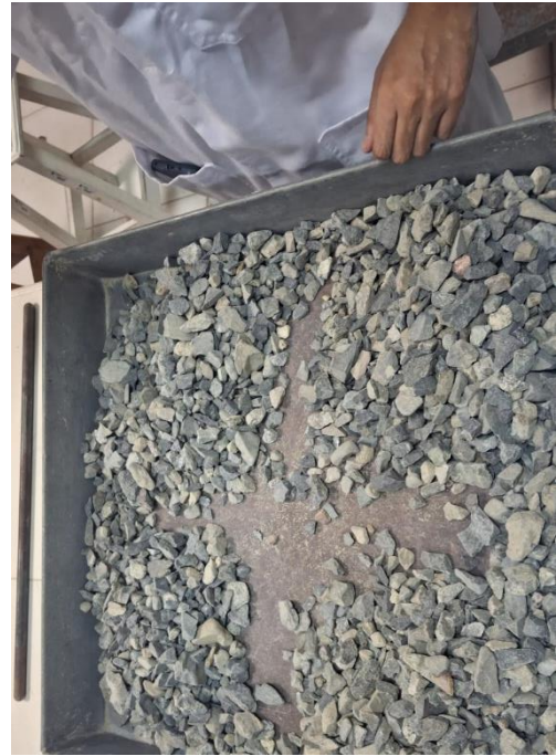
Foto 25: Ensayo para determinar el análisis granulométrico del agregado grueso.
