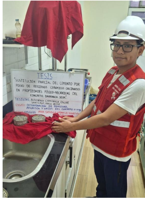
Foto 95: Muestras de concreto endurecido saturadas después de inmersión.
