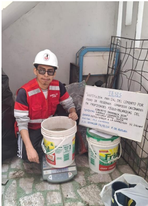
Foto 64: Pesaje del agregado fino para la elaboración del concreto 14% RCC.
