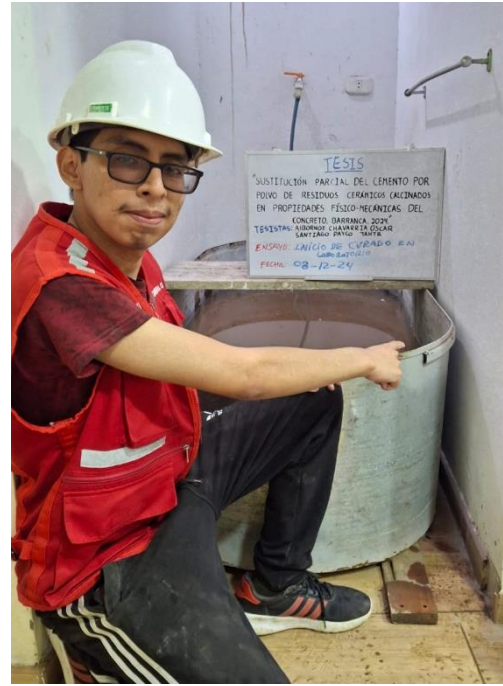
Foto 73: Curado de probetas de concreto
