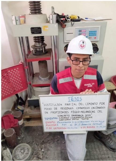
Foto 83: Ensayo de resistencia a la compresión a 7 días en la probeta M-1 de concreto con 16% de RCC.
