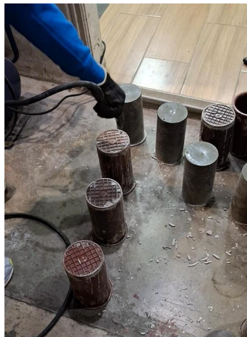
Foto 42: Desencofrado de las probetas de concreto patrón.
