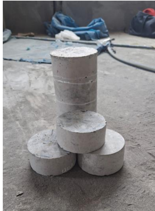
Foto 88: Se extrajo 3 muestras del concreto patrón, 12% RCC, 14% RCC y 16% RCC.
