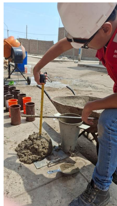
Foto 67: Medición del asentamiento del concreto con el cono de Abrams del concreto 12% RCC.
