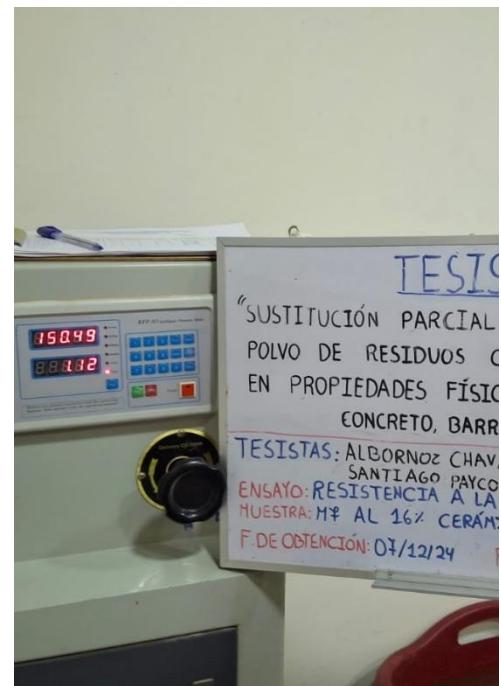
Foto 86: Resultado de la resistencia a la compresión de la probeta M-7 de concreto con 16% de RCC.
