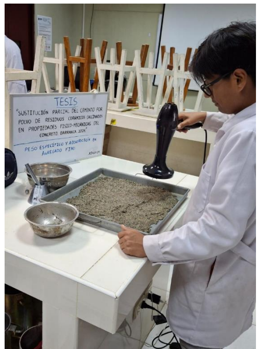
Foto 30: Secado de la muestra.
