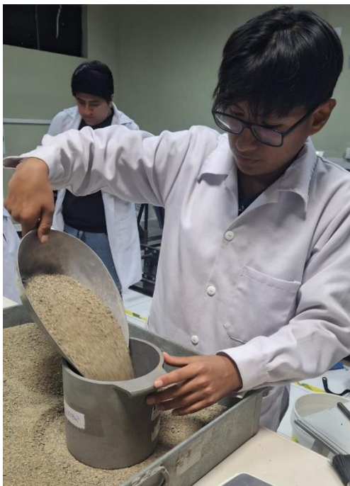
Foto 18: Ensayo para determinar el peso unitario suelto del agregado fino.
