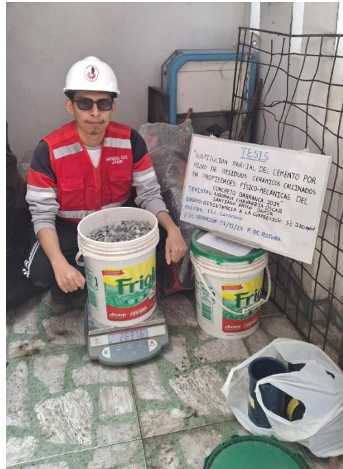
Foto 61: Pesaje del agregado grueso para la elaboración del concreto 12% RCC.
