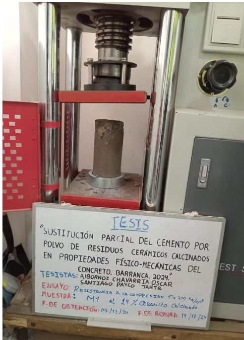
Foto 79: Ensayo de resistencia a la compresión a 7 días en la probeta M-1 de concreto con 14% de RCC.
