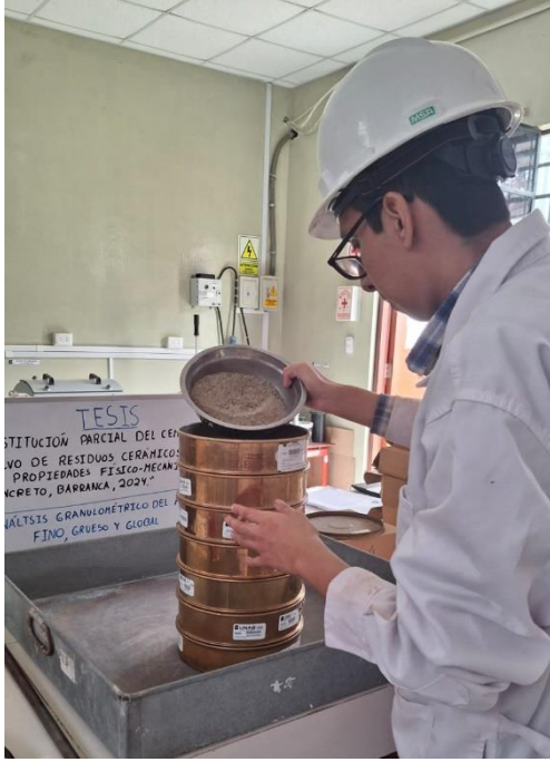
Foto 20: Ensayo para determinar el análisis granulométrico del agregado fino.
