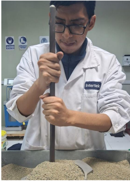
Foto16: Ensayo para determinar el peso unitario compactado del agregado fino.
