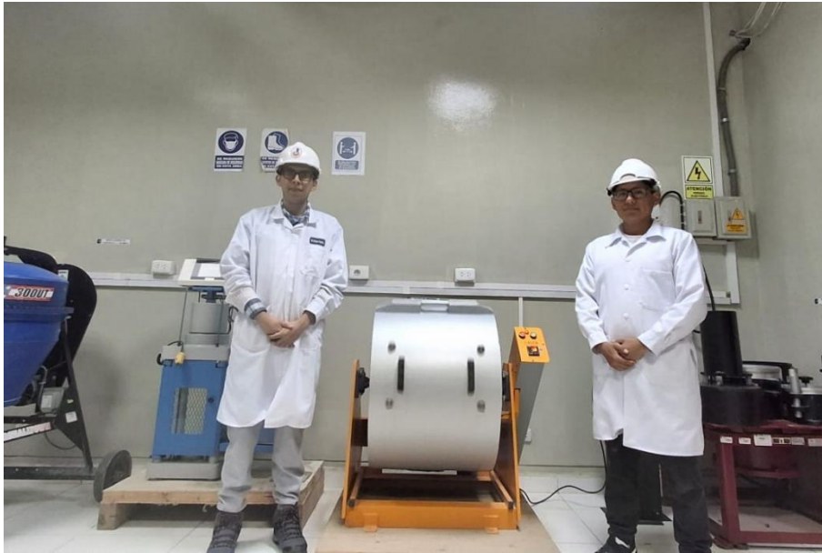
Foto 51: Utilización de la máquina de los ángeles para la obtención de trozos de residuos cerámicos.
