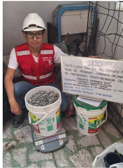
Foto 65: Pesaje del agregado grueso para la elaboración del concreto 14% RCC.
