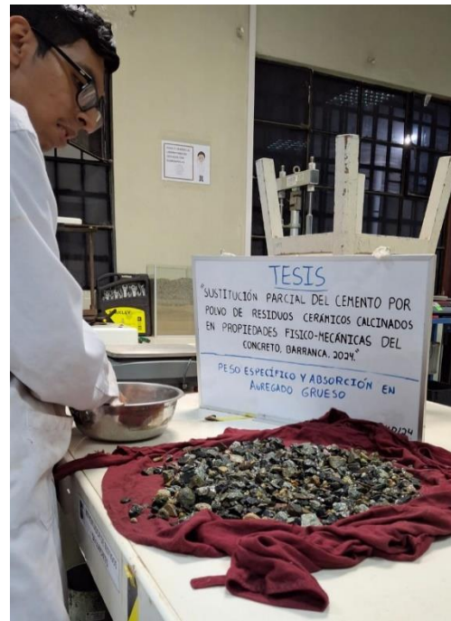
Foto 36: Muestra saturada superficialmente seca y se pesa en la balanza.
