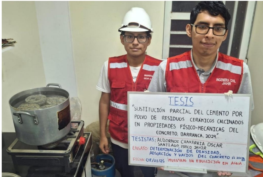
Foto 98: Muestras de concreto endurecido en ebullición en agua.
