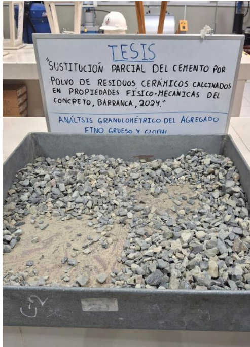
Foto 24: Ensayo para determinar el análisis granulométrico del agregado grueso.
