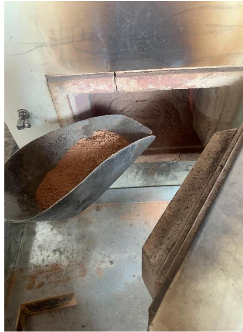
Foto 58: Incineración a 700° del polvo de residuos cerámicos.
