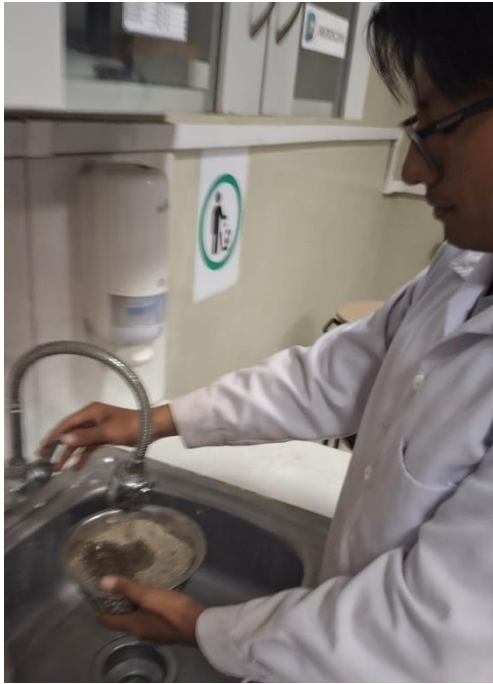
Foto 27: Lavado del agregado fino.
