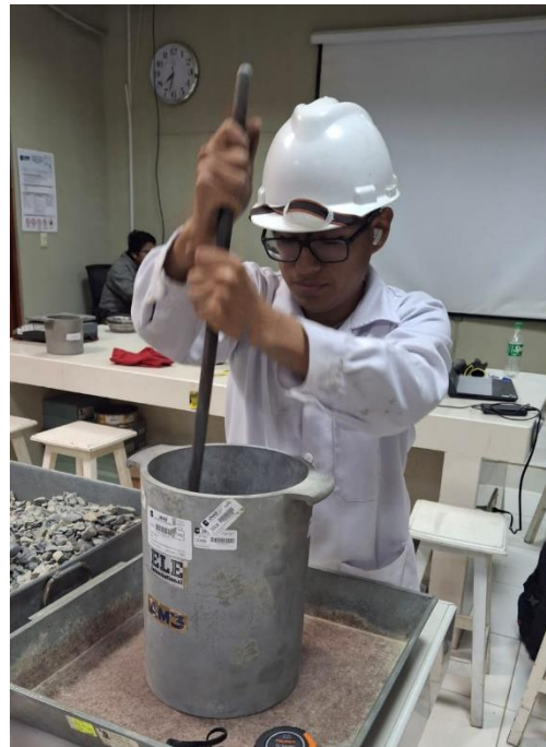
Foto 13: Ensayo para determinar el peso unitario compactado del agregado grueso.
