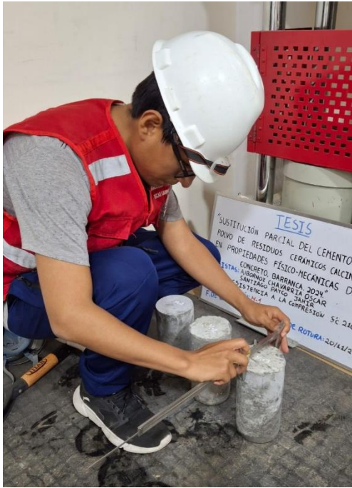
Foto 43: Obtención las dimensiones de las probetas de concreto patrón.
