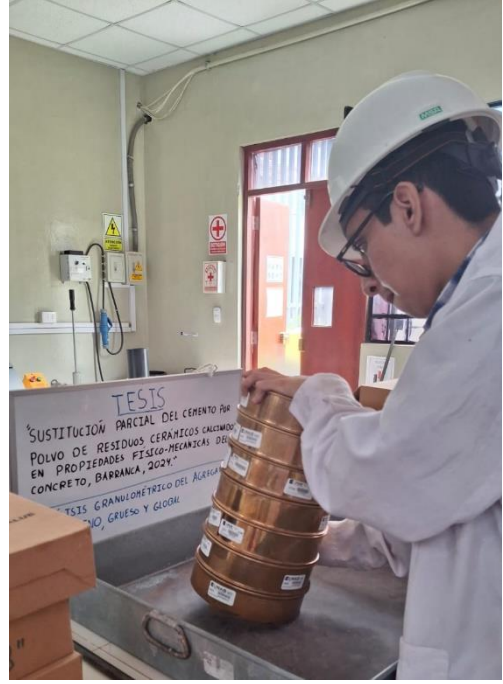
Foto 21: Ensayo para determinar el análisis granulométrico del agregado fino.
