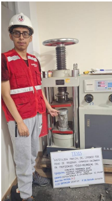
Foto 45: Ensayo de resistencia a la compresión del concreto patrón M-3.
