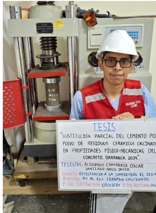
Foto 84: Ensayo de resistencia a la compresión a 14 días en la probeta M-4 de concreto con 16% de RCC.
