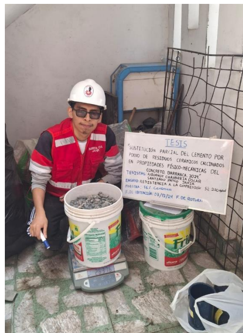
Foto 69: Pesaje del agregado grueso para la elaboración del concreto 16% RCC.
