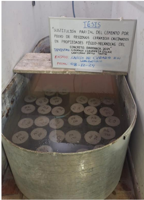
Foto 72: Curado de probetas de concreto.
