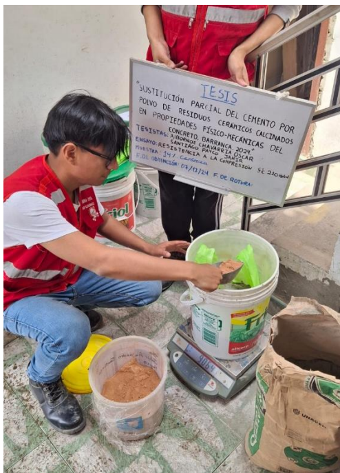
Foto 66: Pesaje de cemento y polvo de residuos cerámicos calcinados para la elaboración del concreto 14% RCC.
