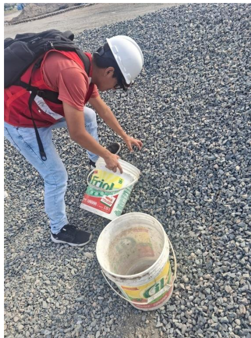
Foto 08: Extracción del agregado grueso de la cantera “Rio Seco”.
