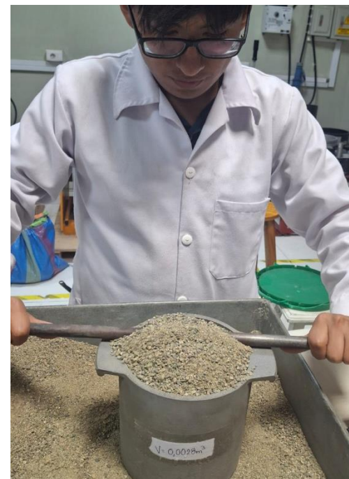
Foto 19: Ensayo para determinar el peso unitario suelto del agregado fino.
