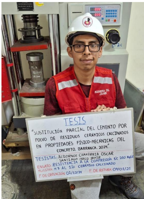
Foto 77: Ensayo de resistencia a la compresión a 28 días en la probeta M-7 de concreto con 12% de RCC.
