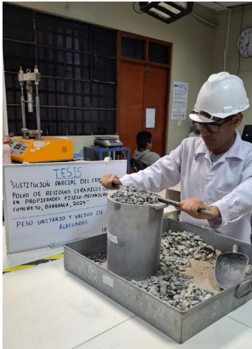
Foto 12: Ensayo para determinar el peso unitario compactado del agregado grueso.
