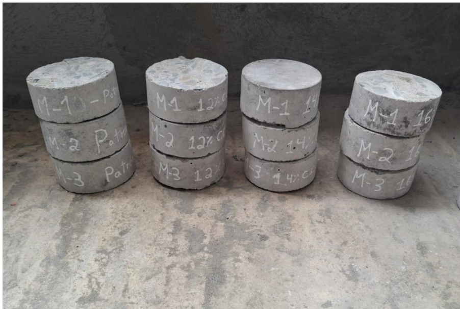
Foto 89: Se extrajo 3 muestras del concreto por cada diseño de mezcla para los ensayos de densidad, absorción y vacíos en concreto endurecido.
