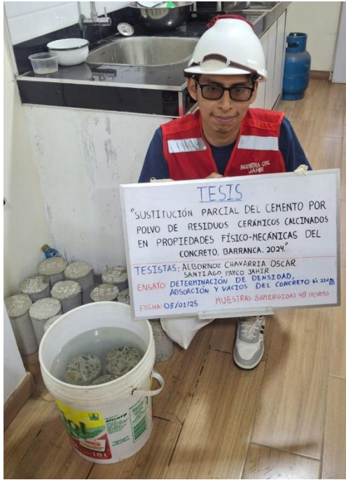
Foto 94: Muestras de concreto endurecido sumergidas durante 48 horas.
