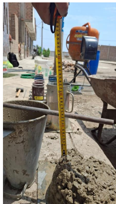
Foto 63: Medición del asentamiento del concreto con el cono de Abrams del concreto 12% RCC.
