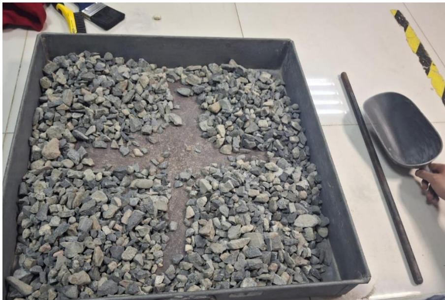
Foto 26: Ensayo para determinar el análisis granulométrico del agregado grueso.
