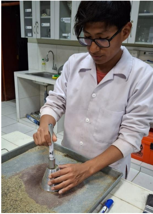
Foto 31: Ensayo para determinar si la muestra está saturada superficialmente seca.
